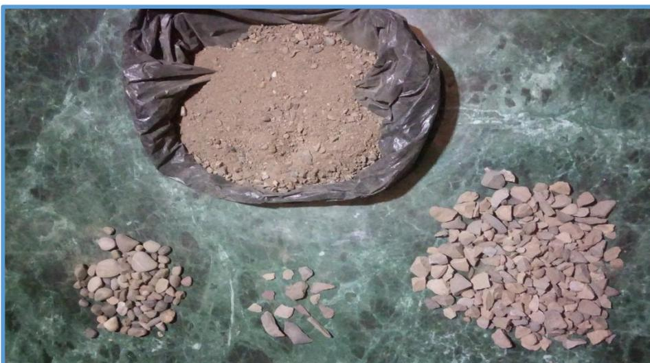
FOTO N° 05: SE OBSERVA LA MUESTRA OBTENIDA DEL LAVADO DE ASFALTO, SEPARADO POR CARACTERÍSTICAS Y DESCRITAS EN LAS FOTOS ANTERIORES.
