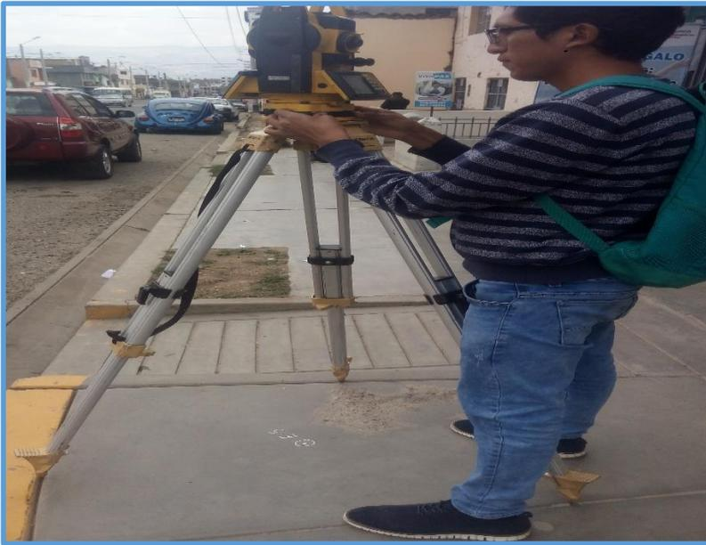
FOTO N° 04: SE OBSERVA EL ESTACIONAMIENTO DE LA ESTACIÓN TOTAL EN EL PUNTO N°06, PARA EMPEZAR A REALIZAR EL LEVANTAMIENTO RADIAL.
