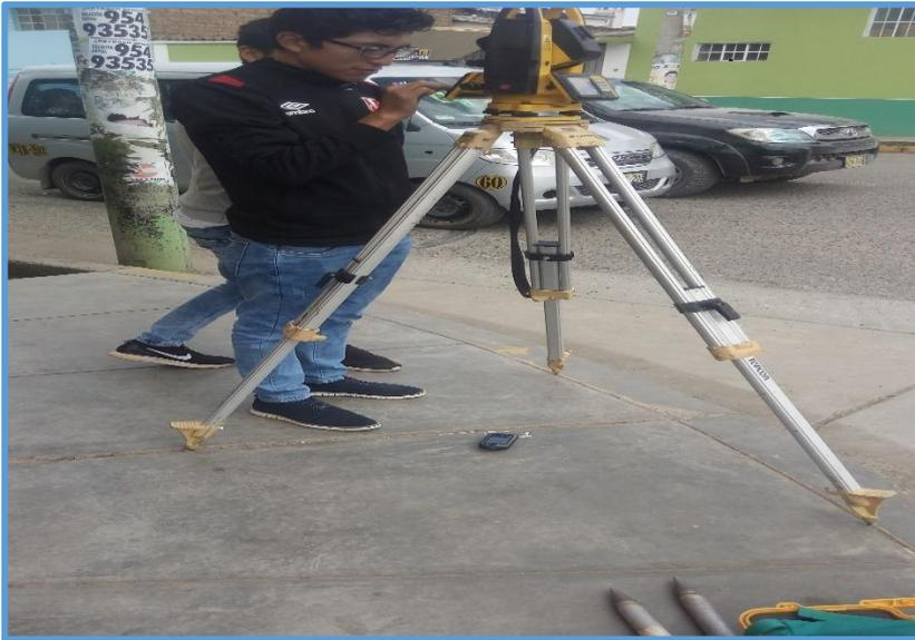
FOTO N° 01: SE OBSERVA EL ESTACIONAMIENTO DE LA ESTACIÓN TOTAL EN EL PUNTO N°01, PARA EMPEZAR A REALIZAR EL LEVANTAMIENTO RADIAL.
