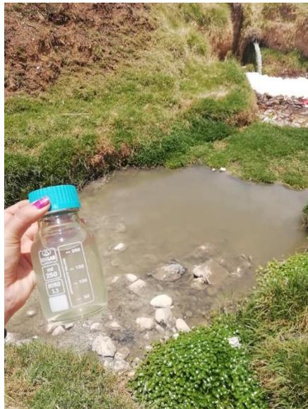
FOTO 12. Obtención de muestra del efluente de planta de tratamiento existente.
