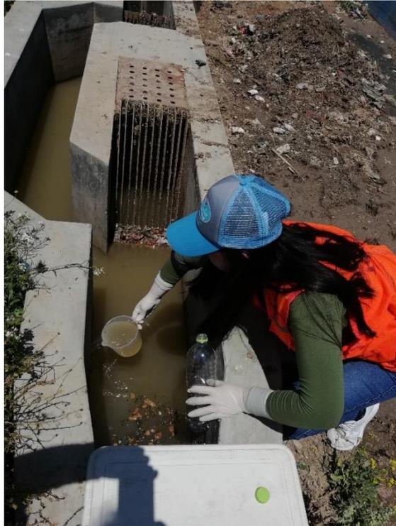
FOTO 5. Toma de muestra de agua efluente de la planta existente en el distrito de Sicaya.
