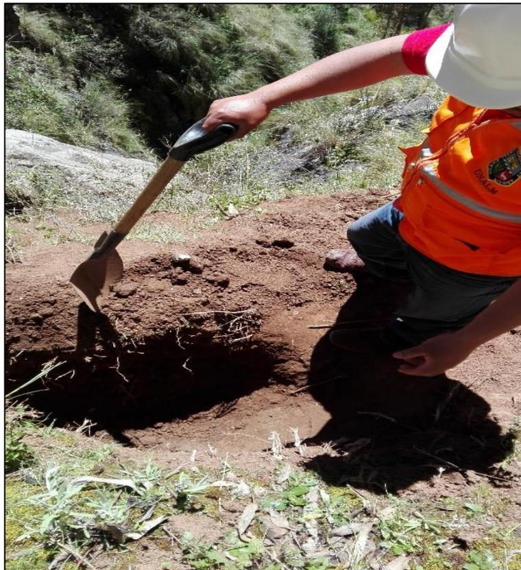
Fotografía 8. Excavación de calicatas en la zona de estudio.
