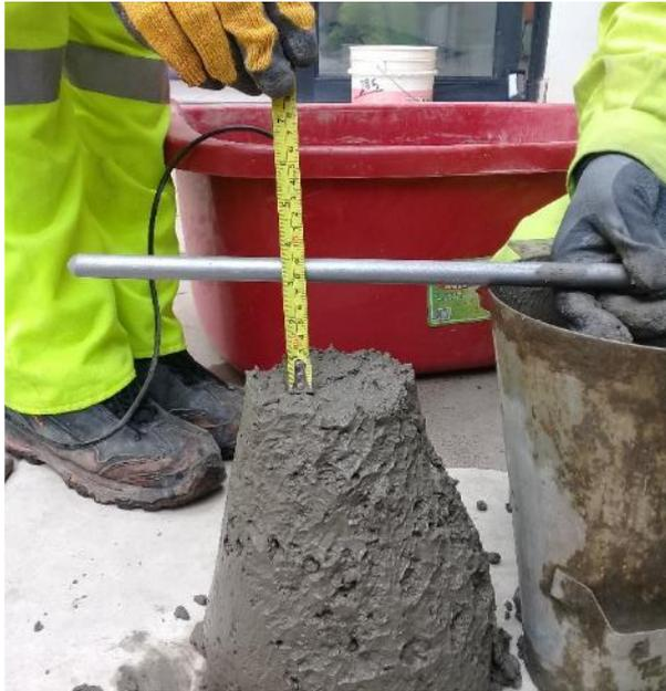
**IMAGEN 7:** ENSAYO DE REVENIMIENTO CONCRETO SIN ADITIVO. En la imagen se observa la medición del asentamiento.
