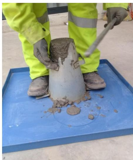
**IMAGEN 37:** ENSAYO DE REVENIMIENTO CONCRETO CON ADITIVO ENRASADO DE CONO DE ABRAMS.
