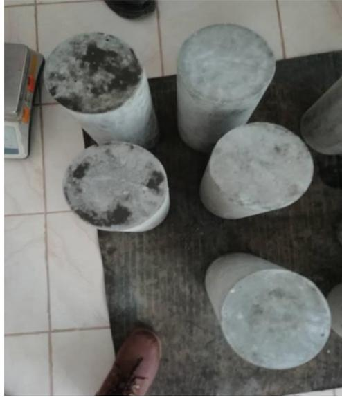
**IMAGEN 48:** MUESTRAS DE CONCRETO CON ADITIVO PREPARADAS PARA ENSAYO DE COMPRESION.
