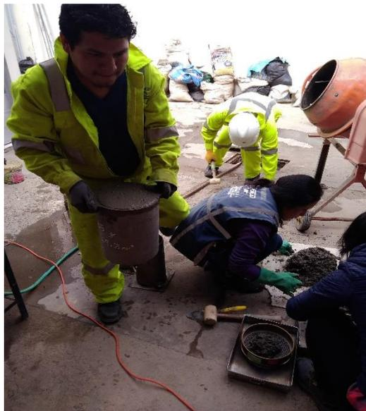
**IMAGEN 41:** CONCRETO CON ADITIVO PESO UNITARIO DE MASA.
