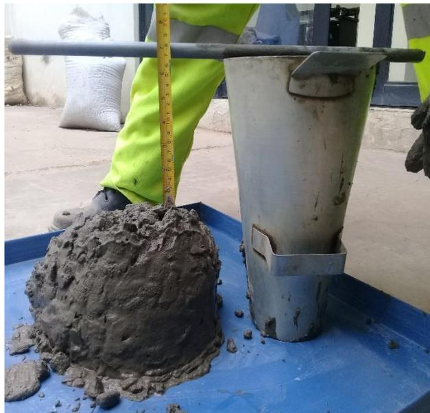
**IMAGEN 39:** MEDICION DE ASENTAMIENTO CONO DE ABRAMS SEGUNDA MUESTRA.
