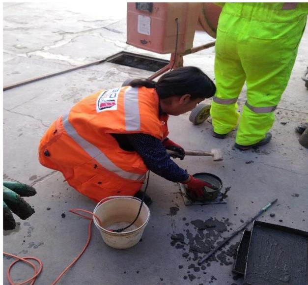
**IMAGEN 43:** PREPARACION DE MUESTRAS PARA ENSAYO DE TIEMPO DE FRAGUA.
