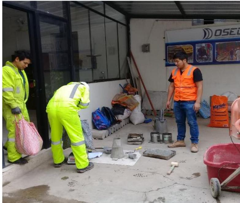
**IMAGEN 1:** INSUMOS PARA LA ELABORACION DEL CONCRETO SIN ADITIVO. En la imagen se observa el pesado de los materiales para la elaboracion del concreto sin aditivo.
