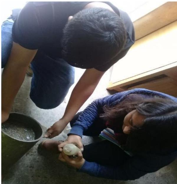
**IMAGEN 12:** EXTRACCION DE AGUA DE ENSAYO DE EXUDACION. En la imagen se observa la extraccion del agua exudada de la muestra de concreto sin aditivo.
