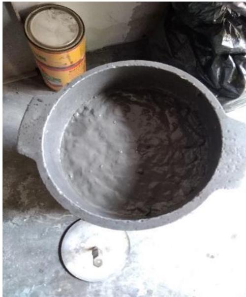
**IMAGEN 10:** MUESTRA DEL CONCRETO SIN ADITIVO PARA EXUDACION. En la imagen se observa la muestra del concreto obtenida para el ensayo de exudación.
