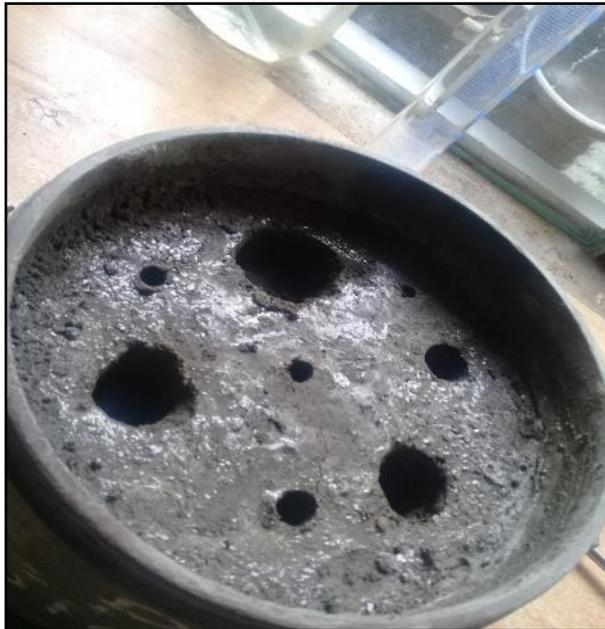
**IMAGEN 20:** MUESTRA UTILIZADA PARA ENSAYO DE TIEMPO DE FRAGUA.
