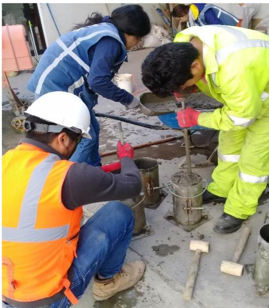
**IMAGEN 32:** PREPARACION DE PROBETAS CON ADITIVO. En la imagen se observa el llenado de los moldes.
