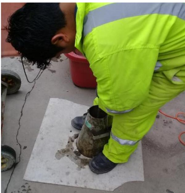
**IMAGEN 5:** PREPARACION DE ENSAYO DE REVENIMIENTO. En la imagen se observa el llenado del cono de abrams..
