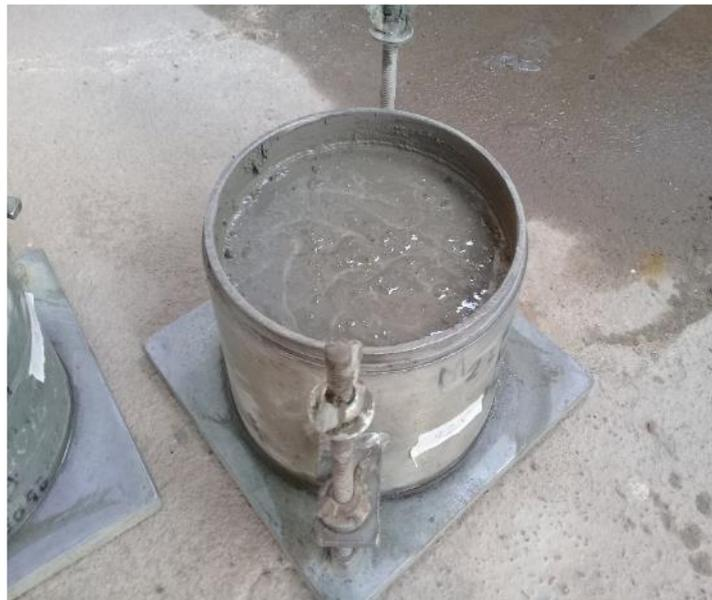
**IMAGEN 18:** MUESTRAS DE CONCRETO SIN ADITIVO PARA ENSAYO DE TIEMPO DE FRAGUA. En la imagen se observa las muestras que seran utilizados para el ensayo de tiempo de fragua
