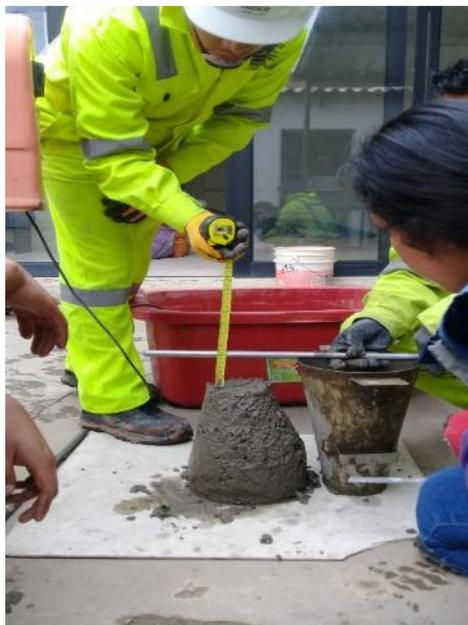
**IMAGEN 8:** ENSAYO DE REVENIMIENTO CONCRETO SIN ADITIVO. En la imagen se observa la medición del asentamiento.
