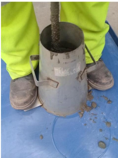
**IMAGEN 36:** ENSAYO DE REVENIMIENTO CONCRETO CON ADITIVO LLENADO DE CONO DE ABRAMS.
