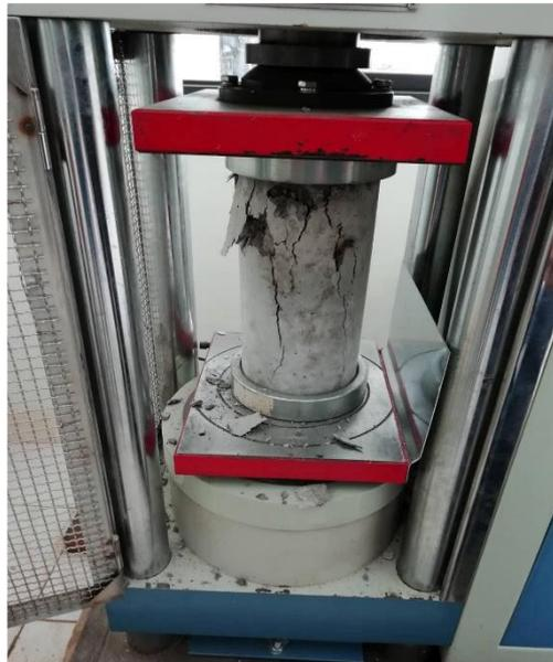
**IMAGEN 51:** PROBETAS DE CONCRETO CON ADITIVO DURANTE DE ENSAYO DE COMPRESION.
