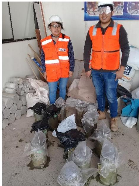
**IMAGEN 35:** PROBETAS CON ADITIVO CULMINADAS.
