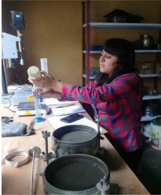
**IMAGEN 11:** MEDICION DE AGUA DE ENSAYO DE EXUDACION. En la imagen se observa la medicion del agua exudada de la muestra de concreto sin aditivo.
