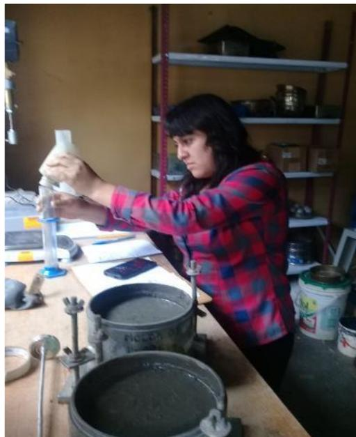
**IMAGEN 16:** MEDICION DEL VOLMUEN DE AGUA EXUDADA. En la imagen se observa la medicion de la cantidad de agua exudada del concreto sin aditivo.
