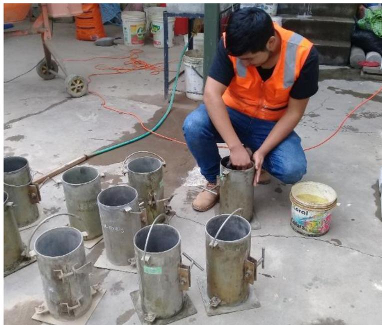
**IMAGEN 2:** PREPARACION DE PROBETAS PARA CONCRETO SIN ADITIVO. En la imagen se observa el engrasado de los moldes para el concreto sin aditivo.
