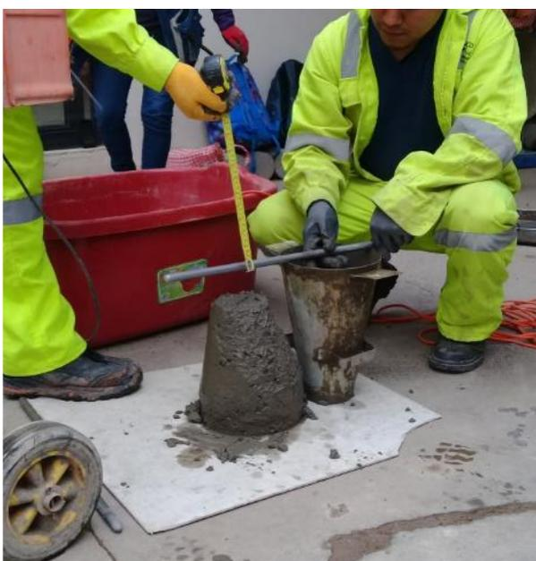
**IMAGEN 6:** ENSAYO DE REVENIMIENTO CONCRETO SIN ADITIVO. En la imagen como se desarrolla el ensayo de revenimiento.
