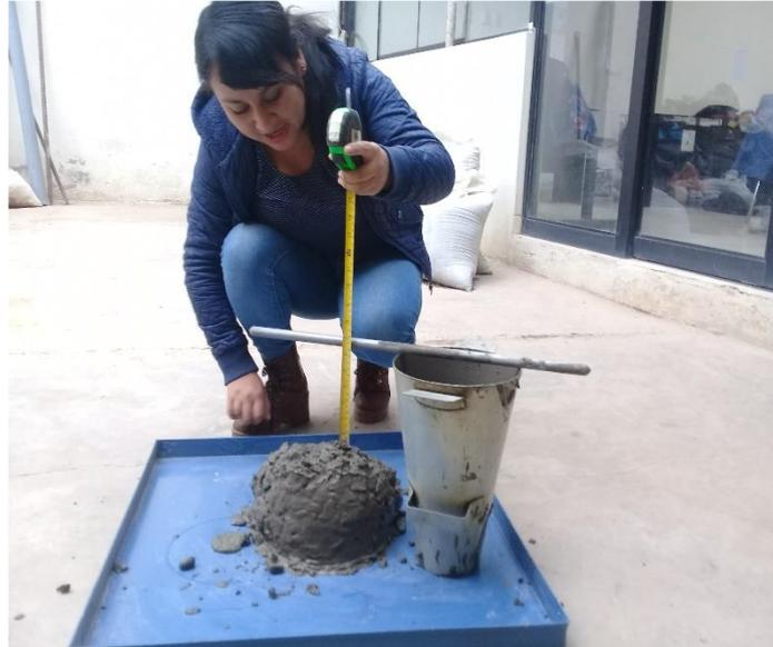
**IMAGEN 38:** MEDICION DE ASENTAMIENTO CONO DE ABRAMS PRIMERA MUESTRA.
