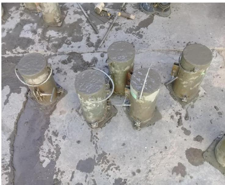
**IMAGEN 33:** PROBETAS CON ADITIVO ELABORADAS.
