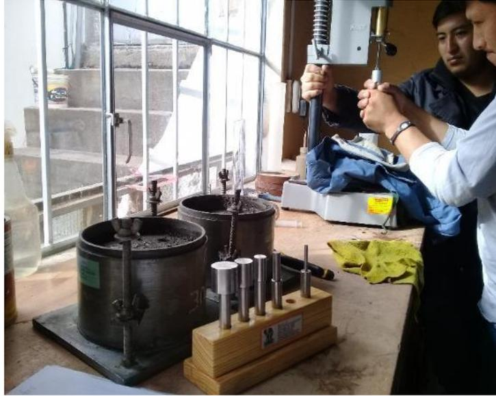
**IMAGEN 19:** CAMBIO DE AGUJA DE PENETRACION PARA ENSAYO DE TIEMPO DE FRAGUA CONCRETO SIN ADITIVO.
