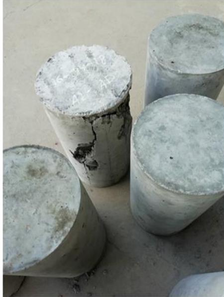
**IMAGEN 50:** ROTURA DE MUESTRAS CON ADITIVO ENSAYO DE COMPRESION.
