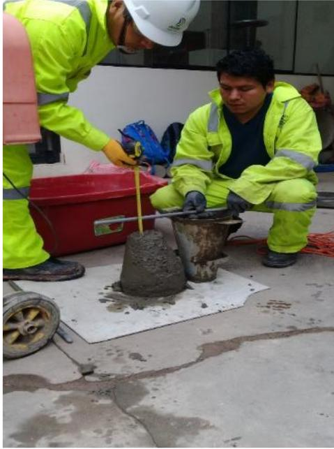
**IMAGEN 9:** ENSAYO DE REVENIMIENTO CONCRETO SIN ADITIVO. En la imagen se observa la medición del asentamiento.
