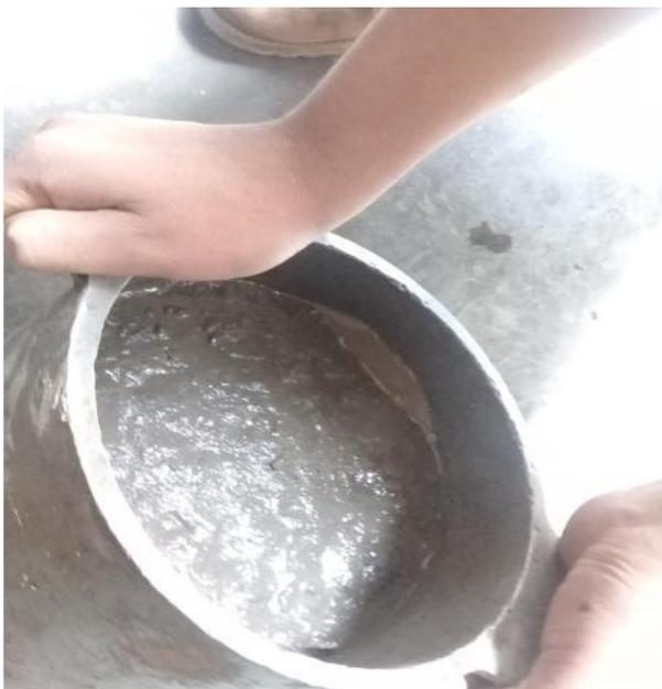
**IMAGEN 13:** INCLINACION DE MUESTRA DE CONCRETO SIN ADITIVO PARA RECOLECCION DE AGUA DE EXUDACION. En la imagen se observa la inclinacion de .
