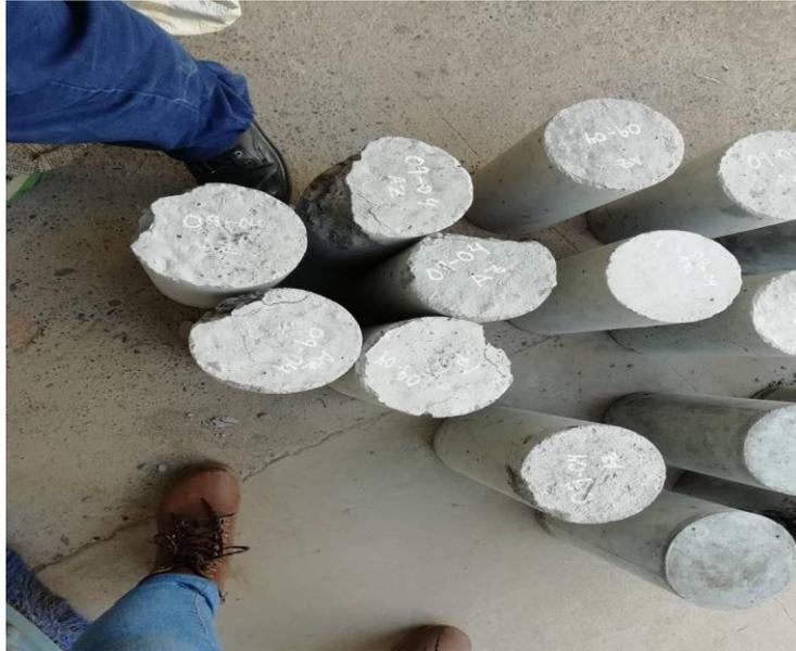
**IMAGEN 27:** PROBETAS DE CONCRETO SIN ADITIVO AL FINALIZAR ENSAYO DE COMPRESION SIMPLE.
