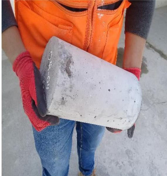
**IMAGEN 23:** PROBETA CONCRETO SIN ADITIVO USADA ENSAYO DE COMPRESION SIMPLE.
