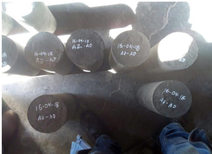
**IMAGEN 49:** PROBETAS CON ADITIVO, ANTES DE ENSAYO DE COMPRESION.
