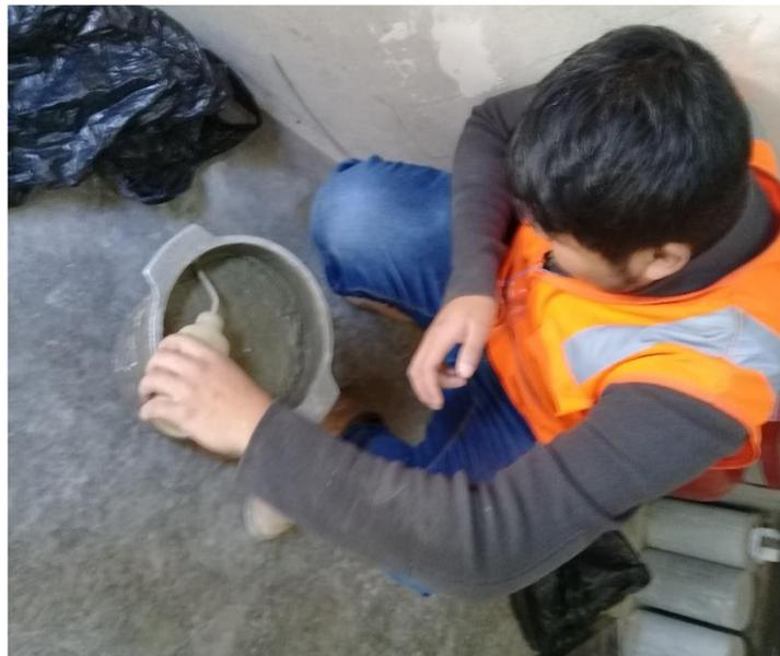
**IMAGEN 45:** EXTRACCION DE AGUA DE MUESTRA DE CONCRETO CON ADITIVO ENSAYO DE EXUDACION.
