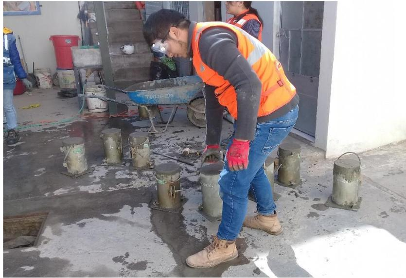
**IMAGEN 34:** TRASLADO DE PROBETAS CON ADITIVO ELABORADAS.
