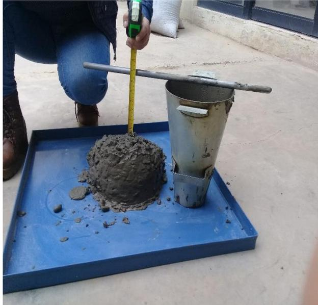
**IMAGEN 40:** MEDICION DE ASENTAMIENTO CONO DE ABRAMS TERCERA MUESTRA.
