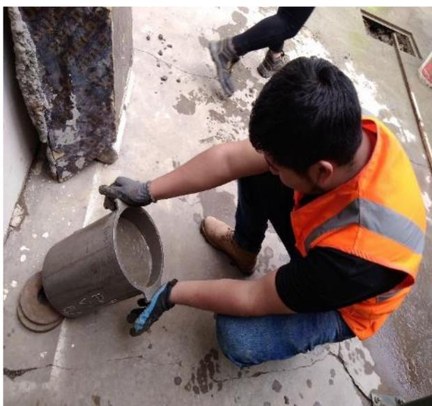
**IMAGEN 14:** ENSAYO DE EXUDACION CONCRETO SIN ADITIVO. En la imagen se observa el molde con el agua de exudacion.
