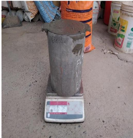
**IMAGEN 42:** PESADO DE CONCRETO CON ADITIVO PESO UNITARIO DE MASA
