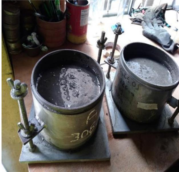
**IMAGEN 17:** MUESTRAS DE CONCRETO SIN ADITIVO PARA ENSAYO DE TIEMPO DE FRAGUA. En la imagen se observa las muestras que seran utilizados para el ensayo de tiempo de fragua.
