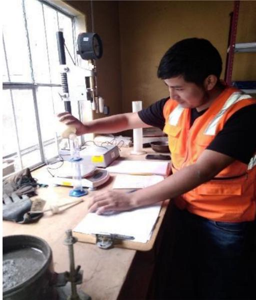
**IMAGEN 15:** MEDICION DEL VOLMUEN DE AGUA EXUDADA. En la imagen se observa la medicion de la cantidad de agua exudada del concreto sin aditivo.
