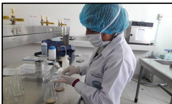
Mezcla del agua destilada y medio de cultivo en el matraz
