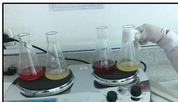
Disolución de los medios de cultivo mediante calentamiento
