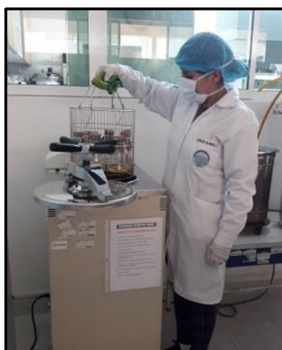
Esterilización de los medios de cultivo en autoclave
