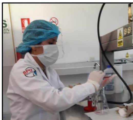
Servido del medio de cultivo en placas petri estériles, bajo asepsia
