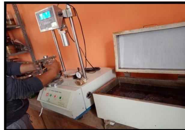
Ensayo de estabilidad y flujo a la briqueta extraída.
