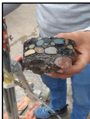
Con este resultado se pudo determinar que mantiene su elasticidad la carpeta asfáltica se mantiene en los parámetros y presenta una estabilidad máxima de 1000.00 kg (resistencia) en la muestra N°02 en la progresiva 0+600 km.
