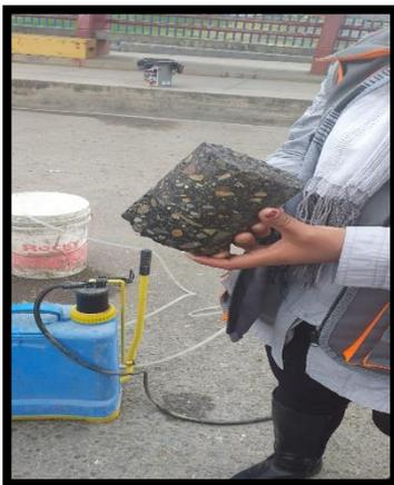
Briqueta extraída para el análisis de sus propiedades físico mecánicas.
