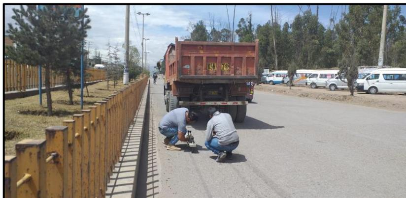
Este ensayo consiste en colocar una palanca de aluminio con sensores deflectivos para ver cómo es la deformación del pavimento a distancias 0.00, 0.25, 0.50, 0.75, 1.00, 2.50 en m para determinar las deformaciones que se produce el pavimento.
