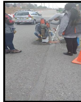
Extracción de diamantina en la progresiva 0+300 margen derecha.
