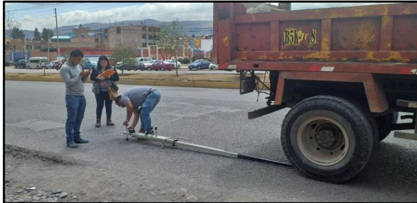
En las progresivas 0+575, 0+475, 0+250, 0+075 también presenta una deformación más remarcada determinando que en estos puntos la carpeta asfáltica no es suficiente para poder determinar los esfuerzos a los que es sometido el pavimento flexible.
