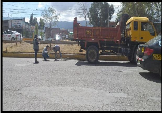
Ensayo de la viga benkelman.
