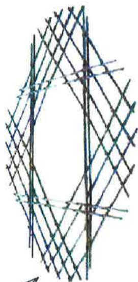
ESTRUCTURA DE FIERRO DE TECHO DE BUZÓN
