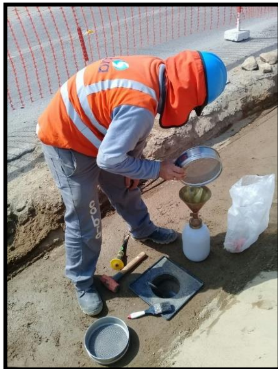
Figura 10: Control de densidad de campo
