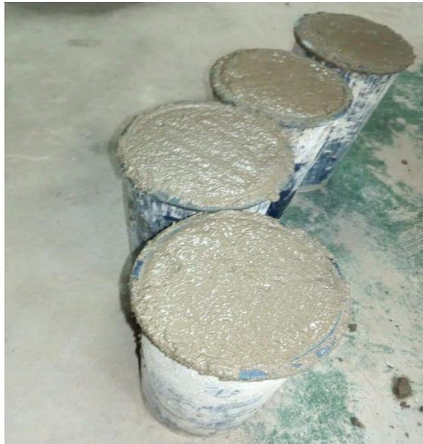
**IMAGEN 6:** PROBETAS DE CONCRETO. En la imagen se observa las probetas de concreto para el curado.
