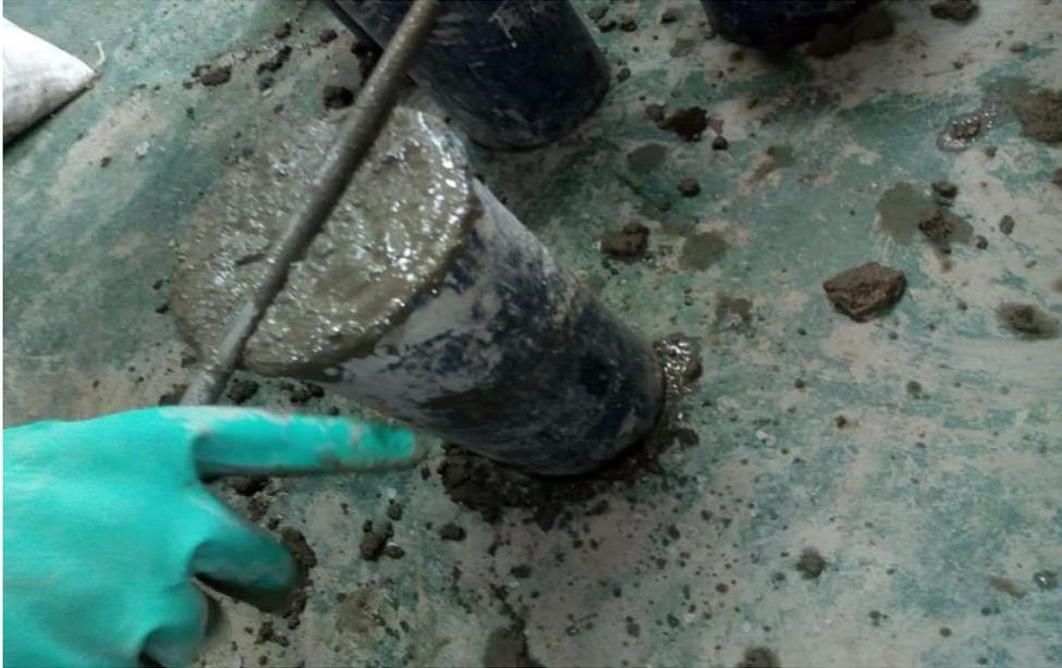
**IMAGEN 5:** ENRASE DE PROBETAS. En la imagen se observa la elaboración de probetas de concreto.
