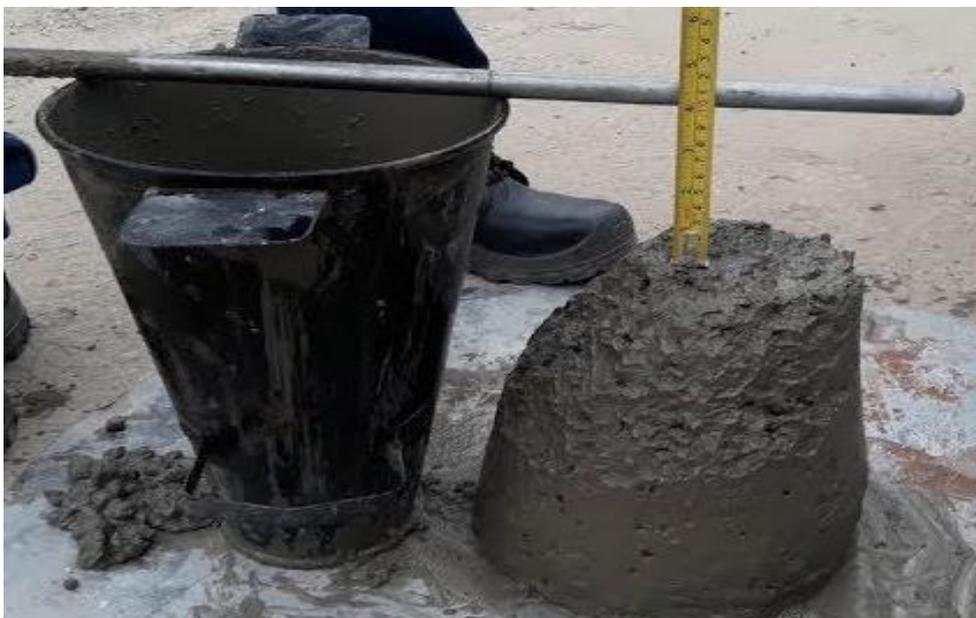
**IMAGEN 4:** ENSAYO DE TRABAJABILIDAD DEL CONCRETO. En la imagen se observa la elaboración del ensayo y determinación del Slump.
