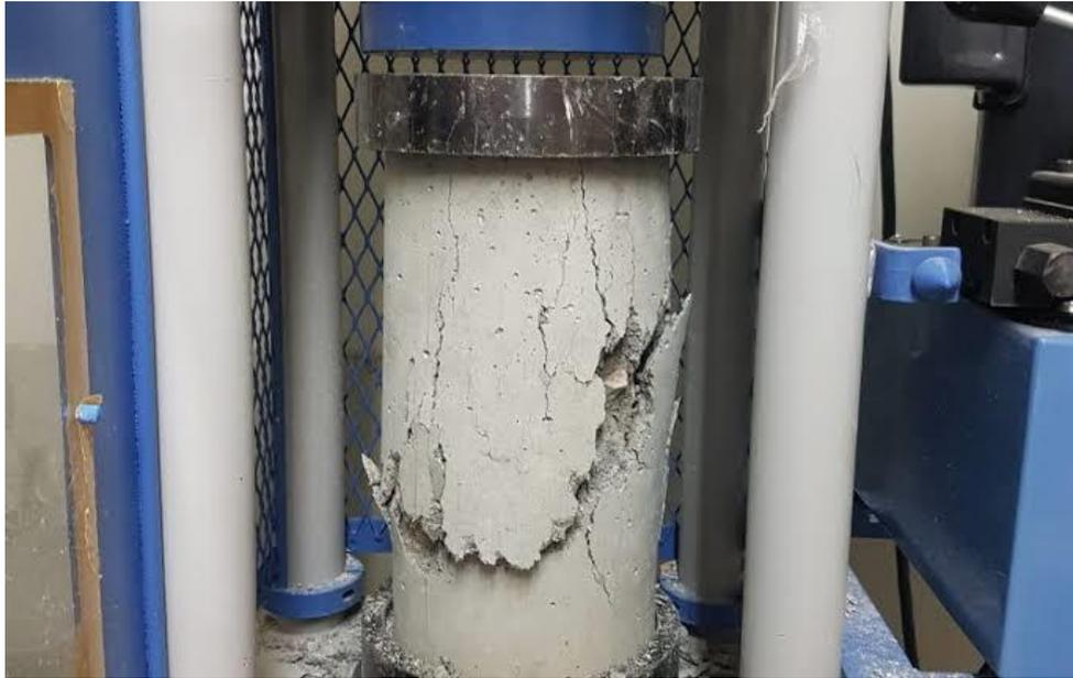
**IMAGEN 7:** ENSAYO DE RESISTENCIA A LA COMPRESIÓN DEL CONCRETO. En la imagen se observa la rotura de probetas.
