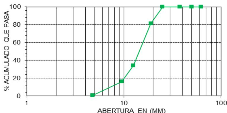
**Figura 20.** Curva granulométrica (Agregado grueso).
