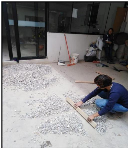
Figura 16. Cuarteo del agregado grueso.
