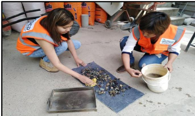
*Figura 17.* Secando la superficie del agregado grueso.
