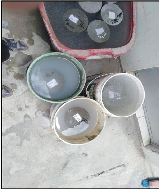
*Figura 38. Curado de probetas
