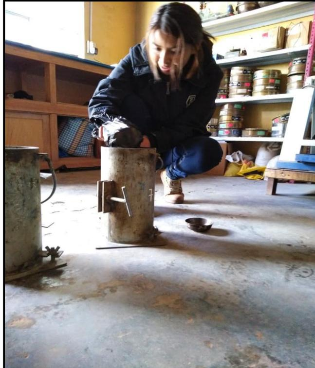
*Figura 25. Preparando los moldes cilíndricos*
