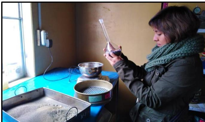
Figura 13. Eliminación de aire en el matraz.
