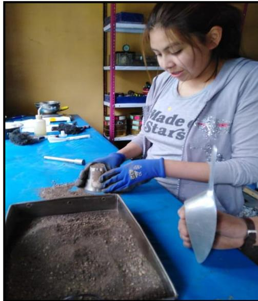
*Figura 12.* Condición superficial de la muestra seca. Foto referencial
