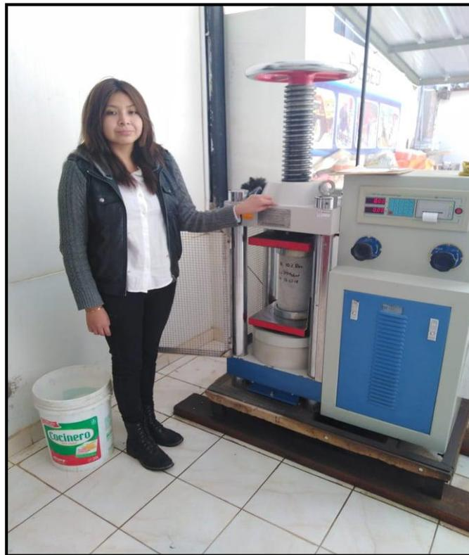
*Figura 37 Roturado de probetas a los 7 días*
