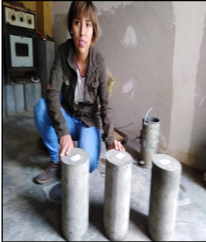
*Figura 36 Probetas desencofradas*
