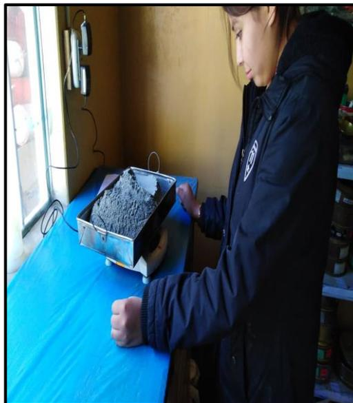
*Figura 5. Peso de muestra húmeda.*
