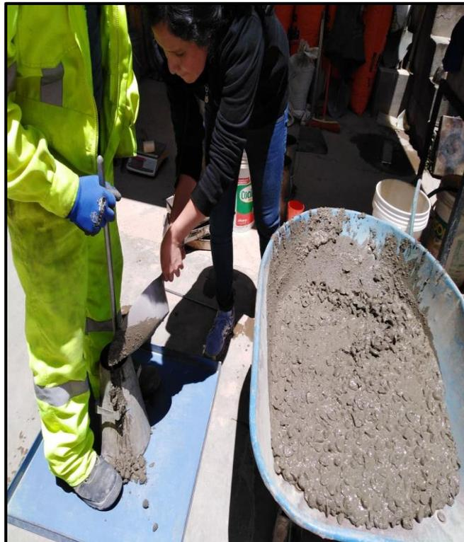
*Figura 29 Echando la mezcla al cono de Abrams
