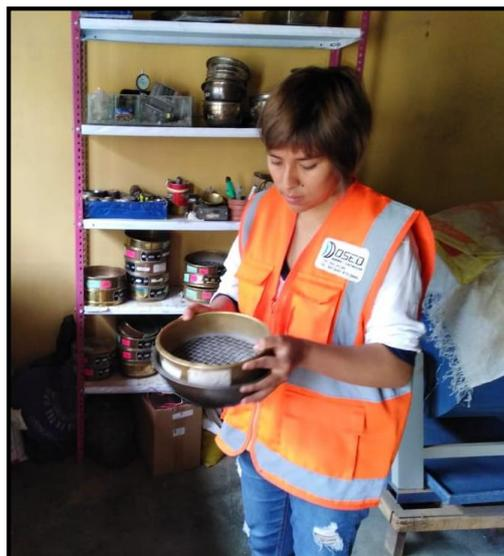
Figura 11. Tamizado del agregado fino.
