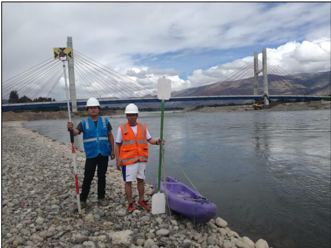
Imagen 4.- Equipo para el levantamiento de las secciones transversales - batimetría.
