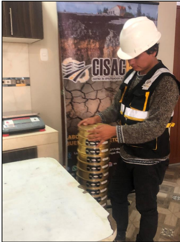
Imagen 31.- Ensayo de análisis granulométrico de las muestras extraídas del Puente comuneros en el laboratorio de Cisacperu.
