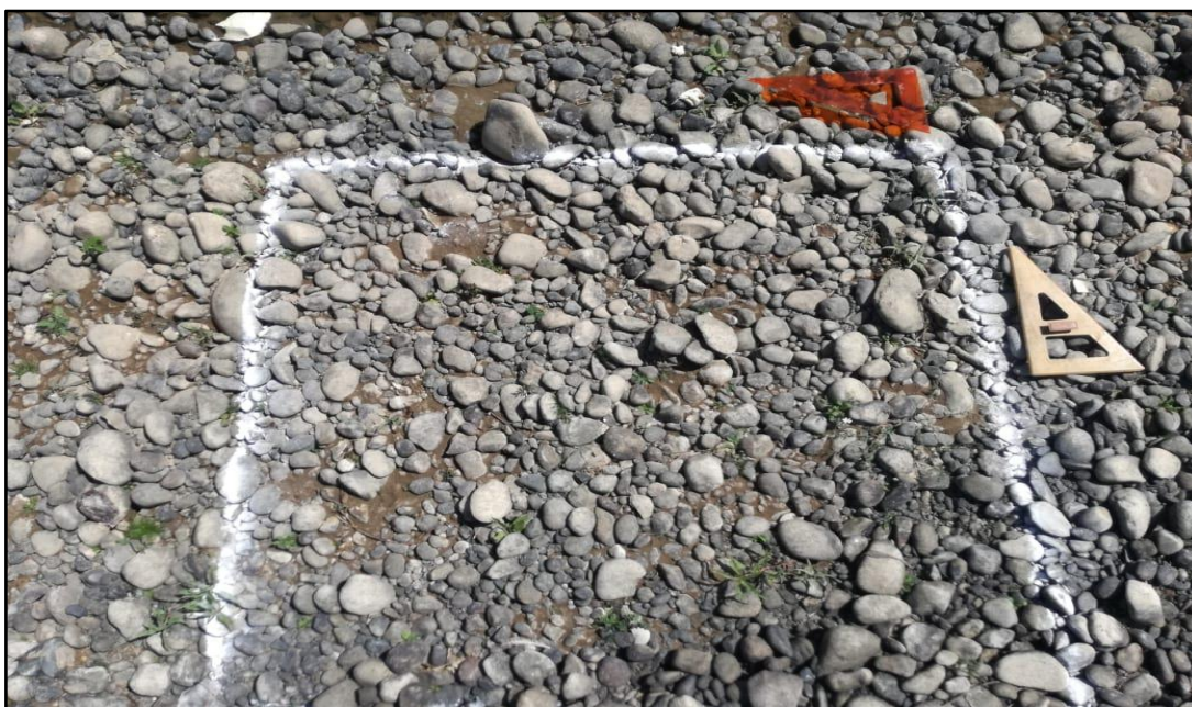
Imagen 26.- Representación de una fotometría con reglas estandarizadas para la medida general de las partículas.
