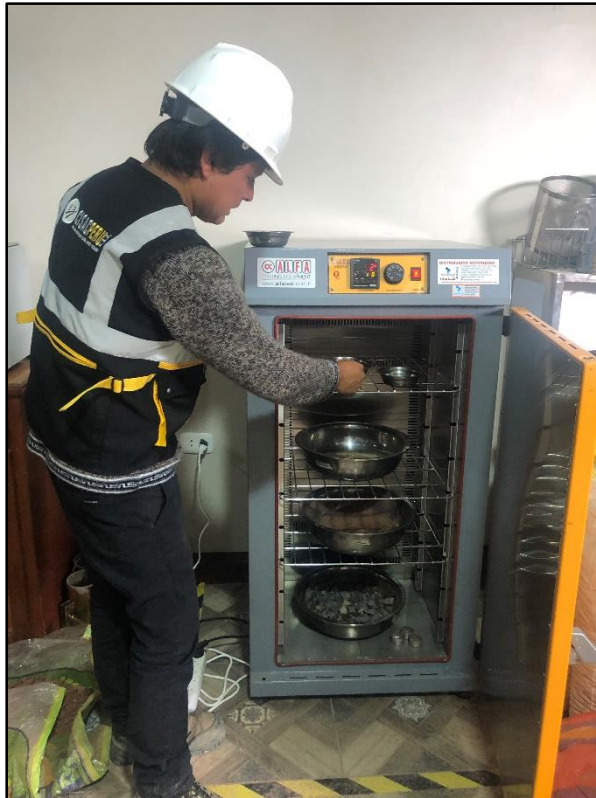
Imagen 33.- Colocación de la muestra insitú al horno para el calcula del contenido de humedad en el laboratorio de Cisacperu.
