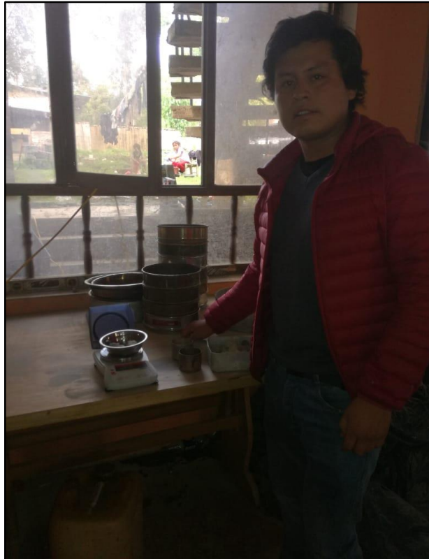
Imagen 30.- Ensayo del Peso específico del material extraído del puente comuneros en el laboratorio de Geovicon.
