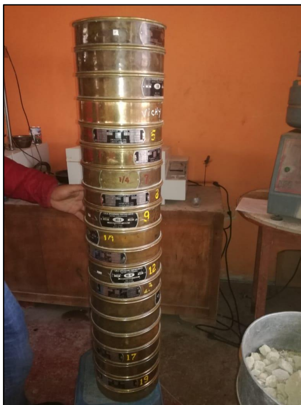
Imagen 27.- Ensayo de análisis granulométrico de las muestras extraídas del Puente comuneros en el laboratorio de Geovicon.
