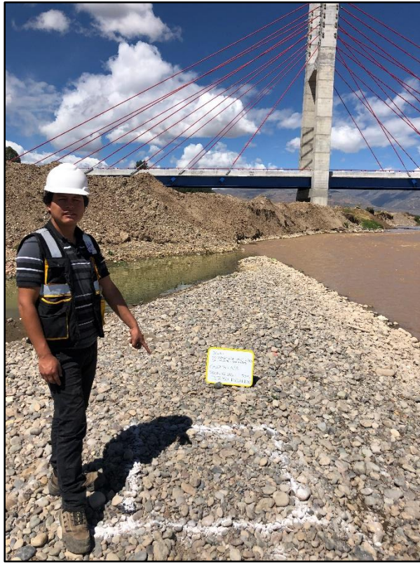
Imagen 13.- Extracción de material de la calicata N°2.
