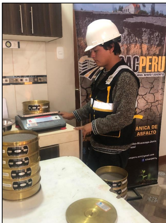
Ilustración 39.- Pesado de la muestra luego del tamizaje en el laboratorio Cisacperu.
