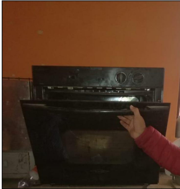
Ilustración 32.- Secado del material en el horno a una temperatura T^{\circ}=110^{\circ} en el laboratorio de Geovicon.
