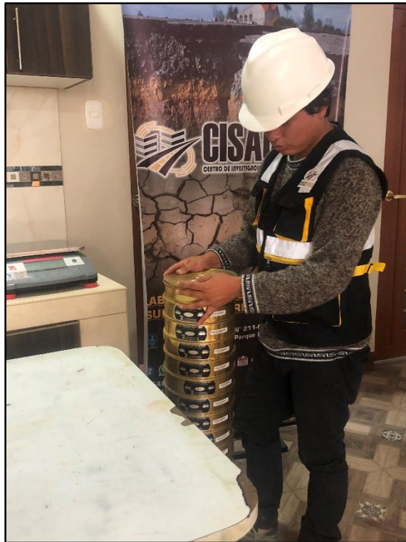
Ilustración 38.- Proceso de tamizaje de la muestra extraída en el laboratorio Cisacperu.
