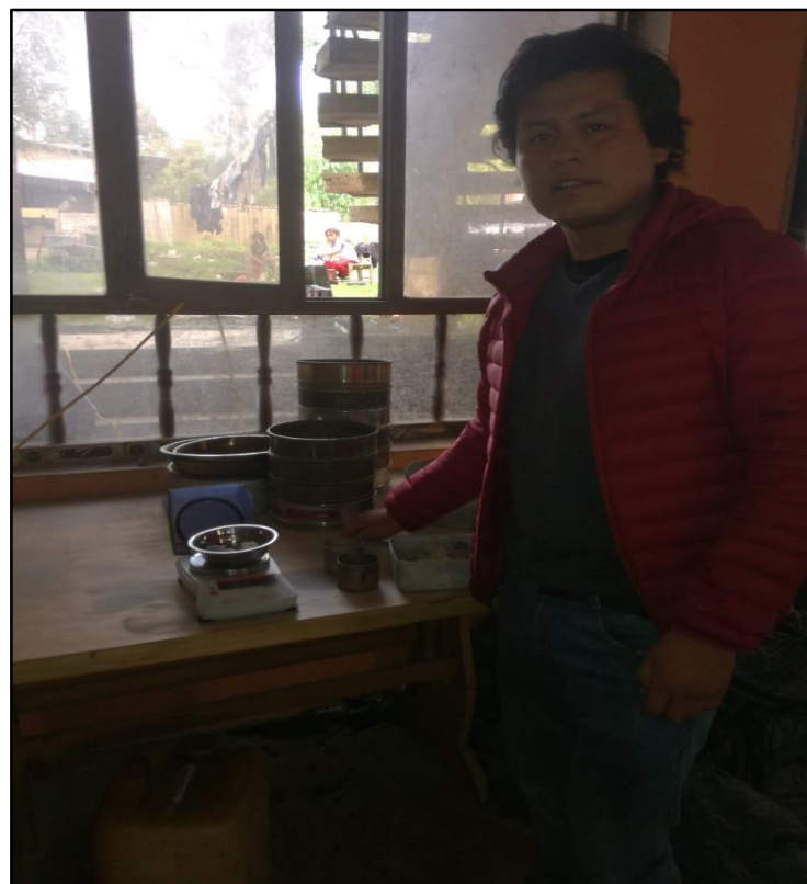
Ilustración 33.- Ensayo de Peso específico del material granular que se extrajo y se evaluó en el laboratorio de Geovicon.
