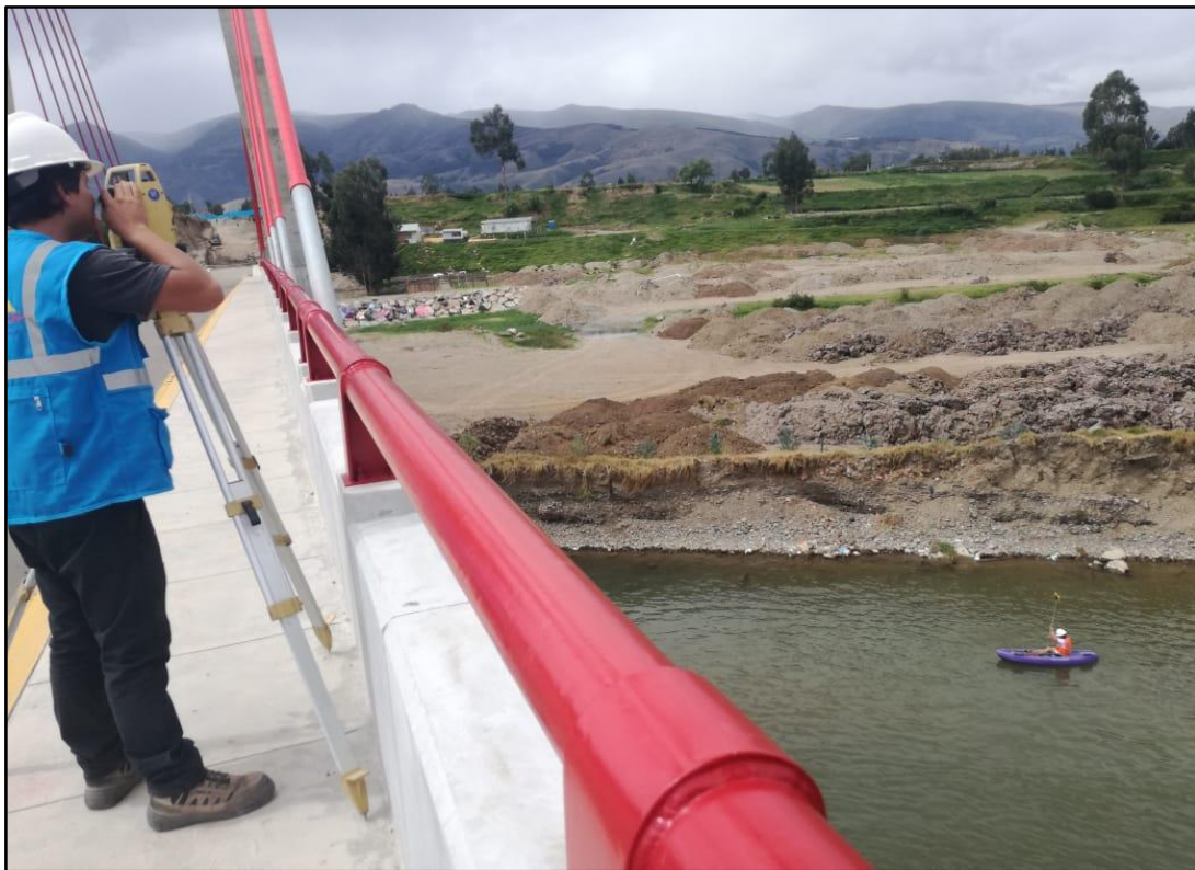
Imagen 6.- Toma Secciones Transversales Aguas Arribas.
