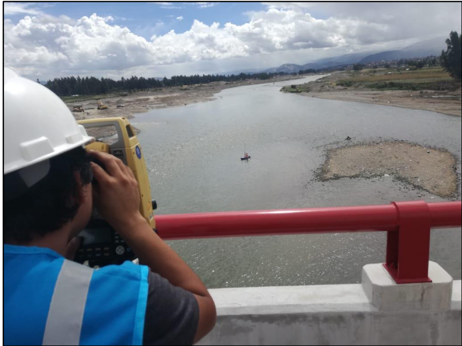
Ilustración 20.- Toma de puntos de la secciones transversales aguas arriba.
