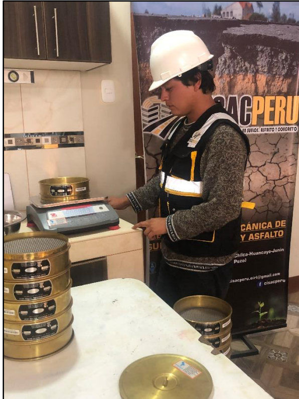
Imagen 32.- Ensayo del cálculo del peso específico de la muestra extraída del puente comuneros en el laboratorio de Cisacperu.
