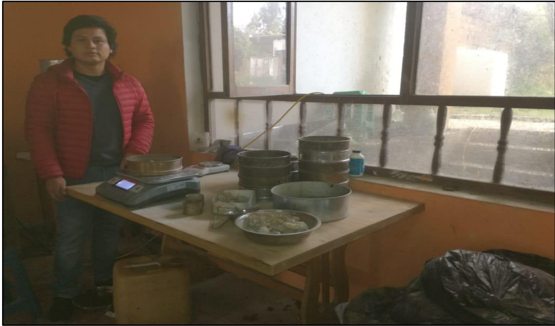
Imagen 28.- Ensayo del cálculo del peso específico de la muestra extraída del puente comuneros en el laboratorio de Geovicon.
