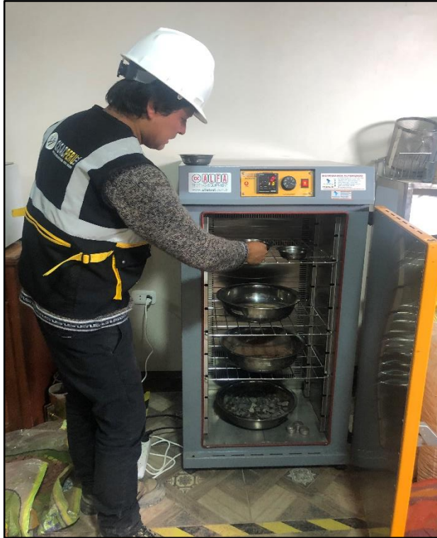
Ilustración 34.- Secado del material a una T^{\circ}=110^{\circ}\text{C} en el laboratorio de Cisacperu.
