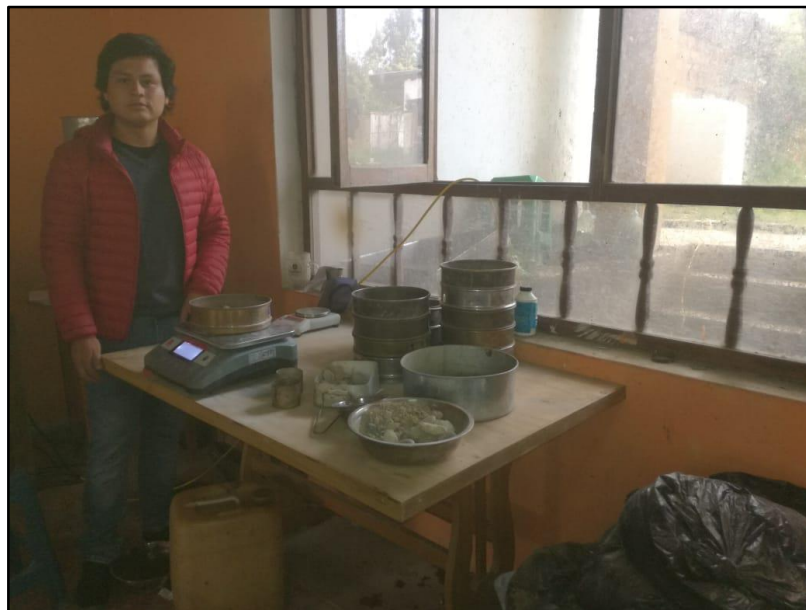
Ilustración 37.- Pesado de la muestra luego del tamizaje en el laboratorio Geovicon.
