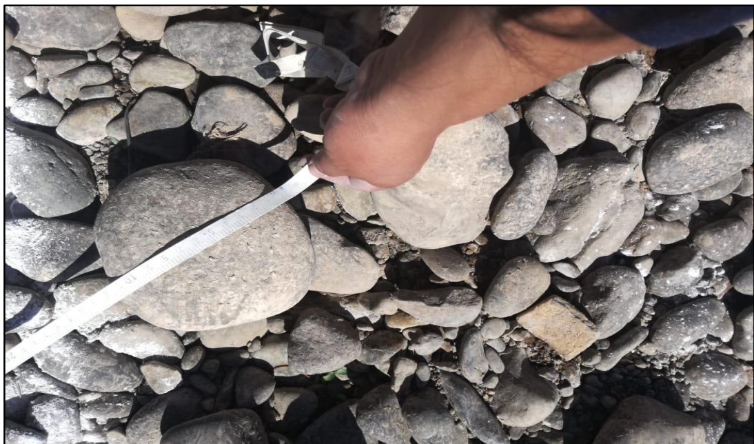
Imagen 25.- Medidas General de las partículas en los lechos del rio tanto aguas arriba como aguas abajo.
