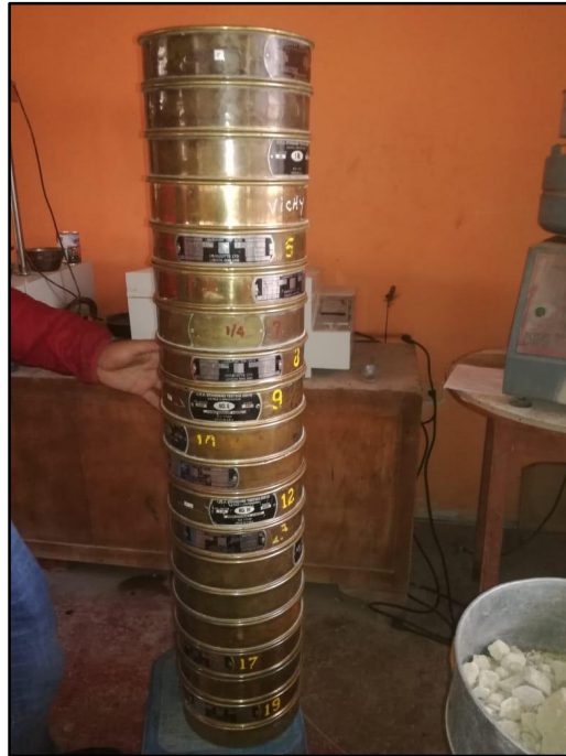
Ilustración 36.- Proceso de tamizaje de la muestra extraída en el laboratorio Geovicon.
