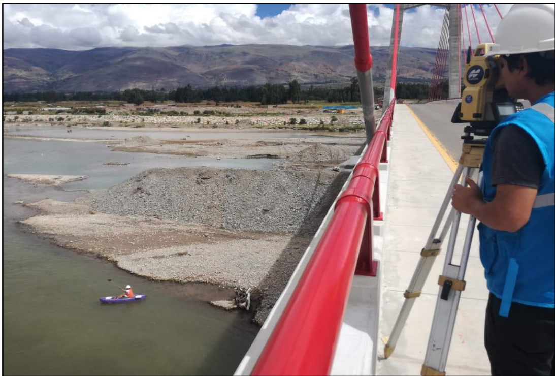
Imagen 8.- Toma Secciones Transversales Aguas Abajo.
