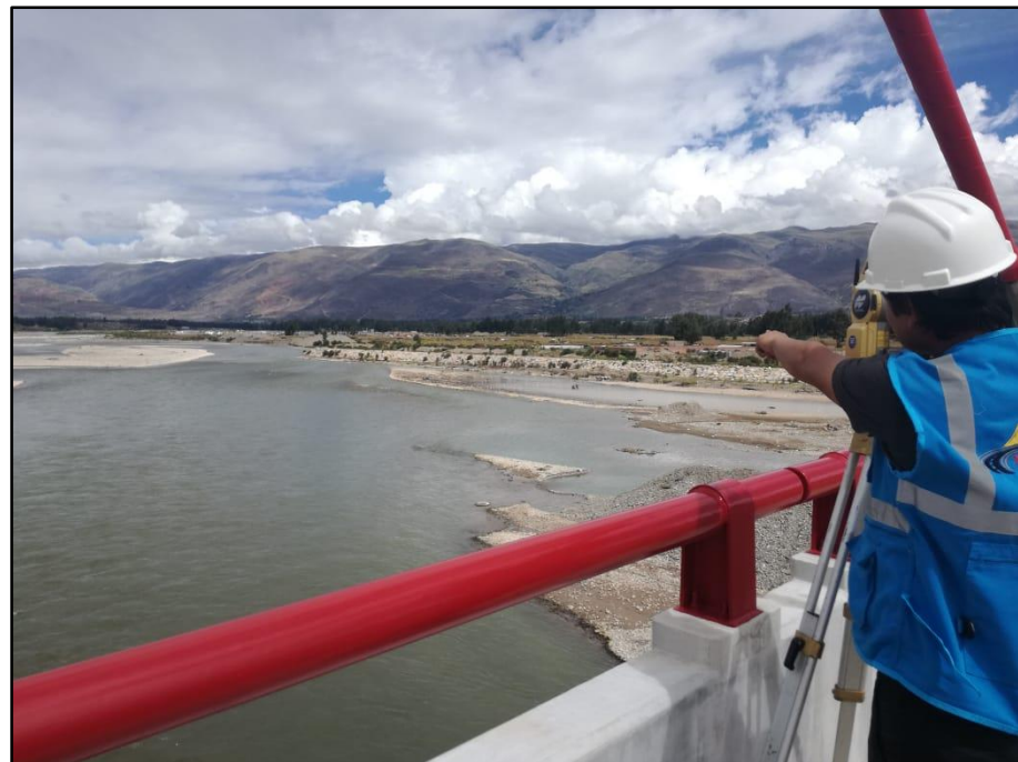
Ilustración 17.- Levantamiento topográfico - batimetría de la secciones transversales – aguas arriba.
