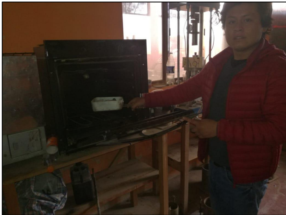
Ilustración 31.- Secado del material a una T^{\circ}=110^{\circ}\text{C} en el laboratorio de Geovicon.
