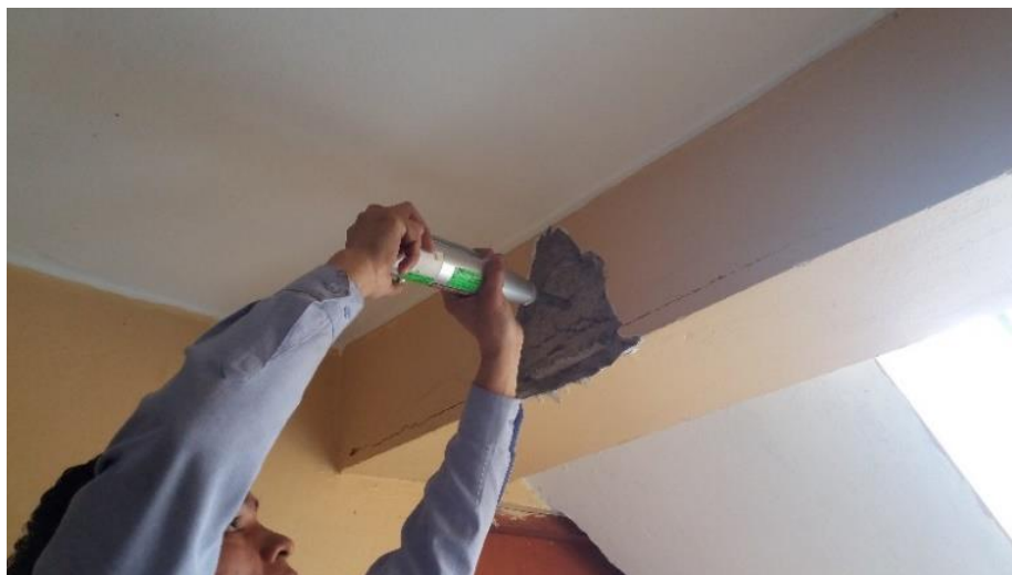
Figura 46: Evaluación de Columna con el Equipo Esclerómetro
