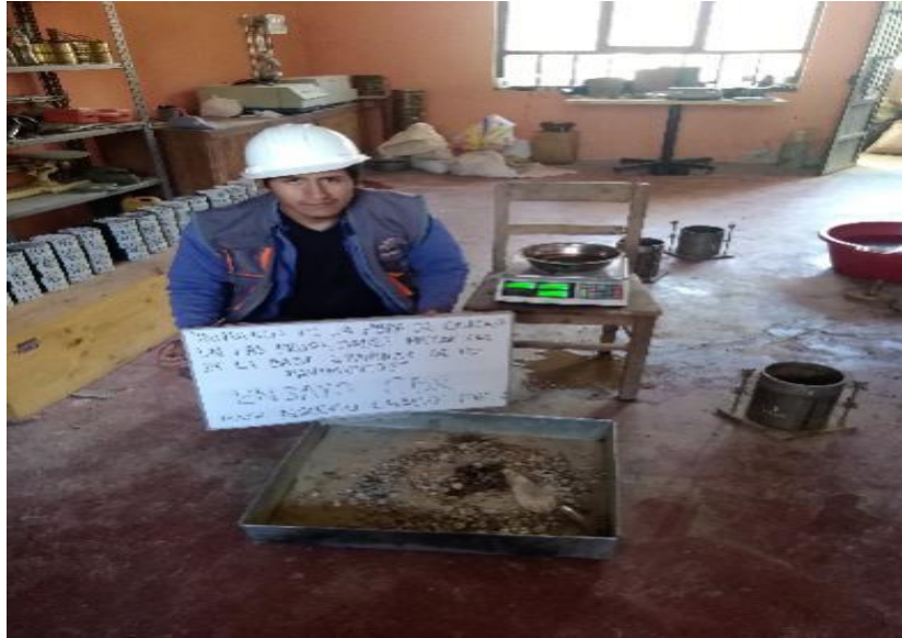
Figura 12. Preparación de muestra para CBR.
