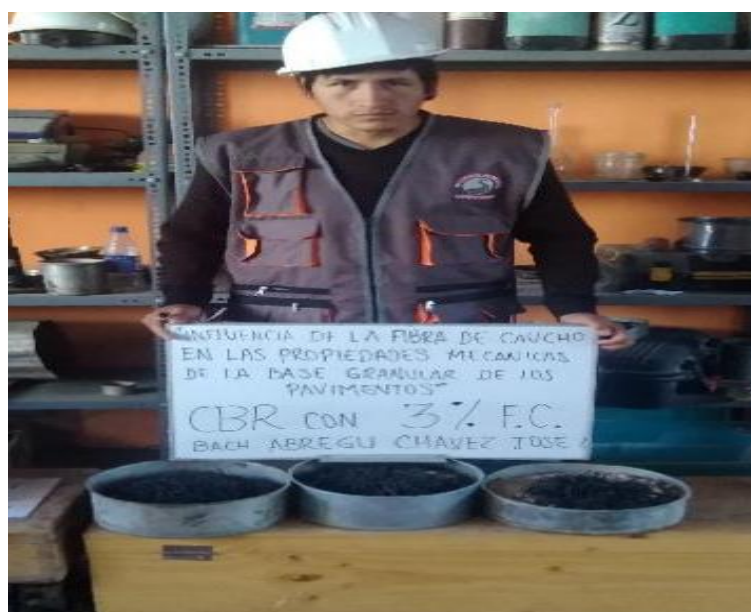
Figura 26. Muestras de material para CBR con 3% de caucho Fuente: propia
