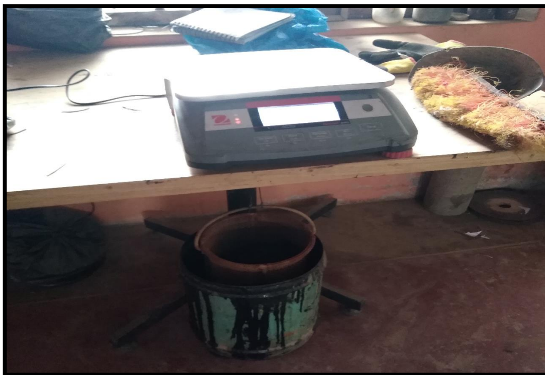
Fotografía 12. Peso de la fibra de caucho en agua
