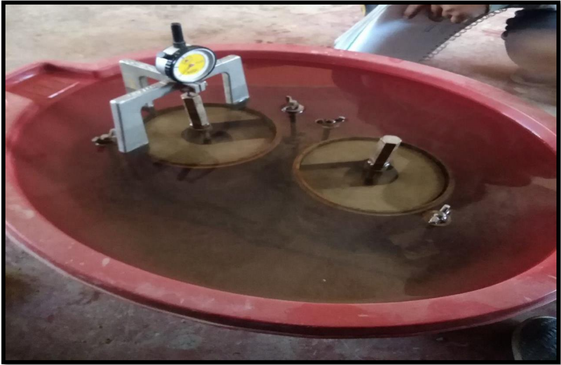
Fotografía 7. Muestra sumergida en agua por 4 días y lectura inicial de expansión
