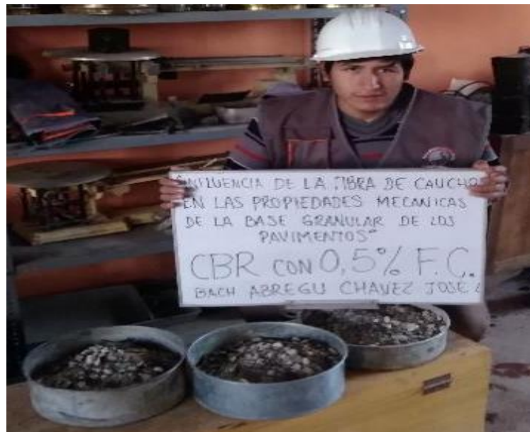
Figura 24. Muestras de material para CBR con 0.5% de caucho Fuente: propia
