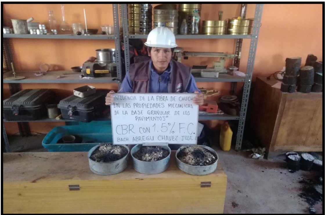
Fotografía 4. Material preparado para la compactación
