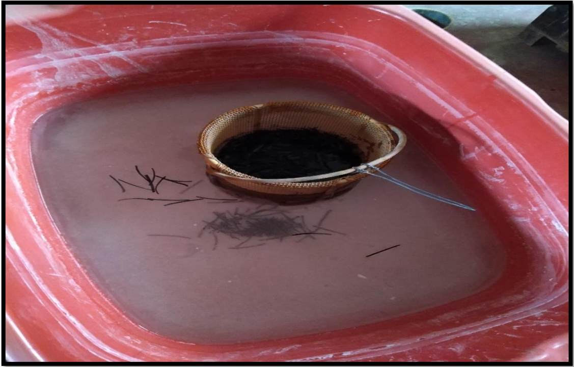
Fotografía 13. Colocación de fibra de caucho en agua por 24 horas
