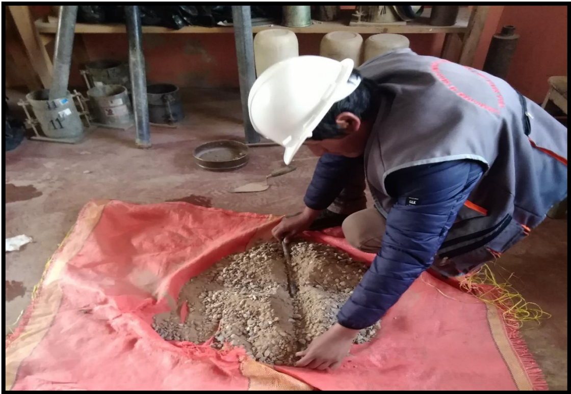
Fotografía 3. Cuarteo manual de material para base granular
