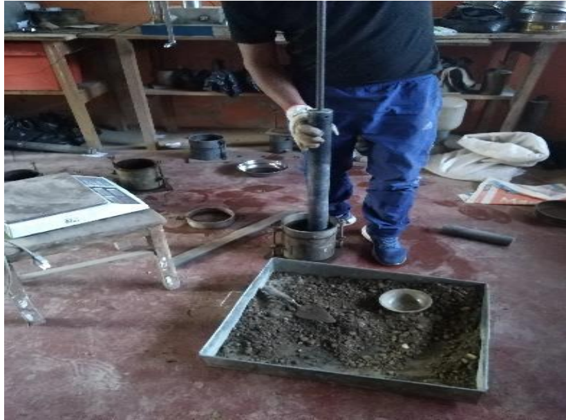
Figura 13. Compactación de la muestra para CBR. Fuente: propia
