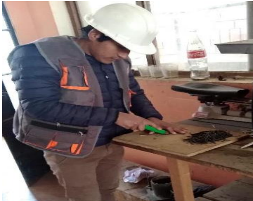
Figura 19. Corte de cámaras de caucho recicladas. Fuente: propia
