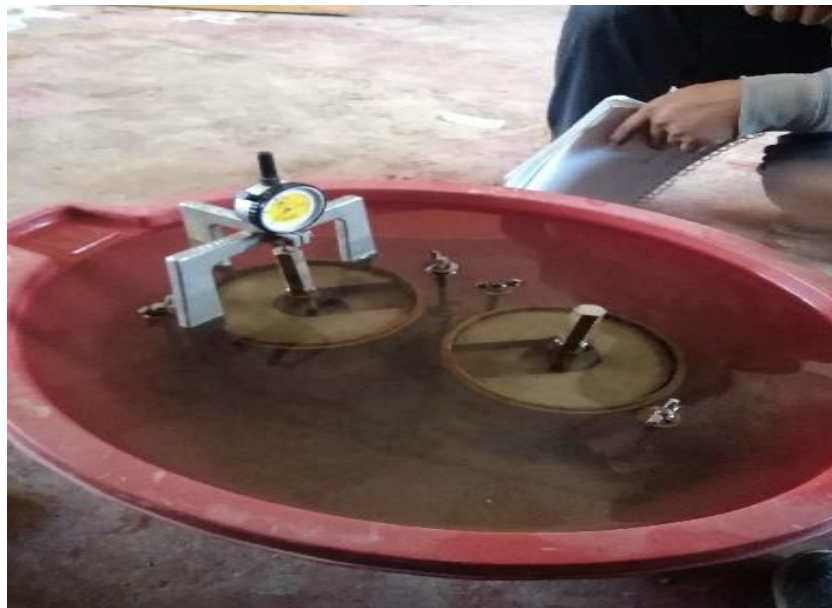
Figura 15. Muestra sumergida en agua y medición con el deformímetro. Fuente: propia
