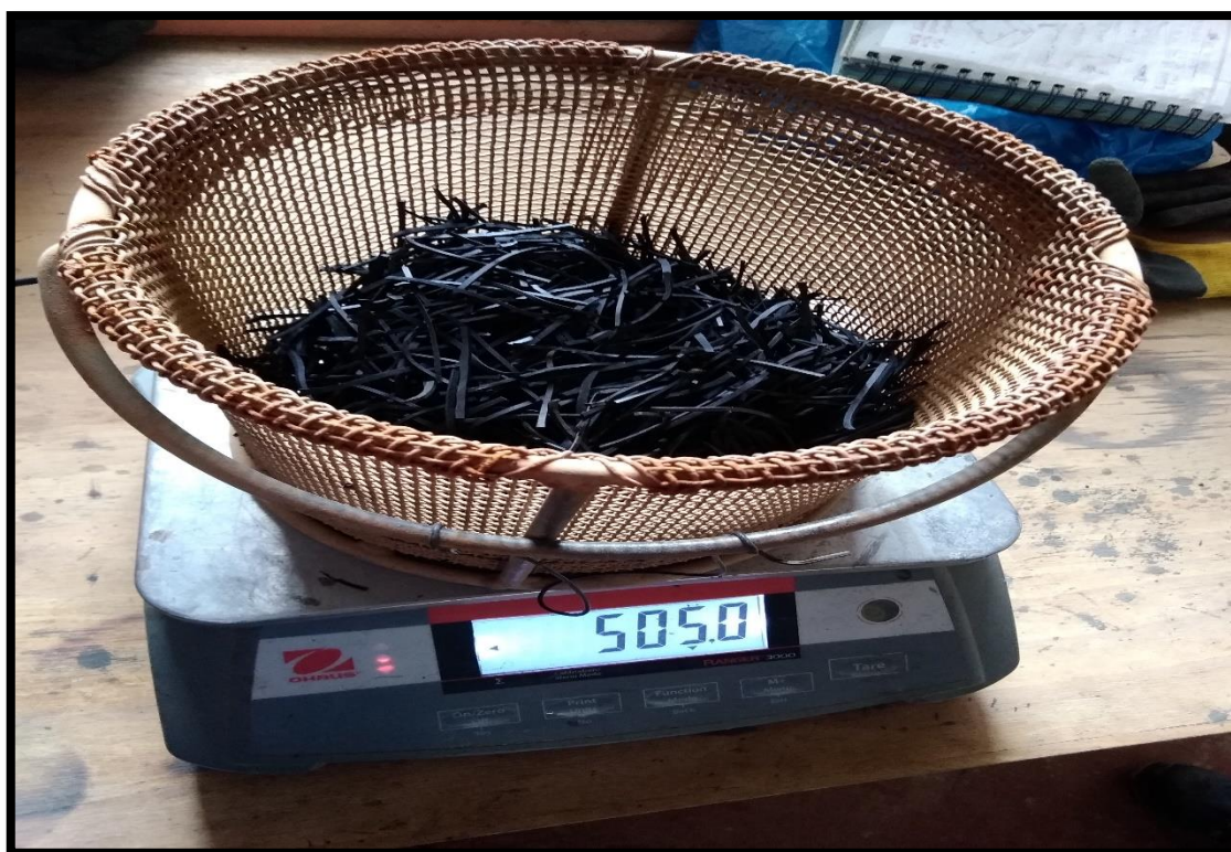
Fotografía 11. Peso de la fibra de caucho en seco
