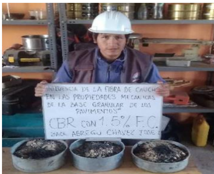
Figura 25. Muestras de material para CBR con 1.5% de caucho. Fuente: propia
