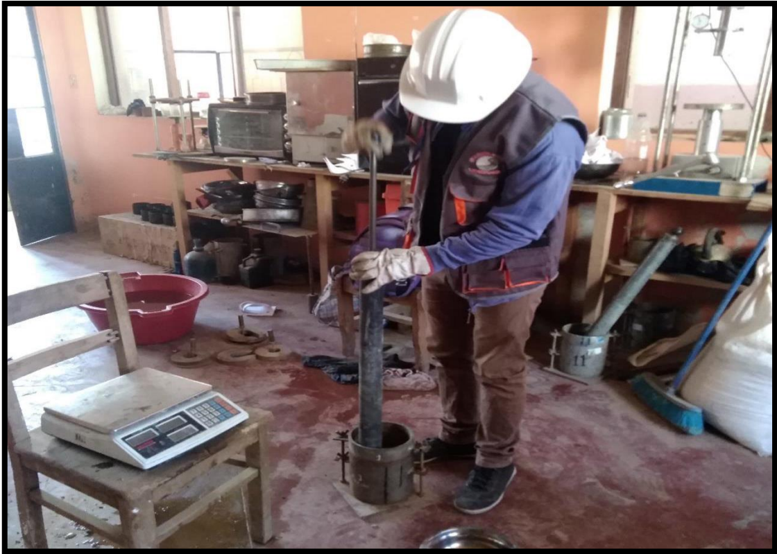
Fotografía 5. Compactación de material granular con fibra de caucho
