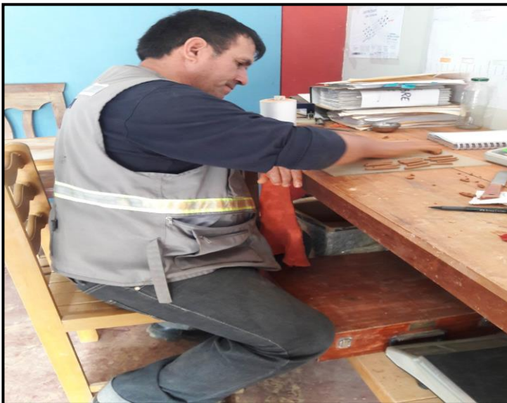
Fig. 17. Realizando los Límites líquidos y plásticos de las muestras de las calicatas.
