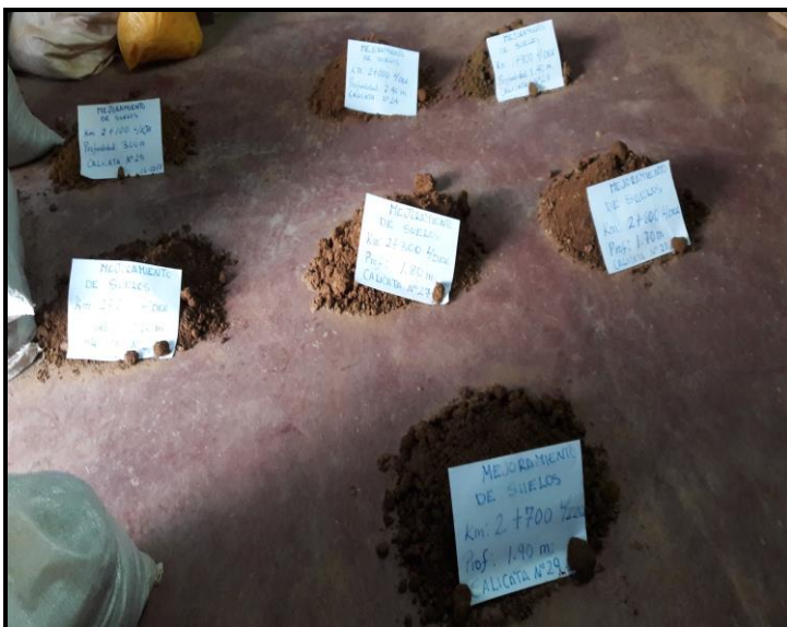
Fig. 18. Muestras de las diferentes calicatas para los ensayos de mecánicas de suelos.
