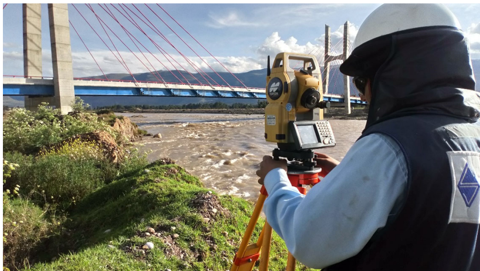
Figura 39 - Lectura de Dianas a los 48 hr de realizar la prueba de carga
