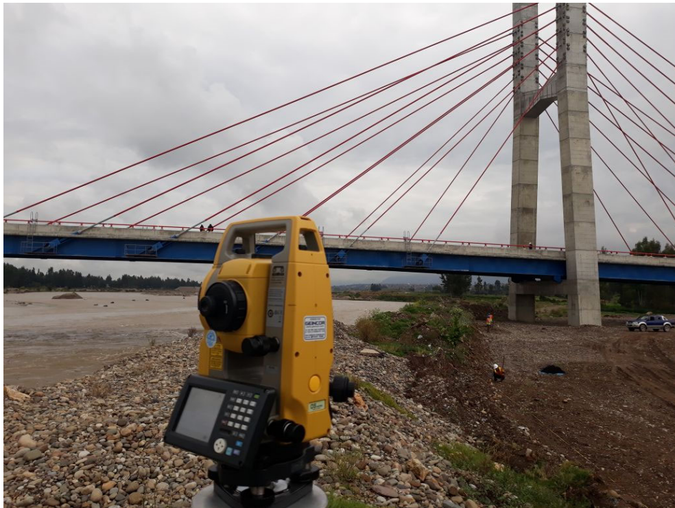
Figura 27 - Toma de datos antes de la prueba de carga
