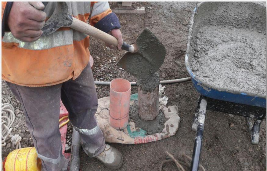
**Imagen N°09:** En la imagen se puede apreciar la incorrecta preparación de Testigo.
