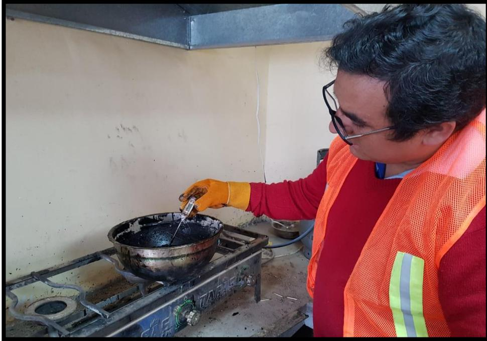
Figura 50: Antes de proceder a compactar se verifica la temperatura a 160 °C con ayuda del termómetro.
