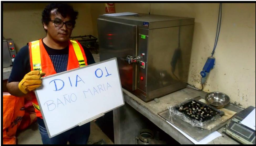
Figura 30: Colocación de la muestra en baño María a  $55 \pm 5$  C° día 2.
