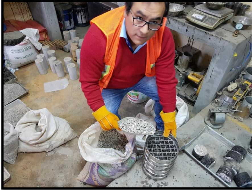
Figura 42: Se vierte cada agregado en los tamices determinados
