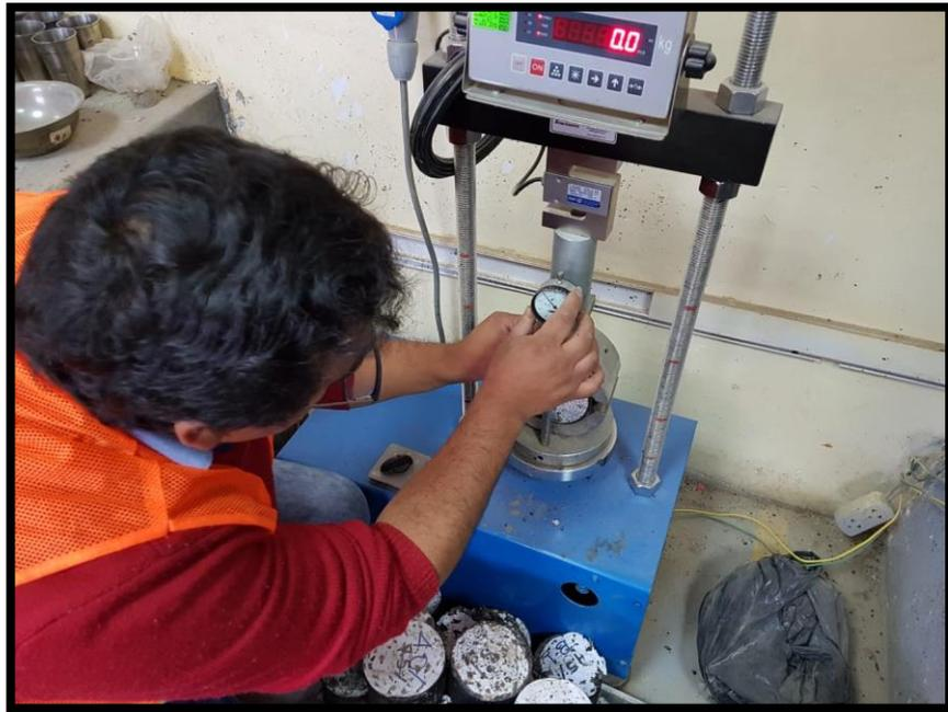
*Figura 63: Se somete cada briqueta a la prensa de Marshall*
