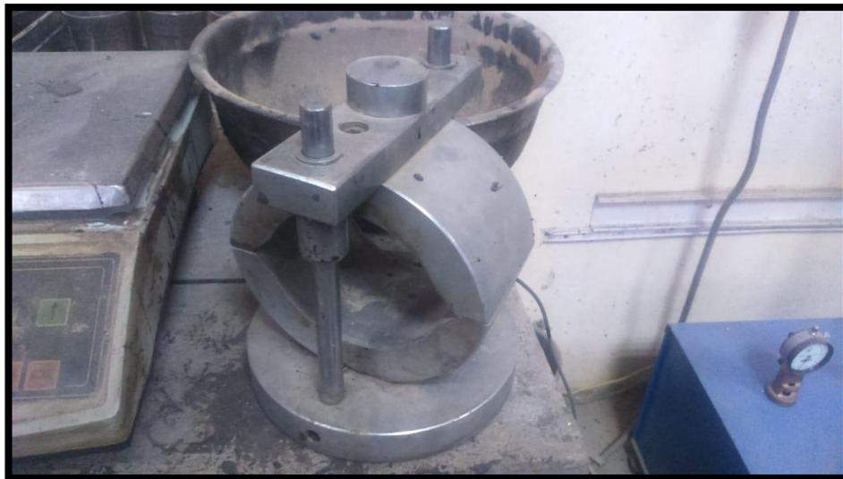
Figura 7: Prensa de Marshall (kg-f)
