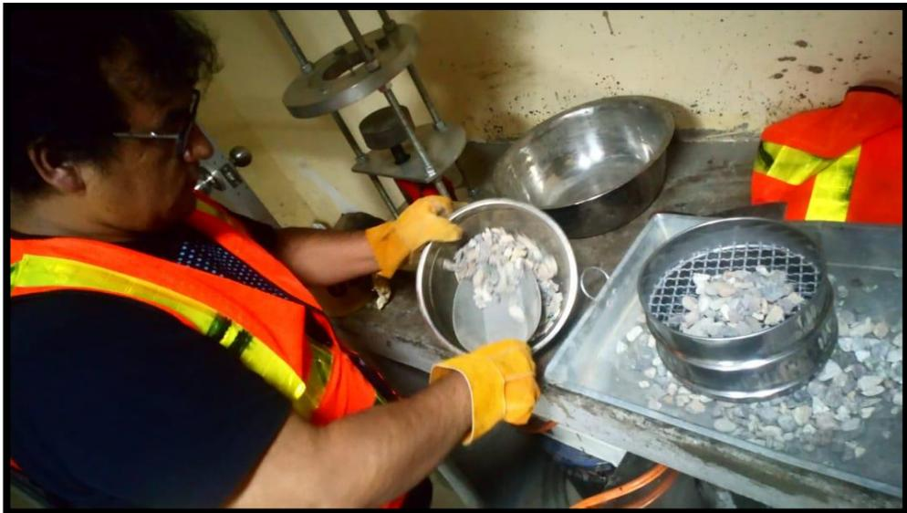
Figura 14: Obtención del material retenido en las mallas de 3/8".
