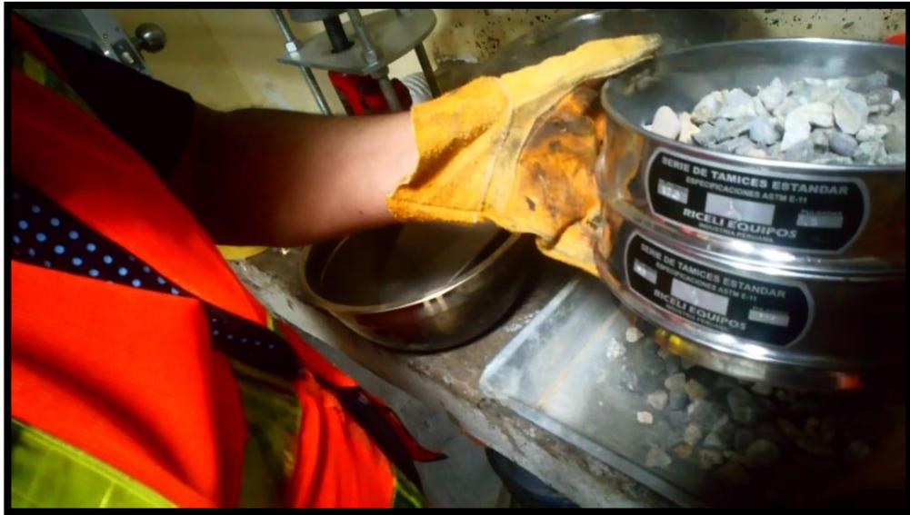
Figura 15: Material retenido en la malla 3/8"
