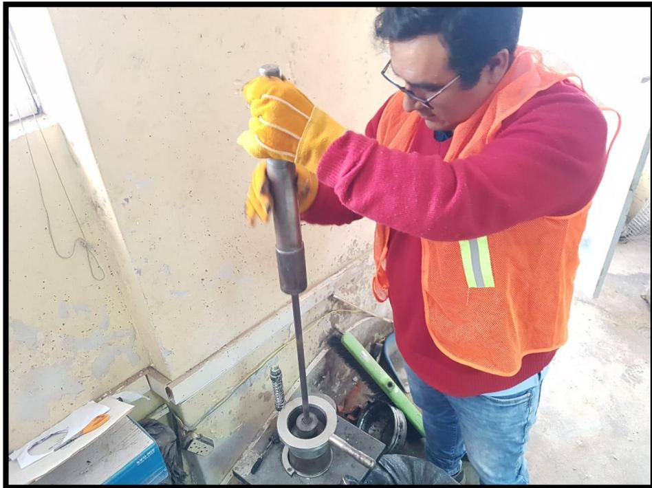
Figura 53: Se procede a compactar la mezcla a 75 golpes.
