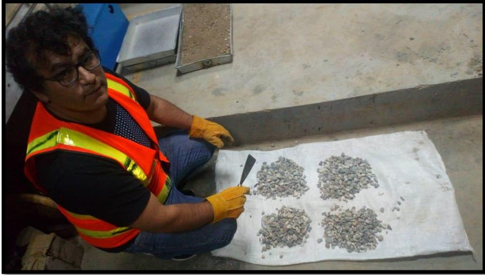
Figura 13: Tamizado de la muestra con las mallas de 1/2" y 3/8".
