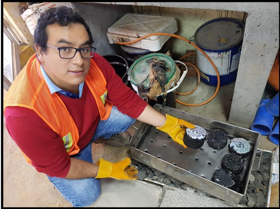
Figura 61: Se dejan remojando según el tiempo de estudio requerido en agua pluvial
