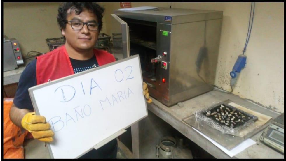
Figura 31: Colocación de la muestra en baño María a  $55 \pm 5$  C° día 2.
