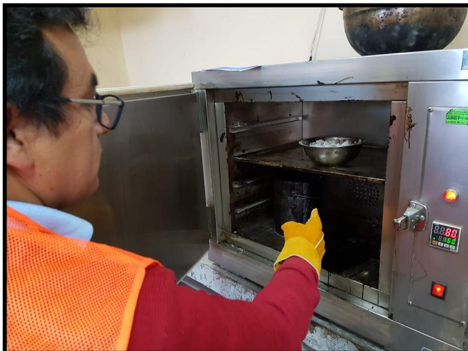
Figura 46: Se calienta los agregados a 160 °C
