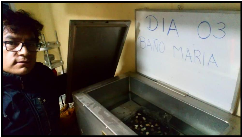
Figura 34: Colocación de la muestra en baño María a  $55 \pm 5$  C° día 4.
