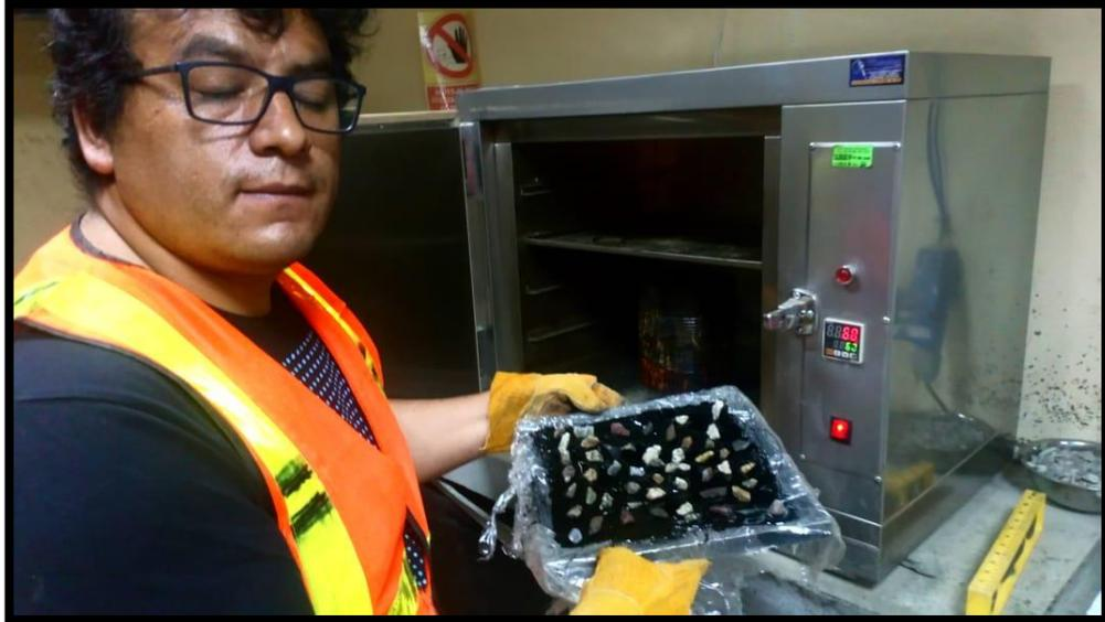
Figura 29: Colocación de la muestra en baño María a  $55 \pm 5$  C° día 1.
