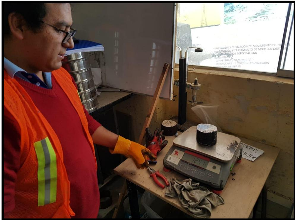
*Figura 59: Se toma el peso seco de la briqueta*
