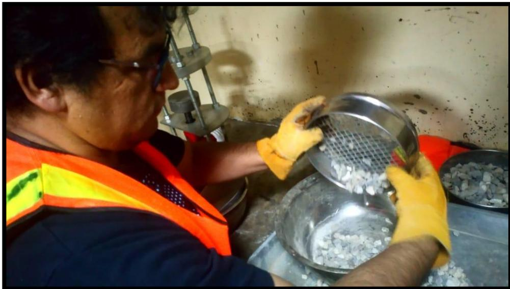
Figura 16: Lavado del material retenido en la malla de 3/8" para la eliminación de material fino.
