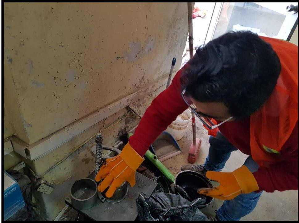
Figura 54: Se repite el compactado a 75 golpes volteando la briqueta a su segunda cara.
