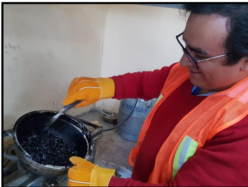
Figura 49: Se combinan los materiales en una mezcla uniforme a 160 °C
