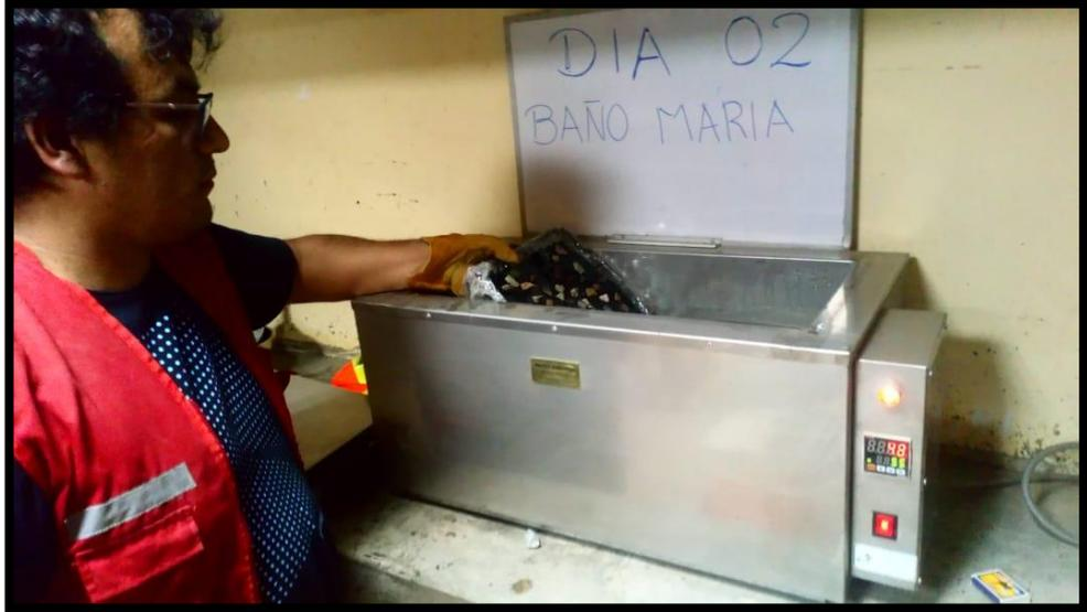
Figura 33: Colocación de la muestra en baño María a  $55 \pm 5$  C° día 3.
