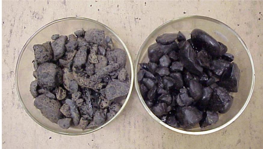
Figura 3: Efectos de un modificador Antistripping
