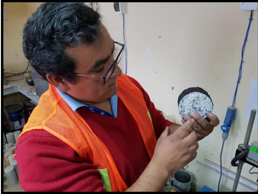
*Figura 65: Se obtiene la briqueta en su estado de deformación por la carga sometida*
