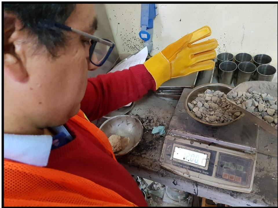
Figura 45: Se Procede a mezclar los agregados según diseño de mezcla
