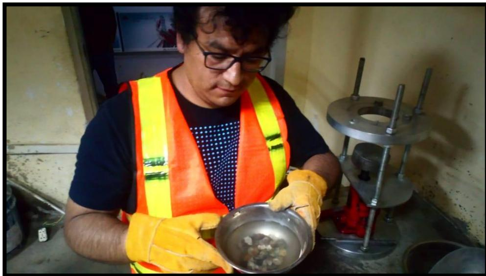
Figura 18: Secado superficial del material saturado.
