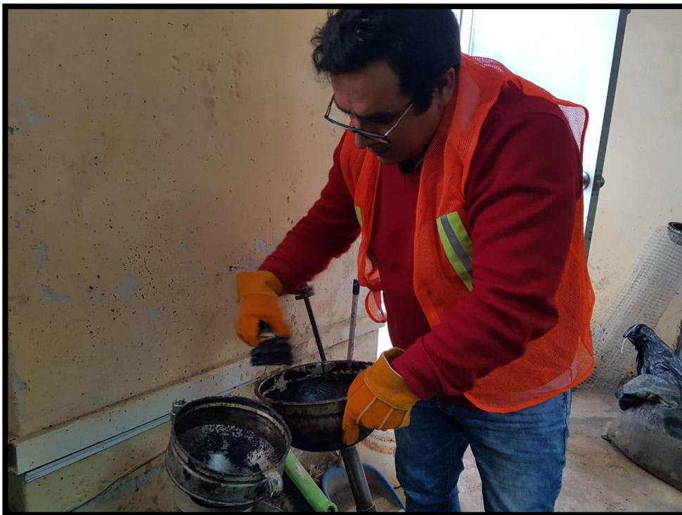
Figura 51: Con la mezcla a 160 °C, se vierte la mezcla al molde y se asegura con ayuda del pedestal
