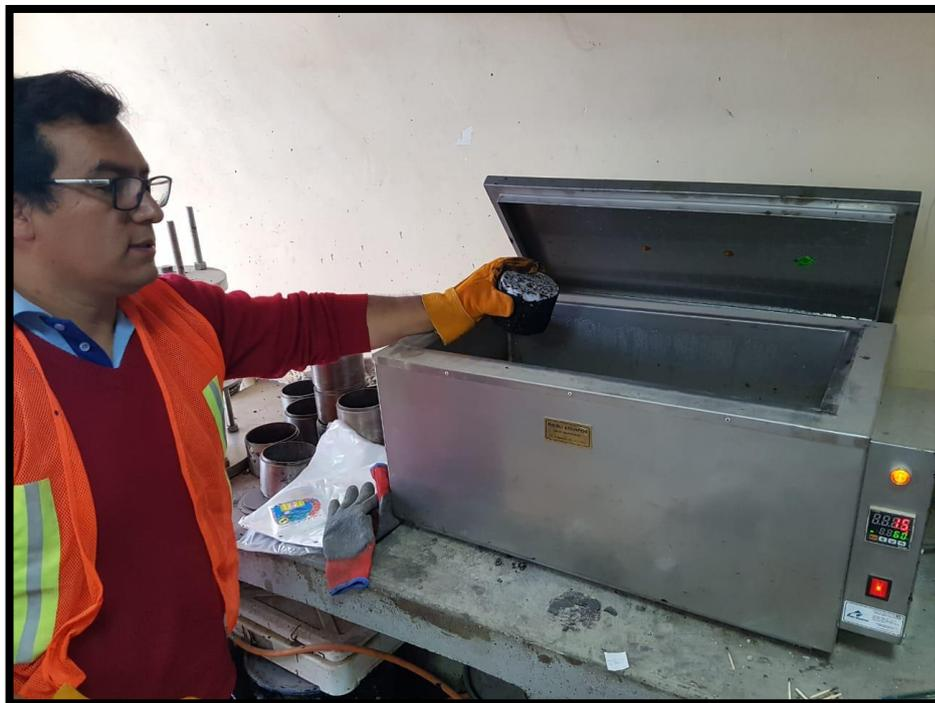
Figura 62: Listas para ensayar se sumergen en agua a 60 °C por 30 minutos cada briqueta
