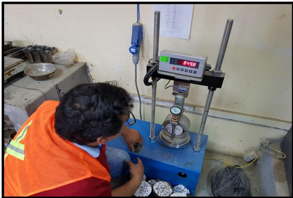
*Figura 64: Se ensaya cada briqueta tomando los valores de resistencia y deformación.*
