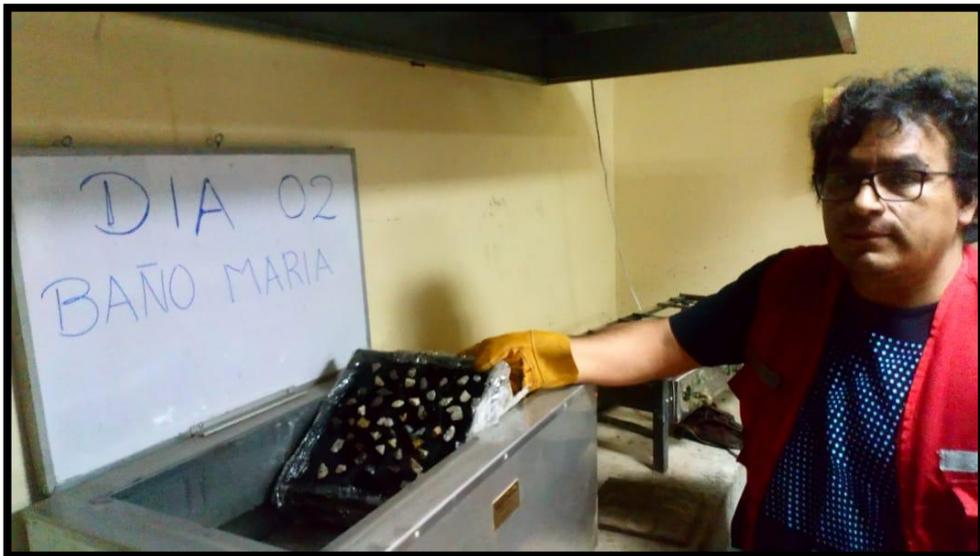
Figura 32: Colocación de la muestra en baño María a  $55 \pm 5$  C° día 2.
