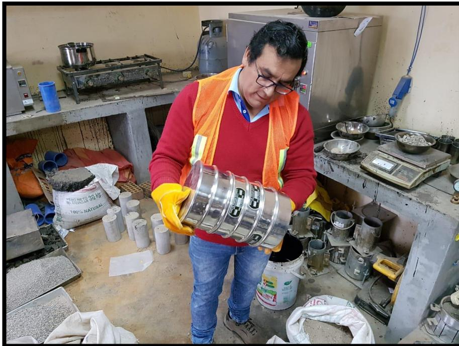
Figura 43: Se tamizan y caracteriza cada material, para obtener un diseño de mezcla
