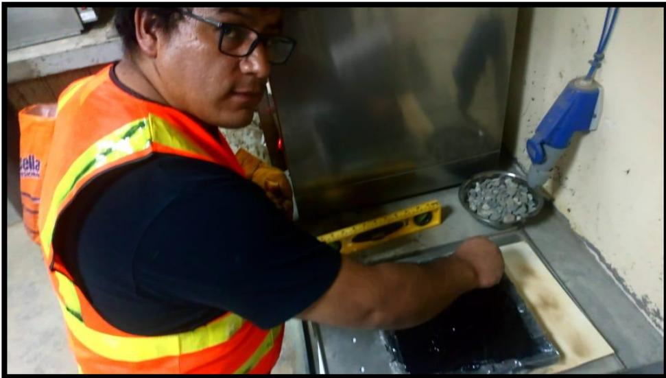
Figura 26: Colocación del material saturado superficialmente seco en el asfalto unidad por unidad.
