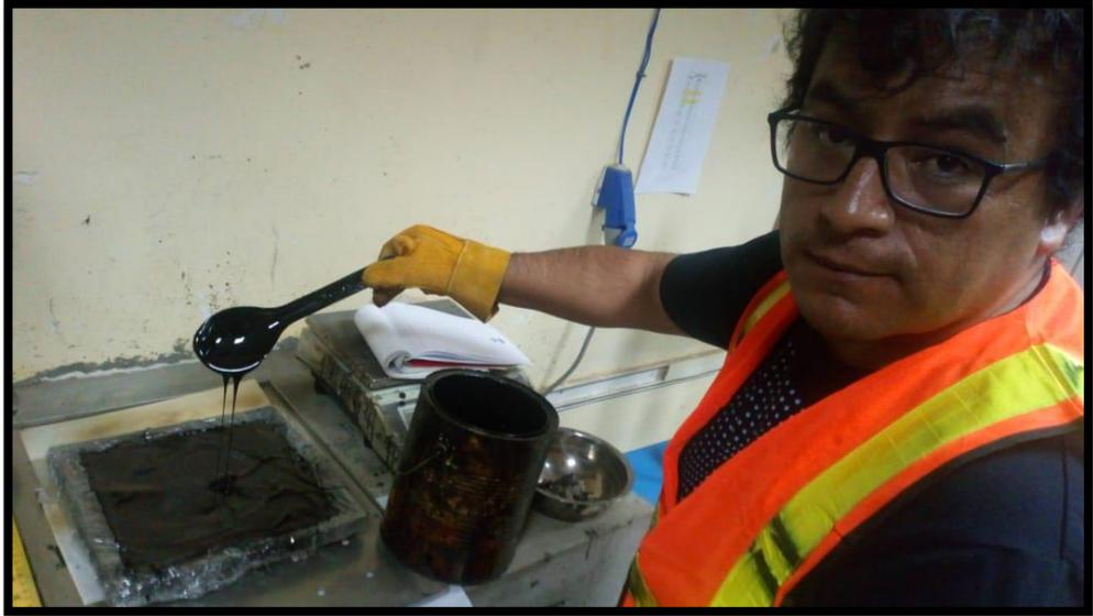
Figura 23: Nivelado del material asfáltico en bandeja.
