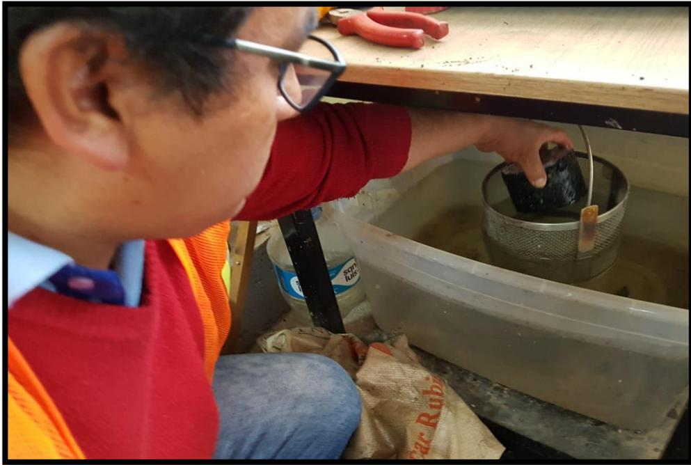
Figura 57: toma su peso específico, tomando en principio su peso
