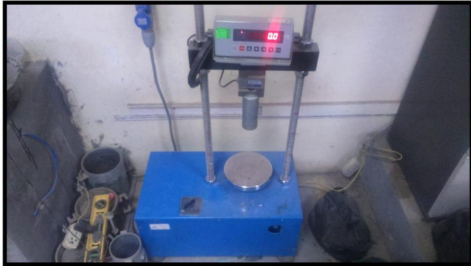
Figura 8: Dial de deformación (Marshall)
