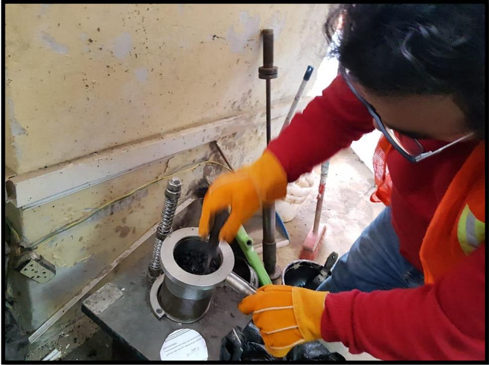
Figura 52: Una vez vertida la mezcla en el molde se procede con el achurado a 15 golpes en los bordes y 10 golpes al centro.
