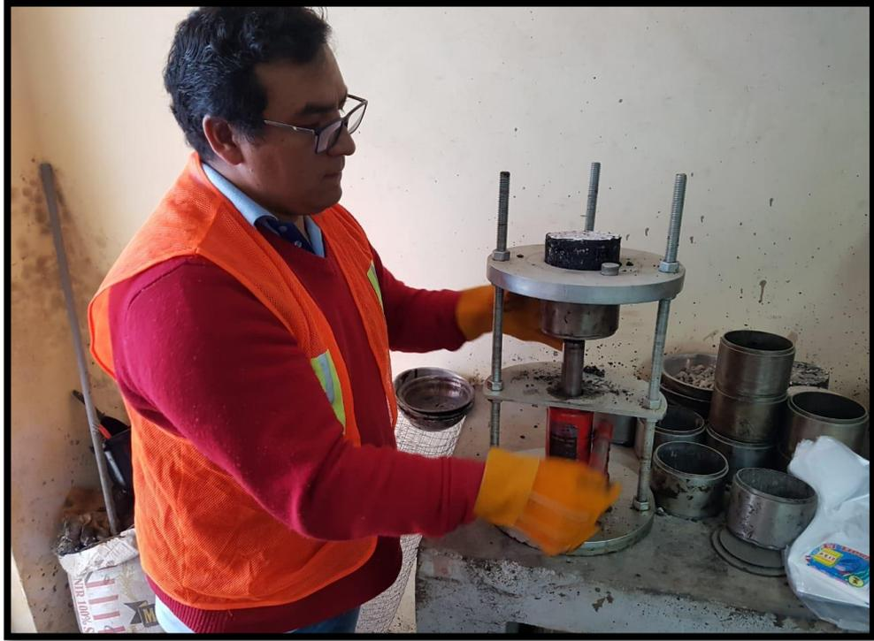
Figura 56: Una vez fría la briqueta se procede al desencofrado con la ayuda de
