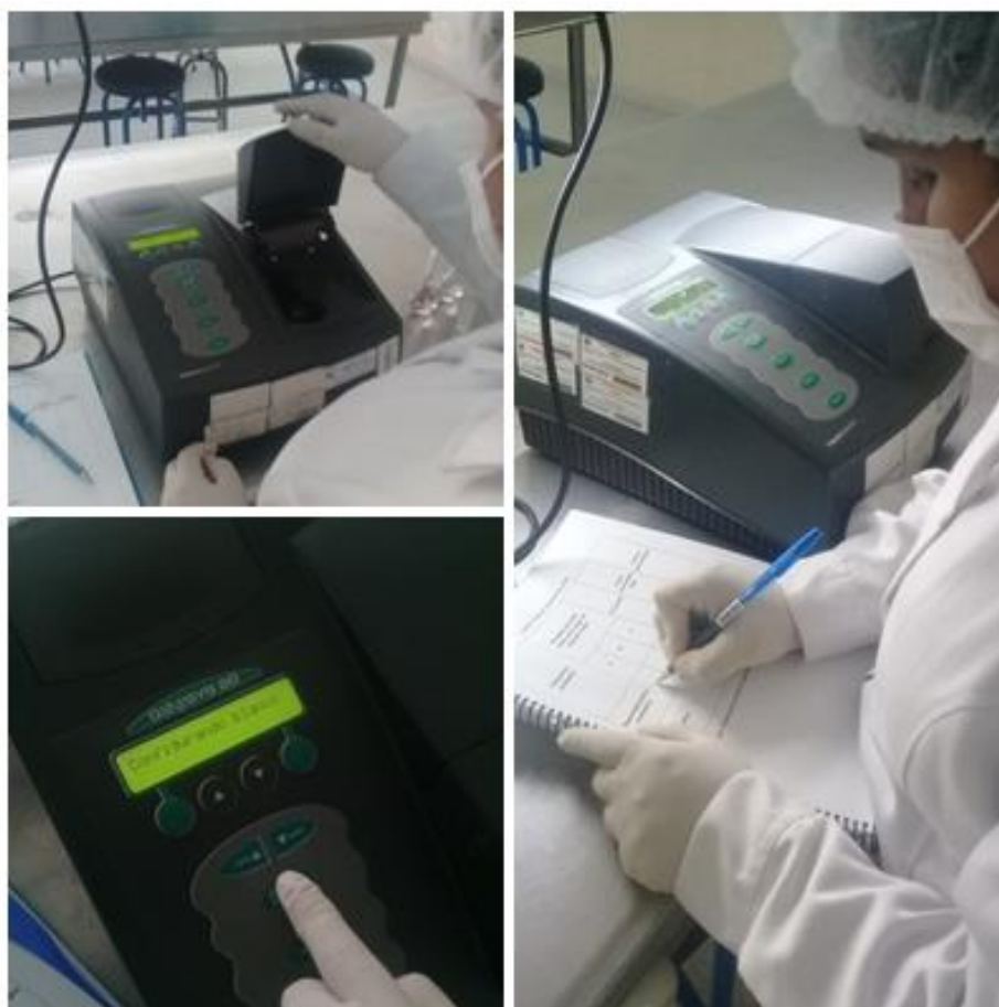
Lectura de las muestras en el espectrofotómetro de las muestras a 575nm Fuente: propia, noviembre 2019.
