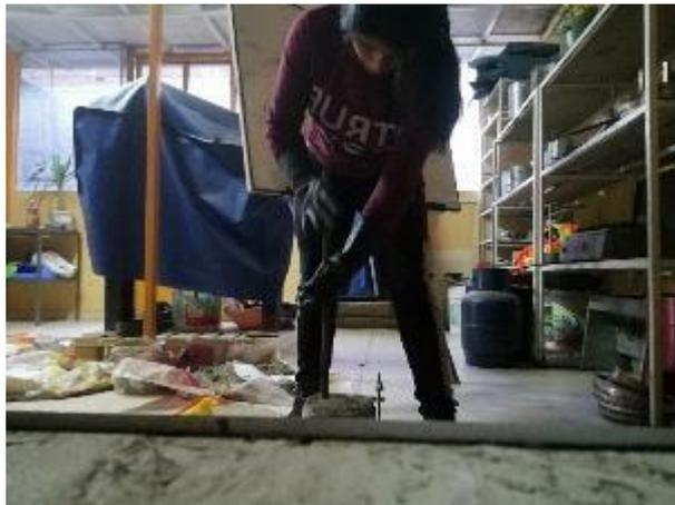
FOTO N° 14: Se realizó el peso unitario compactado del agregado fino, en tres capas con 25 golpes cada uno.
