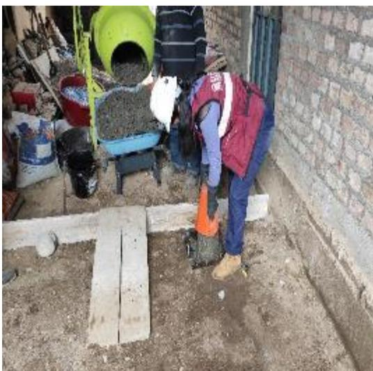
FOTO N° 19: Se realizó el ensayo de Asentamiento de la Dosis 1 – Dosis 2 – Dosis 3 cumpliendo los estándares del Diseño de Mezcla de 3” – 4”.
