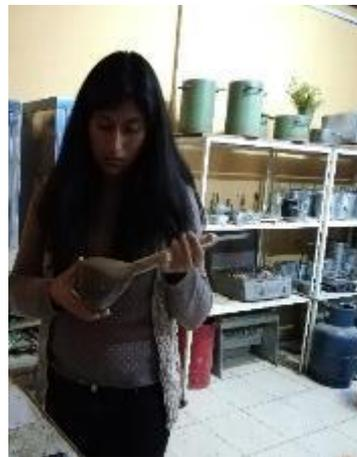
FOTO N° 12: Eliminando el aire atrapado en el picnómetro
