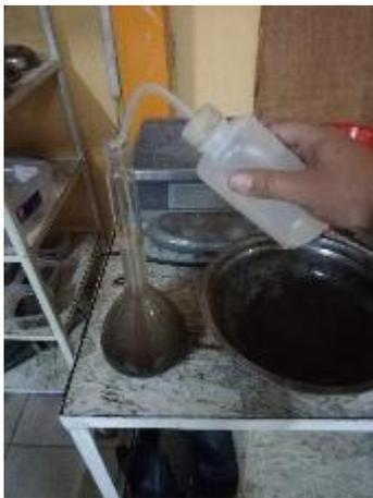
FOTO N° 11: Se introdujo 500 gr de material preparado y agua al picnómetro
