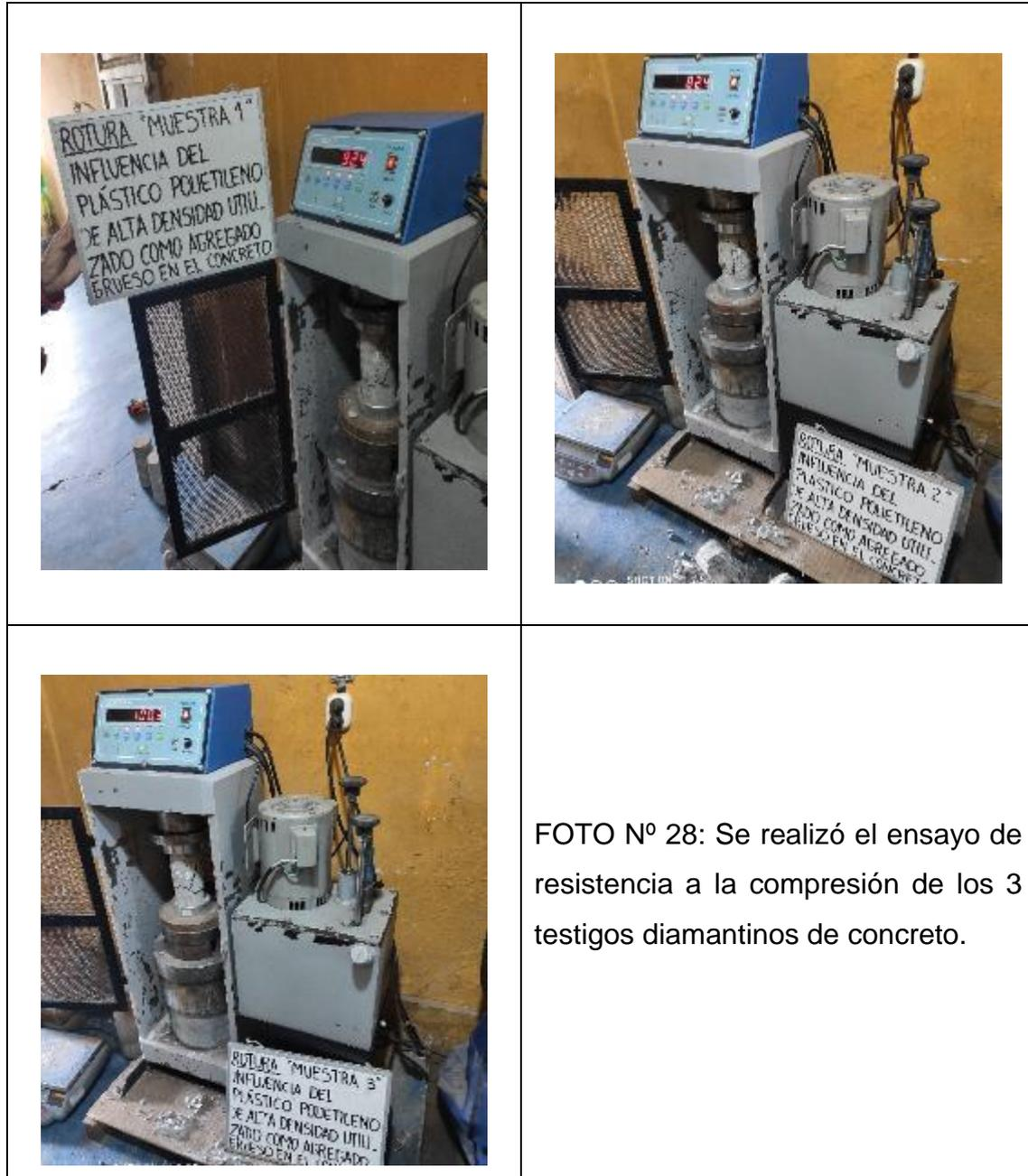
FOTO N° 28: Se realizó el ensayo de resistencia a la compresión de los 3 testigos diamantinos de concreto.
