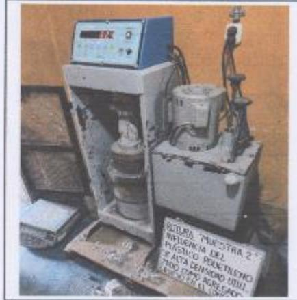
FOTO 07.- ROTURA DEL TESTIGO DIAMNATINO T-02 CORRESPONDIENTE AL PROYECTO:
