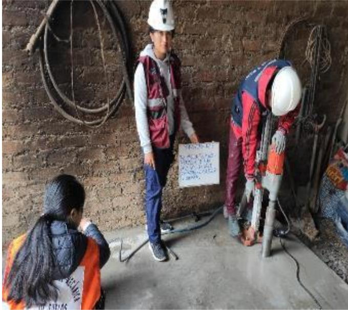
FOTO N° 26: Se realizó el ensayo de Diamantina del pavimento (losa corta) de 3m x 3m x 0.15cm
