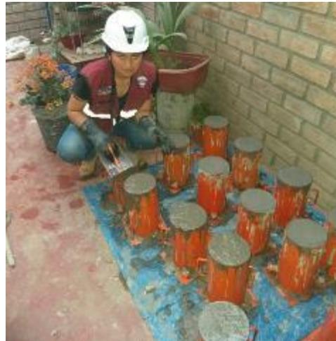
FOTO N° 20: Se muestrearon testigos de concreto de la Dosis 1 –Dosis 2 –
