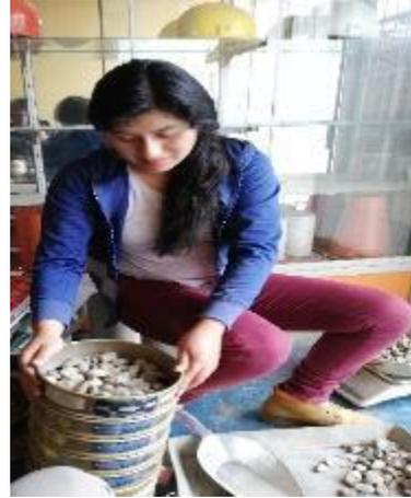
FOTO N° 02: Realizando el tamizado del agregado grueso
