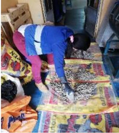
FOTO N° 01: Cuarteo del agregado grueso para su respectivo tamizado
