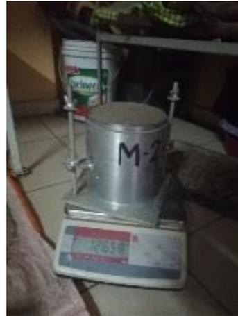
FOTO N° 13: Se determinó el peso unitario suelto del agregado fino
