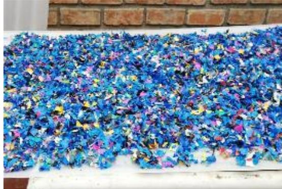
FOTO N° 16: Secado del Plástico Polietileno de Alta Densidad
