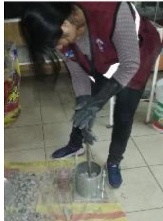
FOTO N° 06: Peso unitario compactado del agregado grueso en tres capas con 25 golpes.
