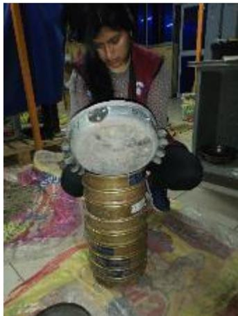
FOTO N° 08: Se procedió con el análisis granulométrico del agregado fino
