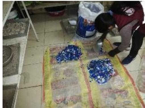
FOTO N° 17: Se realizó el cuarteo del Plástico Polietileno de Alta Densidad
