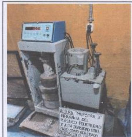
FOTO 08.- ROTURA DEL TESTIGO DIAMNATINO T-03 CORRESPONDIENTE AL PROYECTO:
