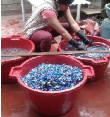
FOTO N° 15: Se seleccionó el plástico tipo 2 y se trituro, se lavó el plástico eliminando impurezas
