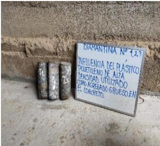
FOTO N° 27: Se extrajo 3 muestras mediante el ensayo de diamantina.
