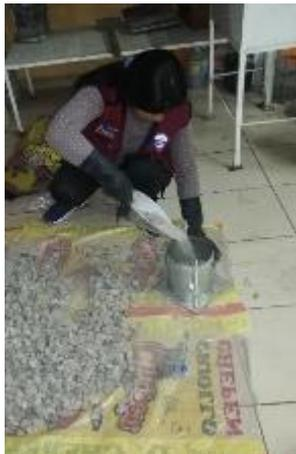
FOTO N° 05: Realizando el ensayo del peso unitario suelto del agregado grueso.
