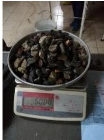
FOTO N° 03: Peso de la muestra saturada de superficie seca
