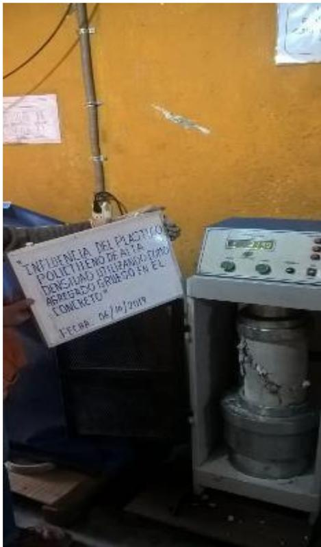
FOTO N° 21: Se realizó el Ensayo de Resistencia a la Compresión Simple en Probetas de la Dosis 1 – Dosis 2 – Dosis 3 de un  $F'c = 210 \text{ kg/cm}^2$
