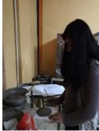
FOTO N° 10: Se retiró el cono para verificar que el agregado fino llego a alcanzar su condición de superficie seca
