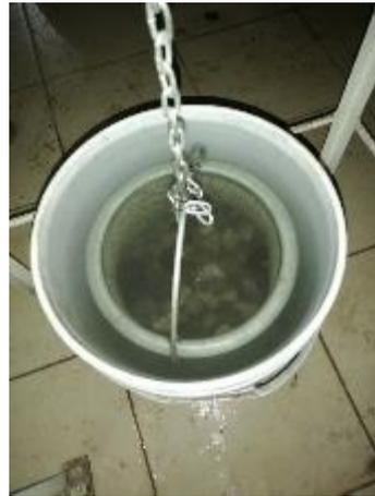
FOTO N° 04: Determinando el peso de la muestra sumergido en el agua
