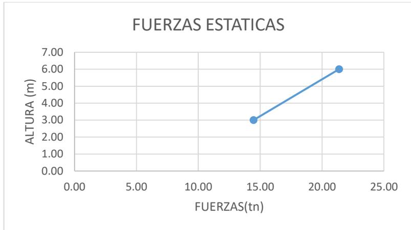
Figura No. 35: Línea de Cargas estáticas en X-X del I.E. I.C.M
