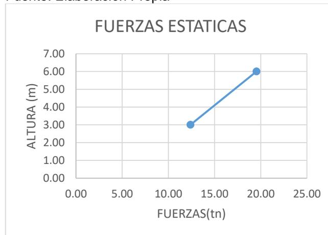
Figura No. 119: Línea de Cargas estáticas en Y-Y del I.E. J.M.A.
