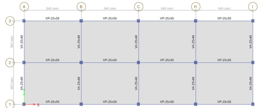
Figura No. 214. Planteamiento de dimensiones de elementos estructurales – I.E. N°30153
