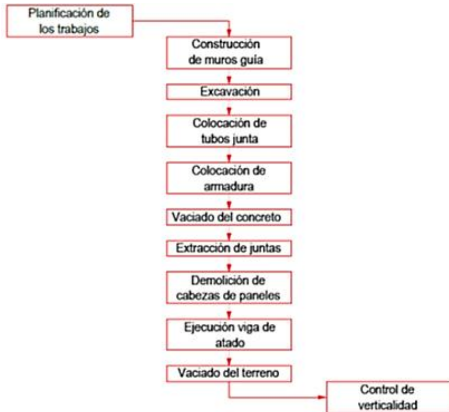
Figura 22. Etapas de construcción de muros anclados.
