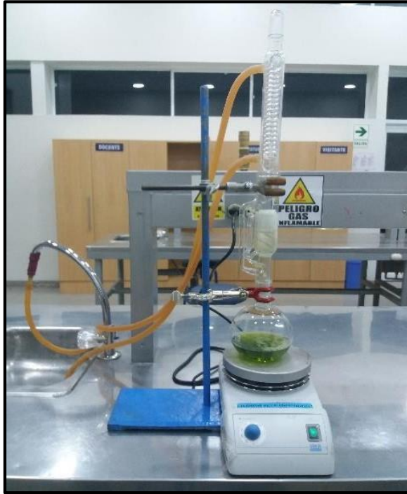
Figura 12: Extracción de clorofila y pigmentos con el equipo Soxhlet. Fuente: Elaboración propia, 2019
