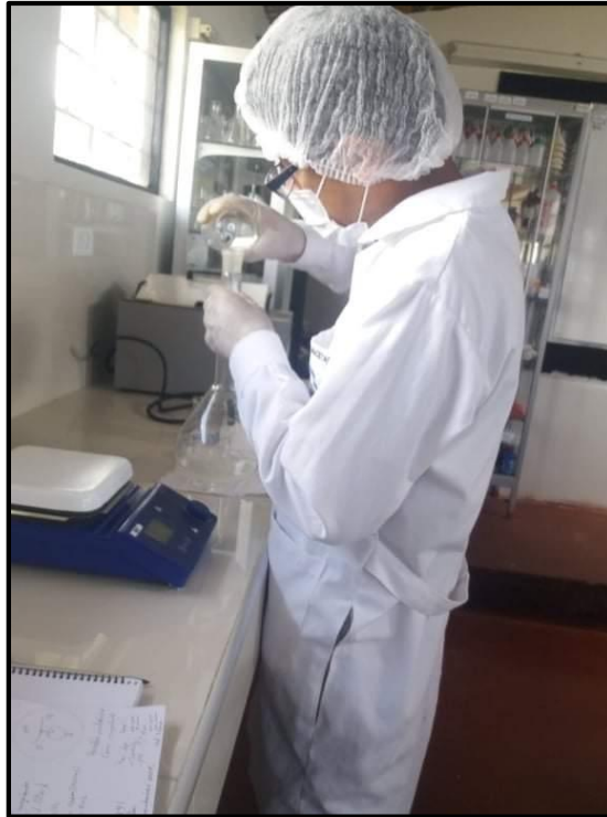
Figura 20: Aforo del coagulante en una fiola de 1000 mL a 1000 ppm. Fuente: Elaboración propia, 2019
