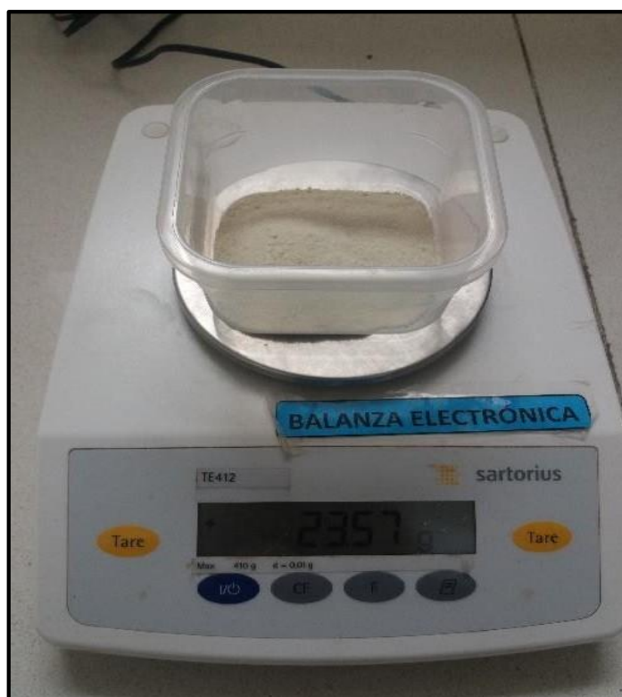
Figura 11: Pesado después del molido y tamizado de A. floccosa . Fuente: Elaboración propia, 2019
