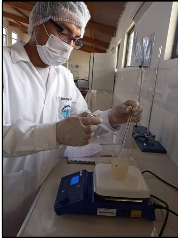
Figura 18: Preparación del coagulante natural. Fuente: Elaboración propia, 2019
