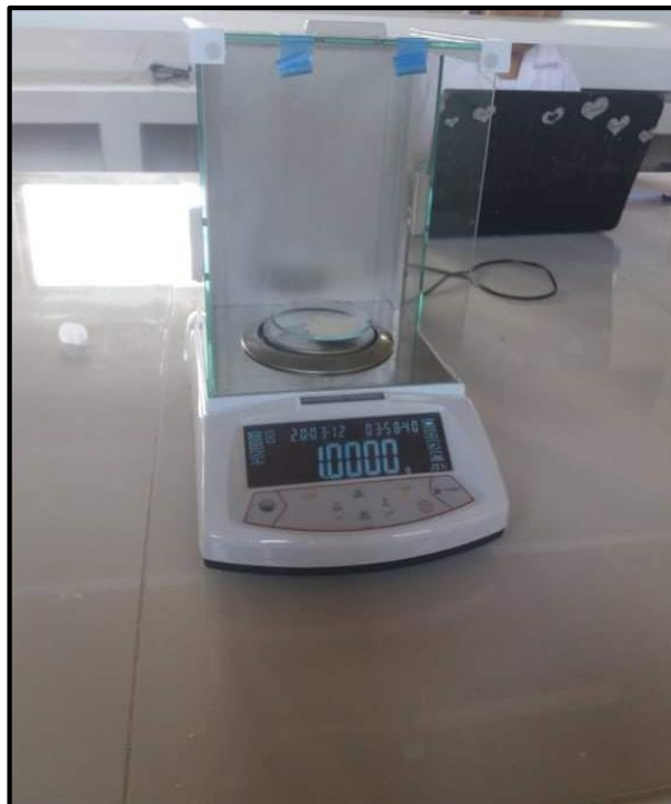
Figura 17: Pesado de 1g de coagulante. Fuente: Elaboración propia, 2019
