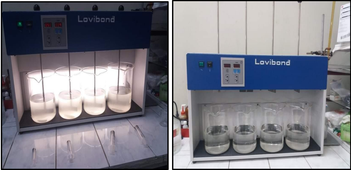
Figura 24: Prueba de jarras usando distintas concentraciones en la izquierda agua en tratamiento y en la derecha agua después del procedimiento. Fuente: Elaboración propia, 2019
