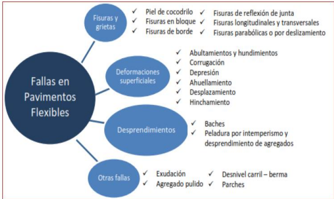
Figura 2 Fallas en los Pavimentos Flexibles Establecidos por el PCI Fuente: (Rodríguez V., 2009)
