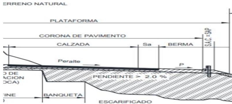
Figura 5. Berma como parte de una calzada
