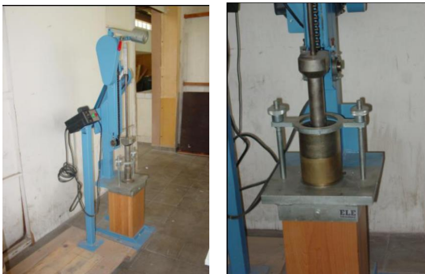
Fotografía N° 2.6 Equipo compactador y muestra en proceso de compactación
