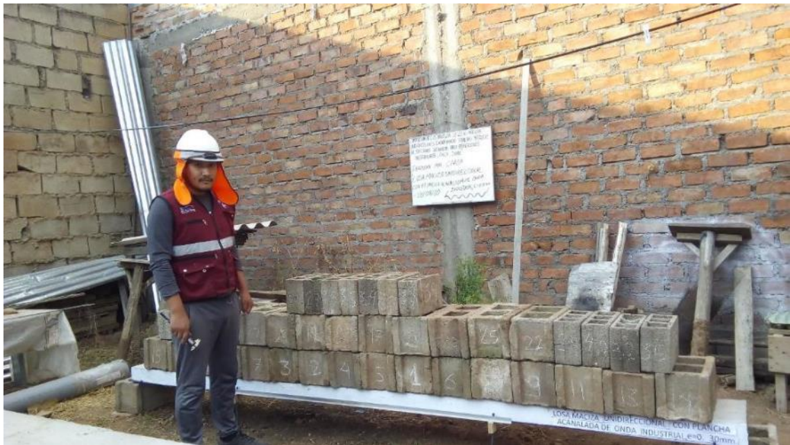
Control de deflexiones por carga en la losa maciza unidireccional con plancha acanalada de onda industrial, e=0.30 mm.
