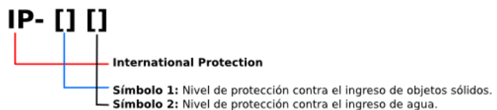
Ilustración 10: Composición del grado de protección IP
