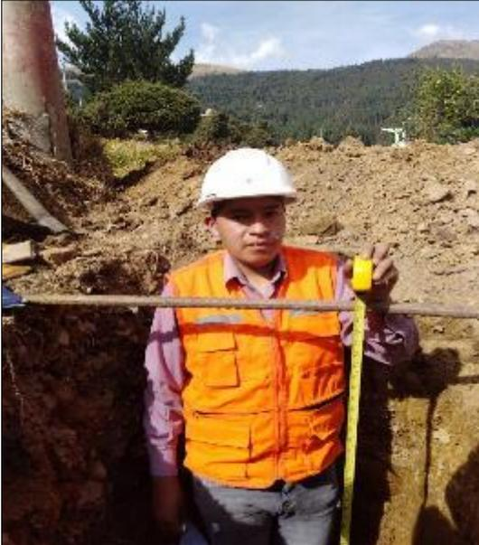
Figura 21. Medición de la calicata C - 01.
