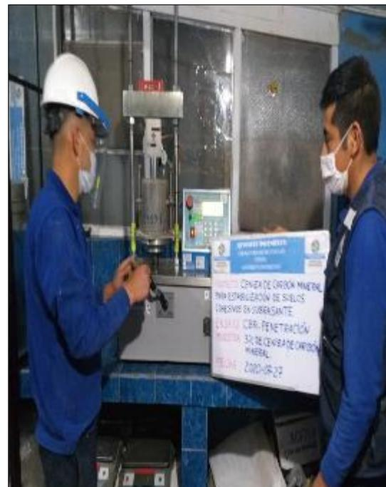
Figura 40. CBR-Penetración.
