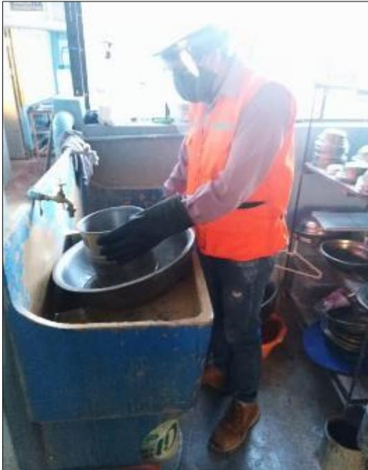
Figura 27. Lavado del material para granulometría.
