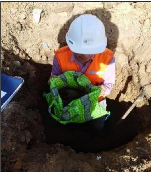
Figura 23. Toma de muestra de la calicata C -01.
