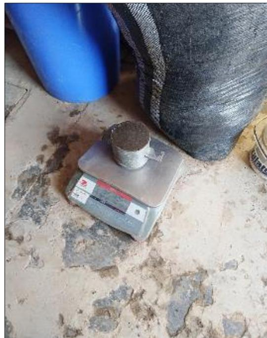
Figura 38. Peso de la muestra compactada.
