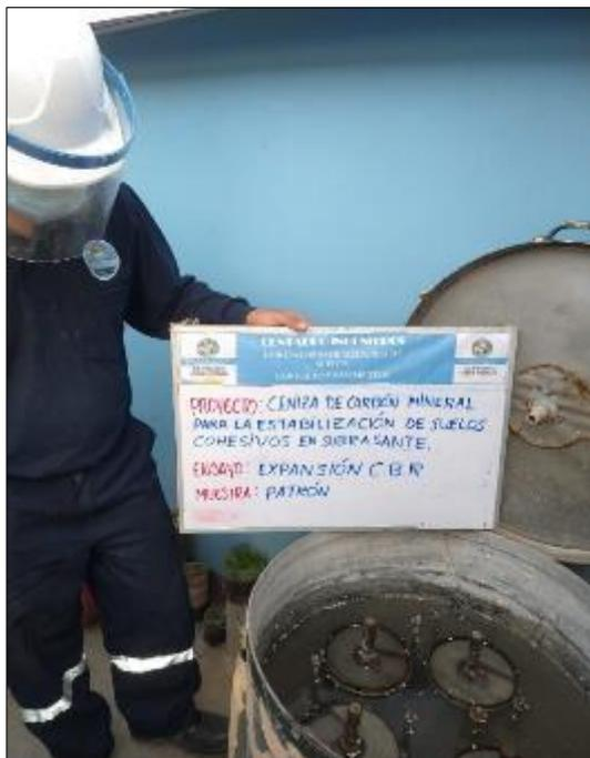
Figura 39. Saturación de la muestra.
