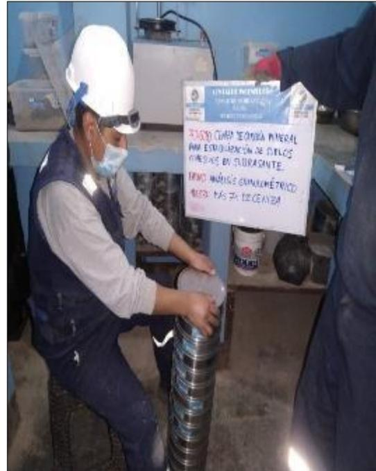
Figura 28. Tamizado del material.
