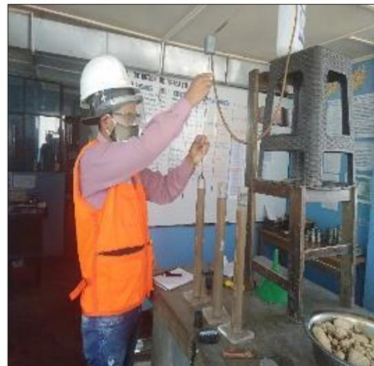
Figura 36. Medición de arena y arcilla.
