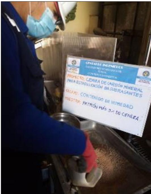
Figura 29. Preparación de la muestra.
