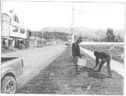
FOTOS 04: SE OBSERVA UNA VISTA PANORAMICA DE LA EXCAVACION DE LA CALICATA C-02
