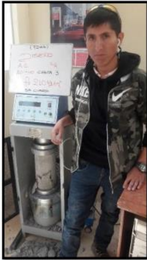
FIGURA N° 15: rotura de especimen de concreto, Colegio Santa Isabel.
