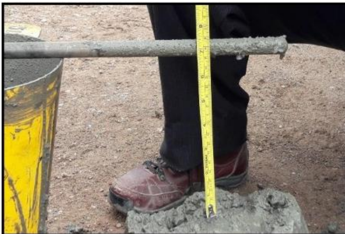
FIGURA N° 09: medición del asentamiento en planta de concreto, Colegio Santa Isabel.
