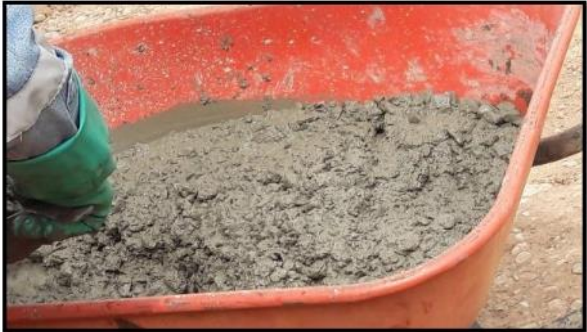
FIGURA N° 07: Muestreo de concreto premezclado, Colegio Santa Isabel.
