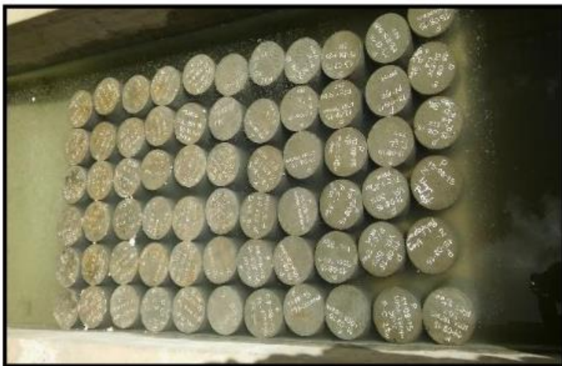
FIGURA N° 14: curado de especimen de concreto, Colegio Santa Isabel.
