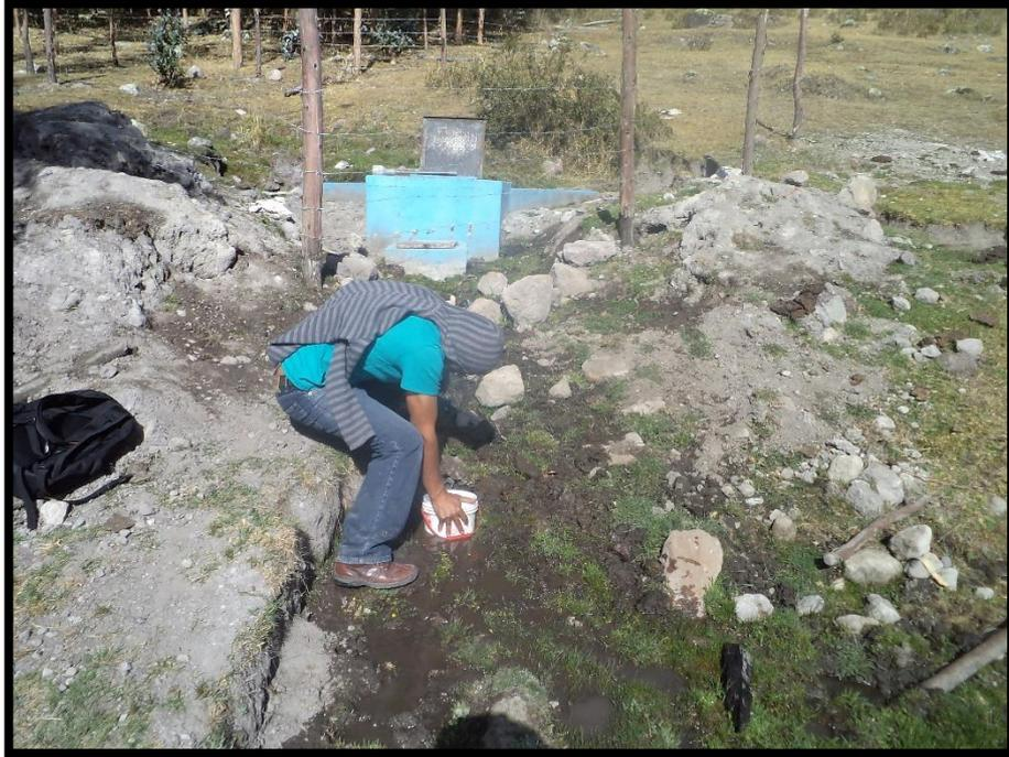
Foto N° 03, Aforamiento de la captación existente
