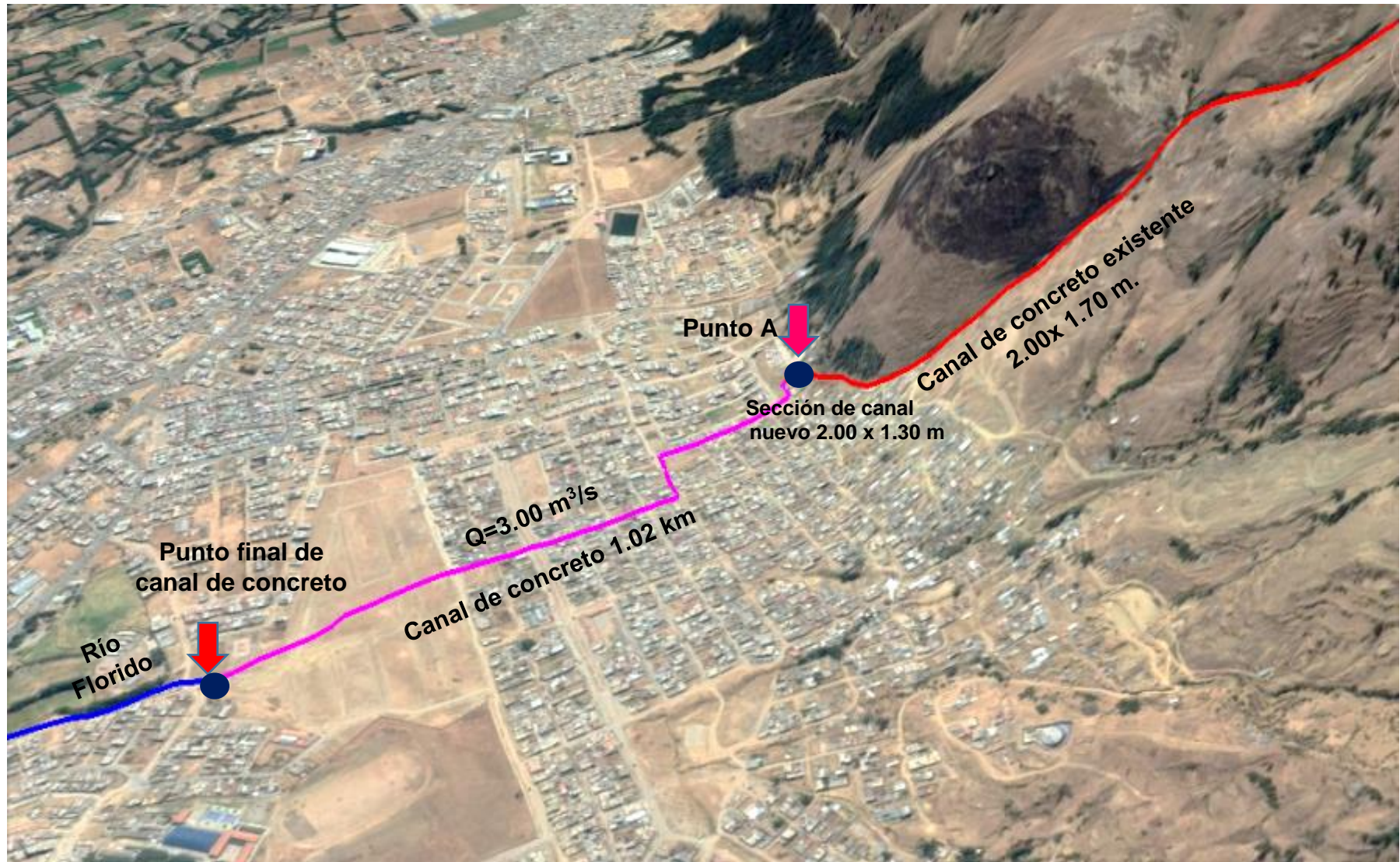
Imagen 10: Recorrido de la escorrentía de la quebrada con la construcción de canal de concreto-Sector 01
