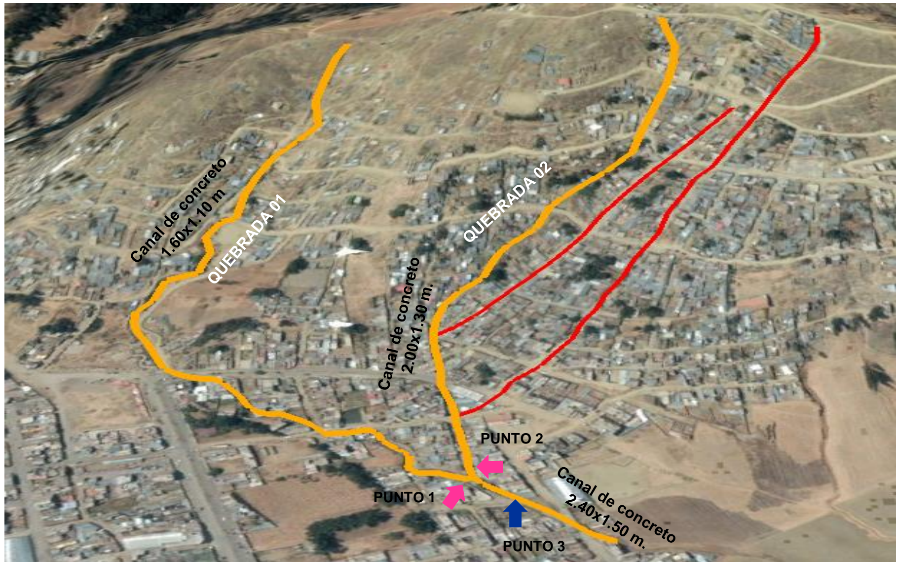
Imagen 12: Dimensiones calculadas en base a caudales reales de las quebradas del sector 03
