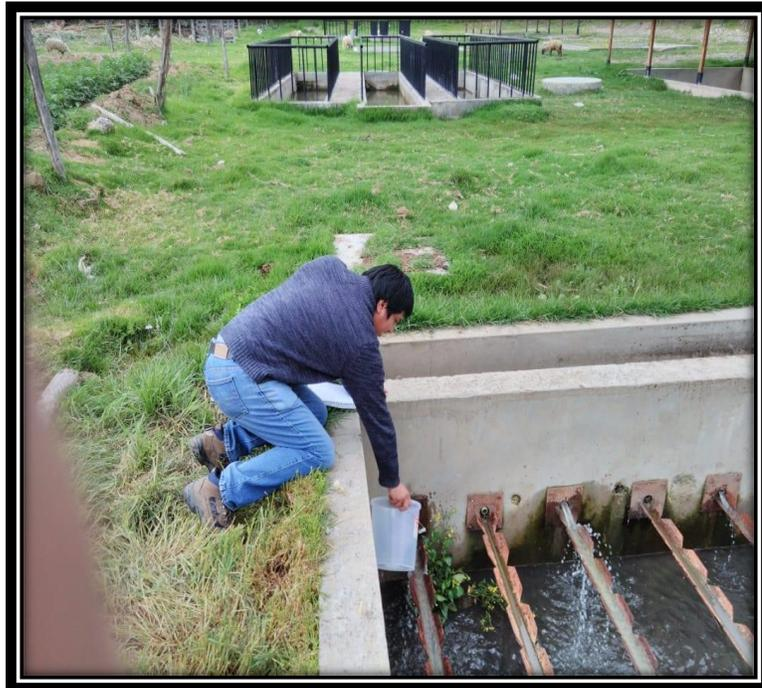
FOTO N°9 SACANDO LA MUESTRA DE LA LAGUNA DE ESTABILIZACION
