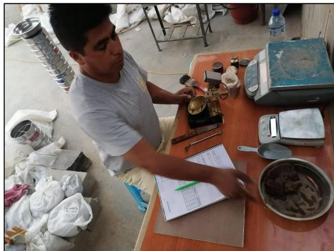
Fotografía 11. Preparación del suelo para la determinación del límite líquido del suelo en estudio.
