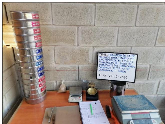
Fotografía 9. Vista de tamices para el análisis granulométrico del suelo.
