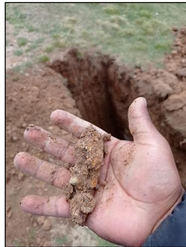
Fotografía 7 y Fotografía 8. Inspección visual del suelo encontrado en la calicata.
