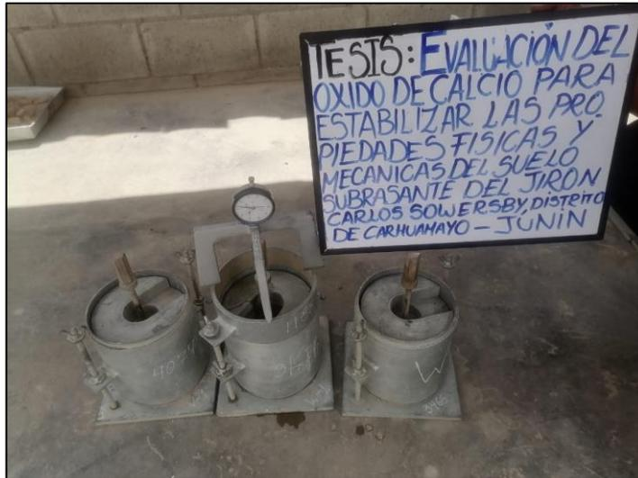
Fotografía 13. Medición de la expansión del suelo.
