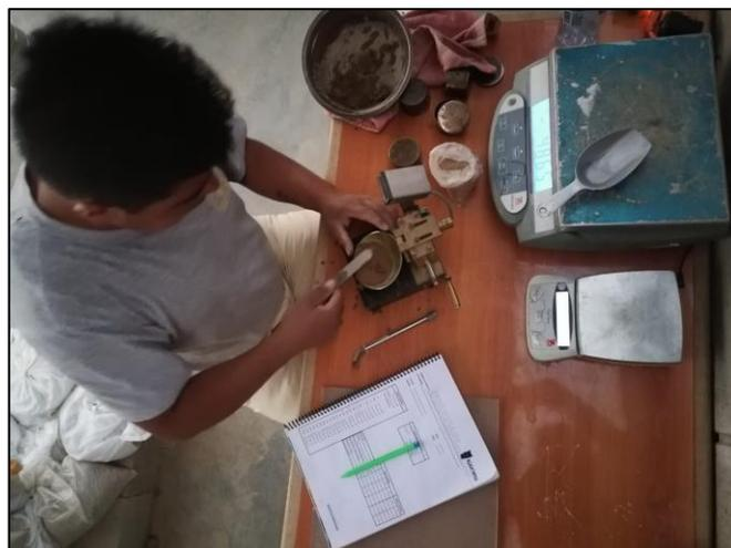
Fotografía 12. Determinación del límite líquido del suelo.
