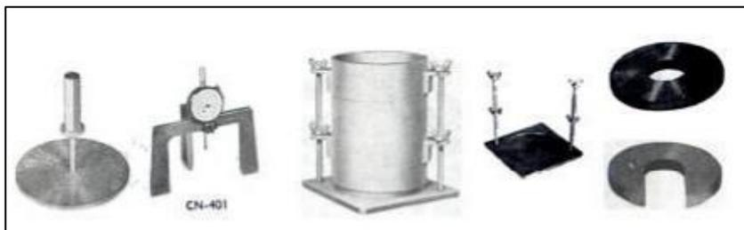
Figura 9. Instrumentos necesarios para la ejecución del ensayo de CBR. Fuente: Crespo (2004).
