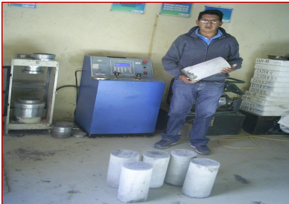
Fotografía N° 16: Rotura de las 48 probetas de concreto de 210 \text{ Kg/cm}^2 , a los 7, 14 y 28 días.
