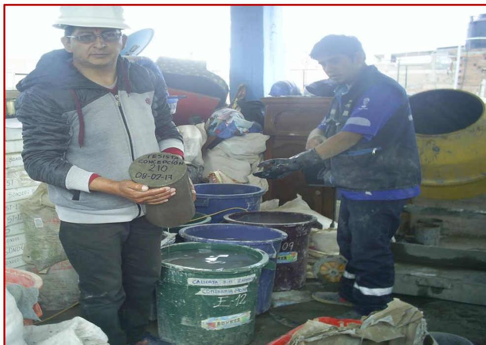
Fotografía N° 14: Curado de las 48 probetas de concreto f'c 210 Kg/cm 2 , siguiendo las especificaciones de la Norma Técnica Peruana.
