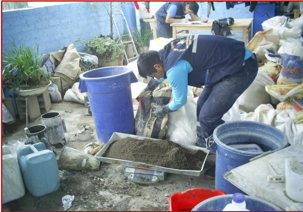
Fotografía N° 09: Del mismo modo se determina la proporción del agregado fino y cemento en kg. De acuerdo a diseño de mezcla.
