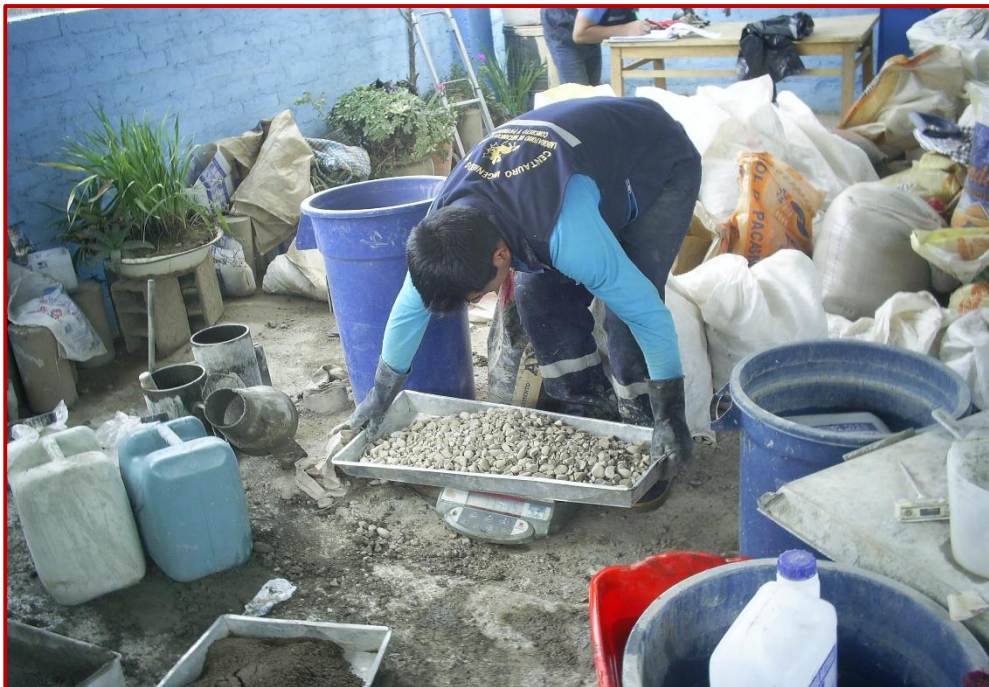
Fotografía N° 08: Determinando la proporción de agregado grueso de acuerdo a diseño de mezcla para elaborar probetas
