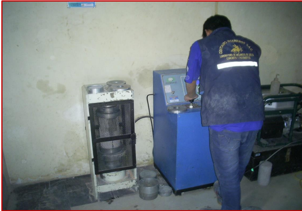
Fotografía N° 15: Personal calificado de laboratorio realizando el ensayo de resistencia a la compresión de probetas cilíndricas.
