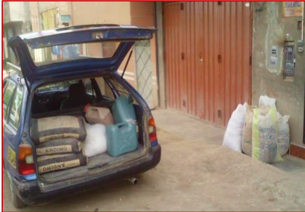
Fotografía N° 07: Adquisición de agregados e insumos para la elaboración de las probetas de concreto f'c 210 Kg/cm 2 .
