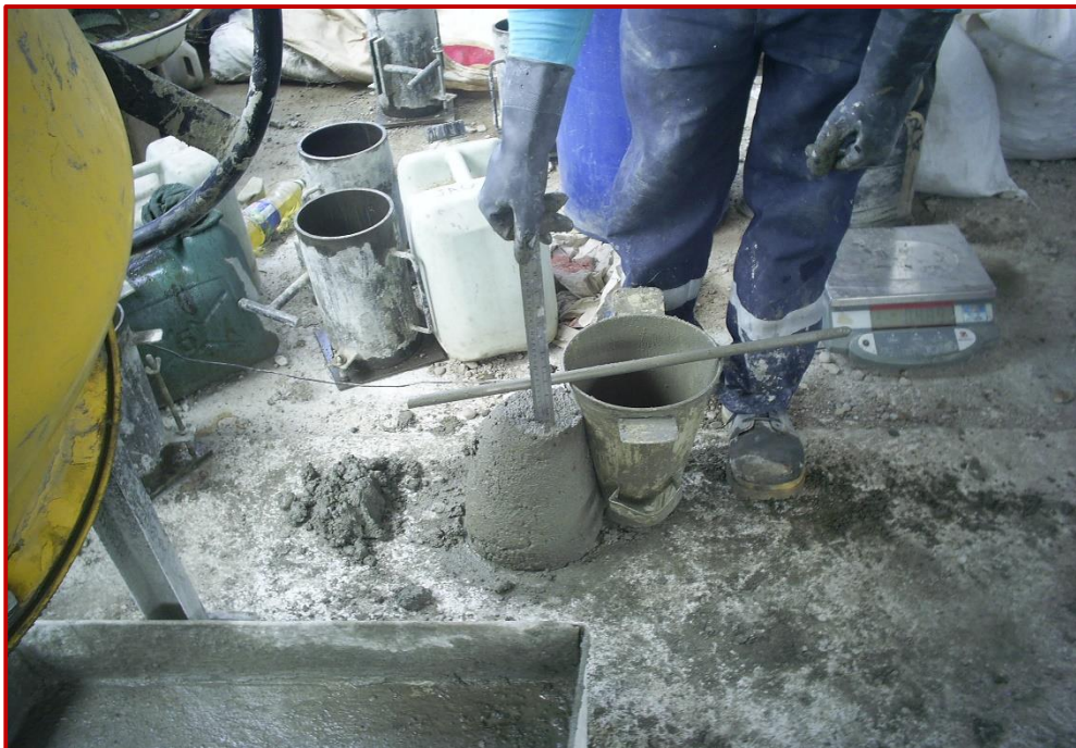
Fotografía N° 10: Realizando prueba de asentamiento para verificar consistencia del concreto, se tiene un asentamiento de 3.5"
