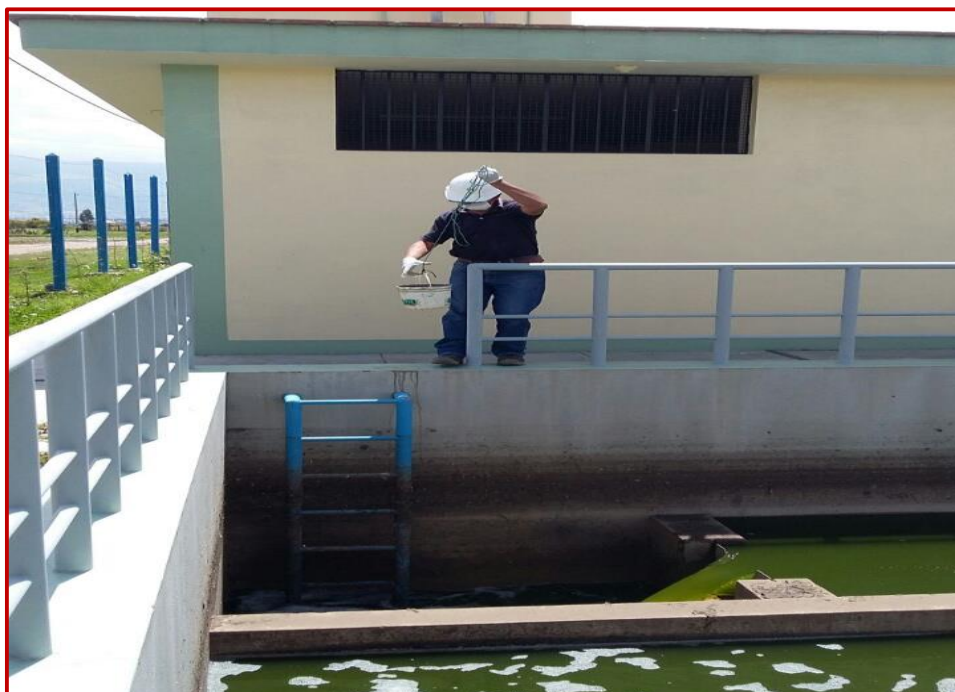
Fotografía N° 06: Extracción del agua tratada de la planta de tratamiento de aguas residuales de la provincia de Chupaca para la recolección de agua tratada.
