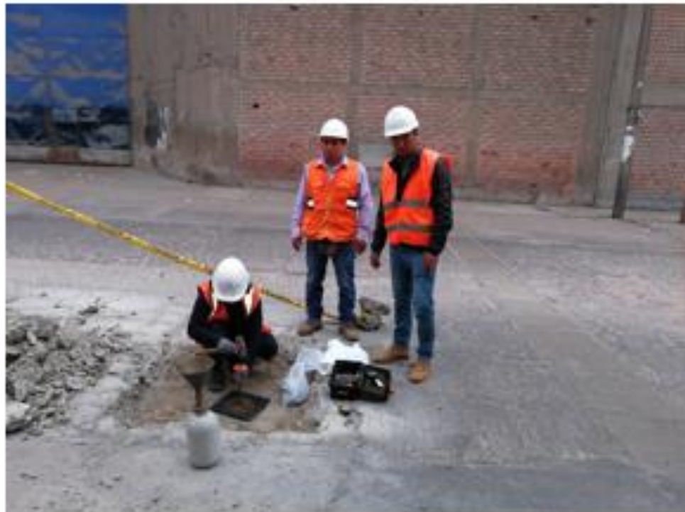
Imagen N° 23. Ensayo densidad de campo en la cuadra 2 de la calle Luis Galvani.
