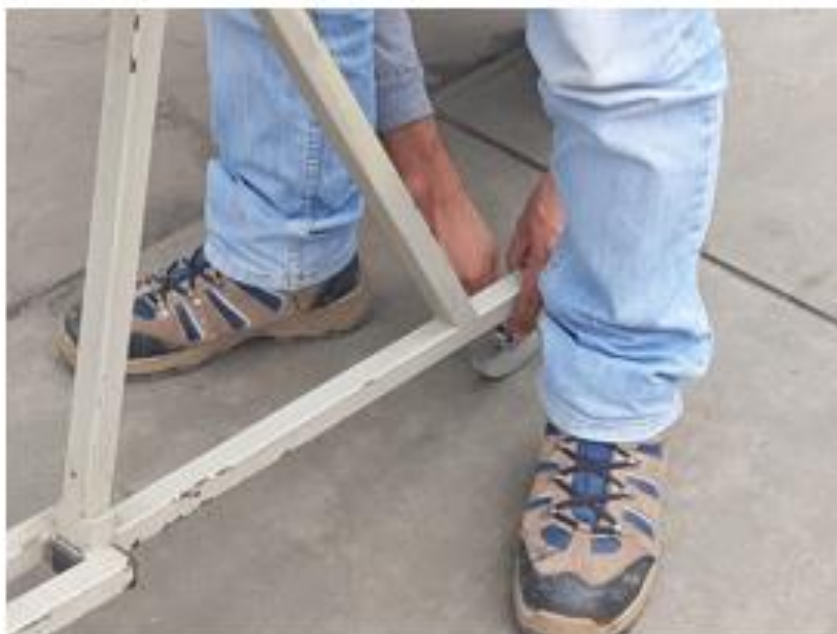
Imagen N° 30. Calibración del equipo "Rugosímetro de Merlín"
