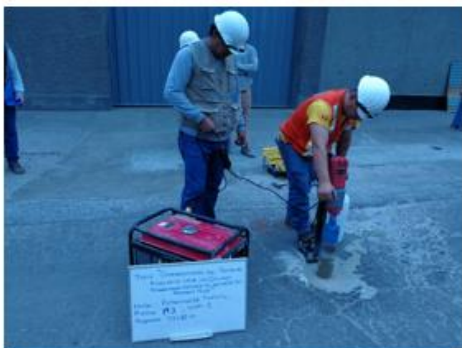
Imagen N° 13. Extracción del testigo (diamantina) M-3 cuadra 2 en la calle Luis Galvani.
