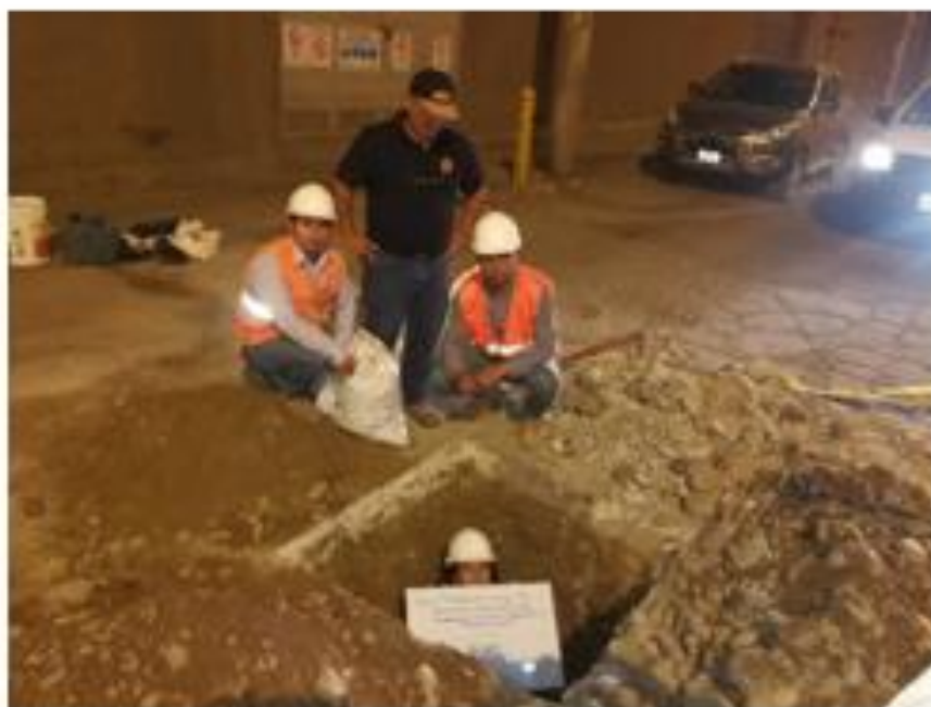
Imagen N° 20. Extracción de muestras de la Calicata C-1.
