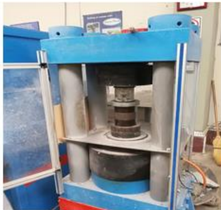
Imagen N° 16. Rotura del Testigos (diamantinas) de la calle Luis Galvani en el laboratorio de la UNI.
