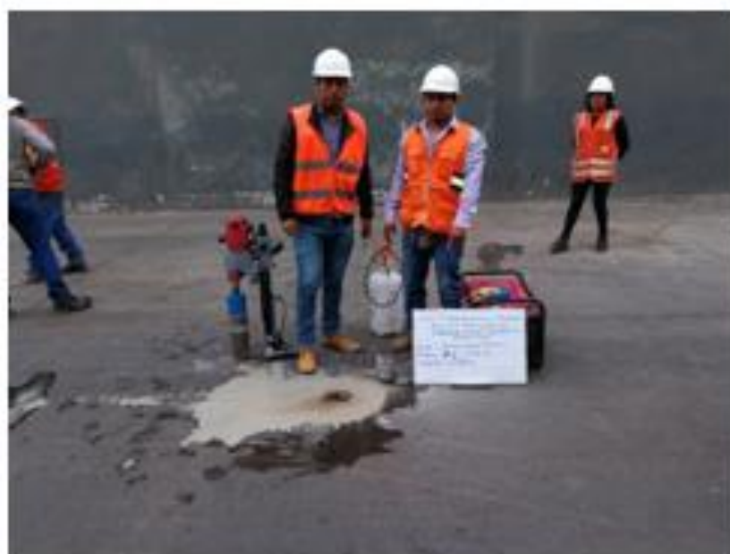
Imagen N° 12. Extracción del testigo (diamantina) M-2 cuadra 1 en la calle Luis Galvani.
