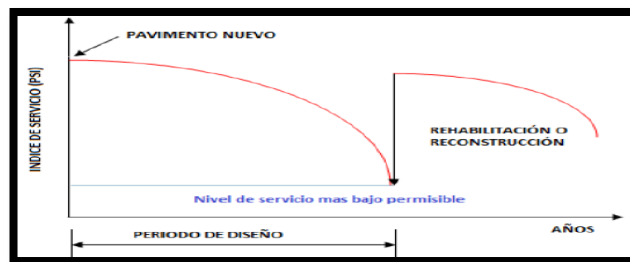
Figura 7. Variación del índice de serviciabilidad de un pavimento por efecto de las cargas en relación al tiempo
