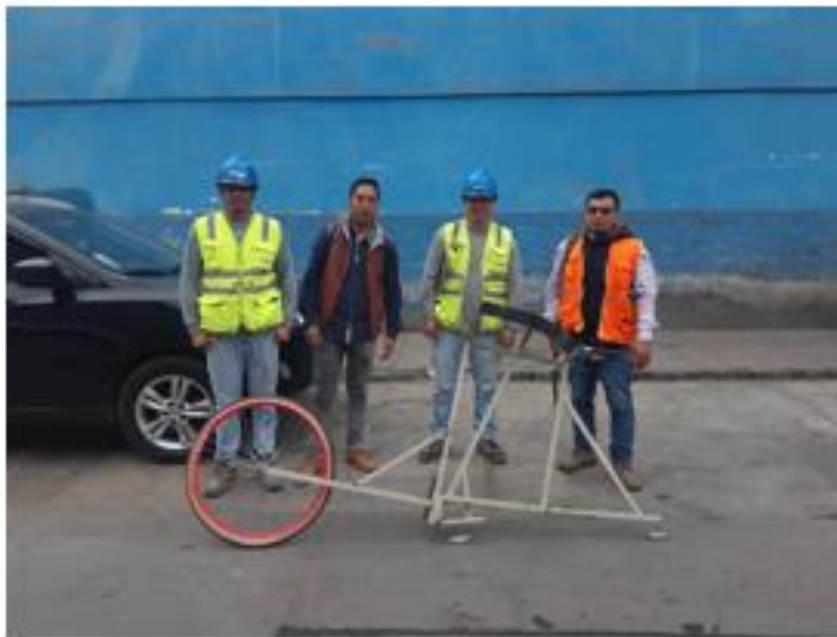
Imagen N° 29. Equipo del Rugosímetro de Merlín.
