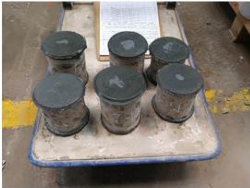
Imagen N° 15. Testigos (diamantinas) para la rotura en el laboratorio de la UNI de la calle Luis Galvani.
