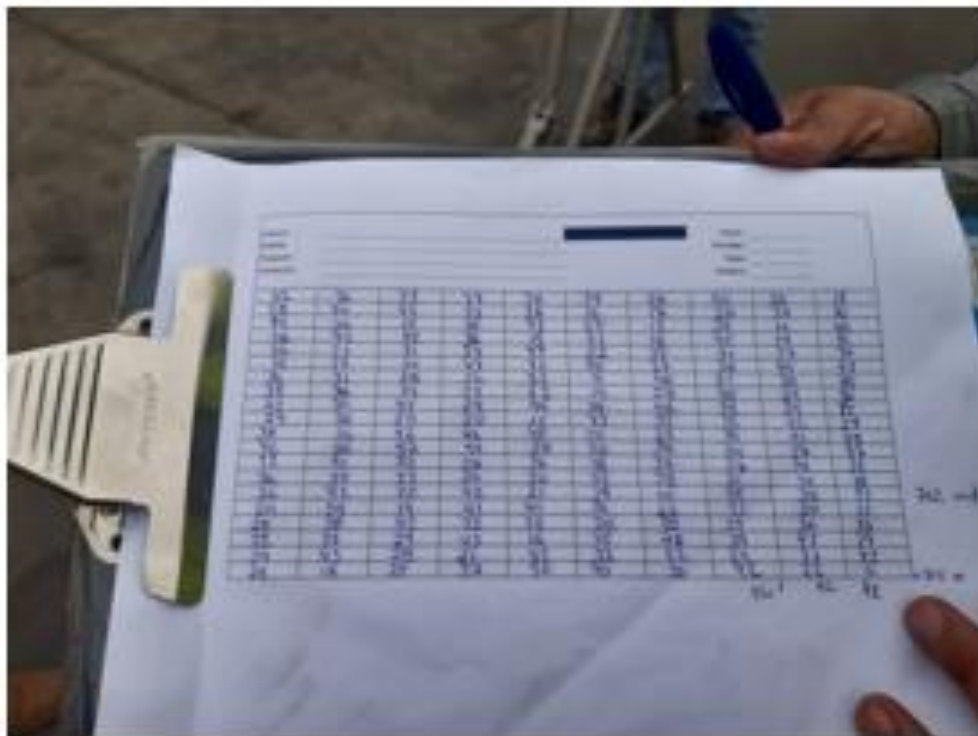
Imagen N° 32. Datos de campo del Rugosímetro de Merlín.
