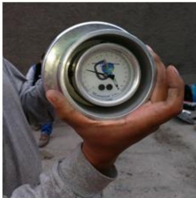
Imagen N° 24. Ensayo contenido de humedad con el medidor de humedad (Speedy) en la cuadra 2 de la calle Luis Galvani.
