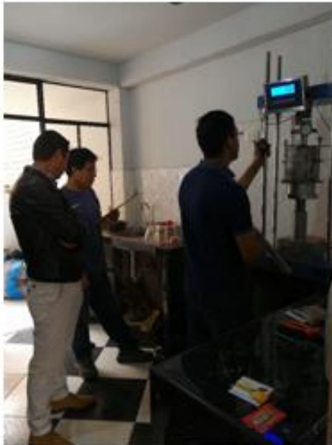
Imagen N° 28. Ensayo de CBR.
