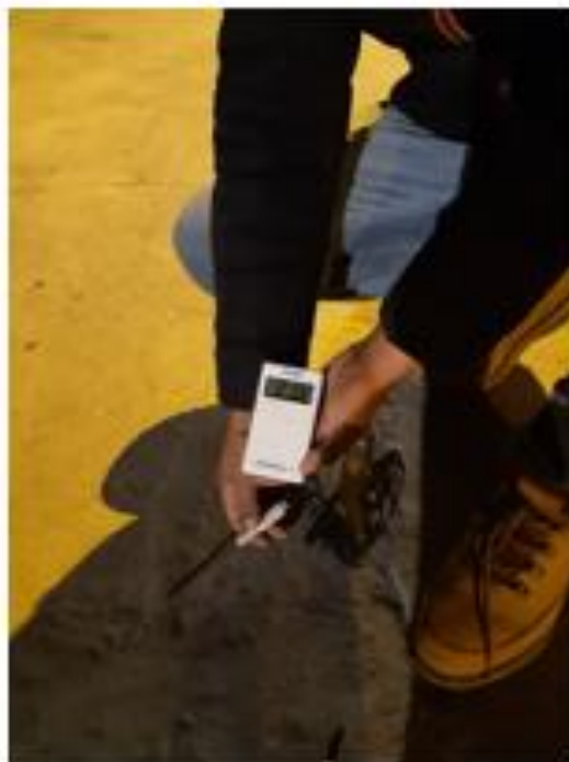
Imagen N° 38. Toma de la temperatura de la losa de concreto parte superior (noche).
