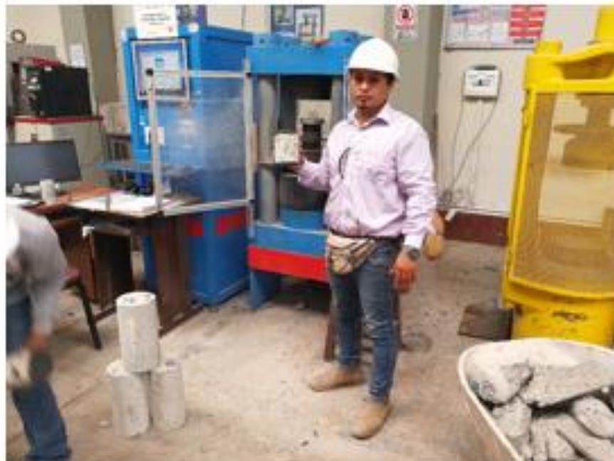
Imagen N° 18. Rotura del Testigos (diamantinas) de la calle Luis Galvani en el laboratorio de la UNI.
