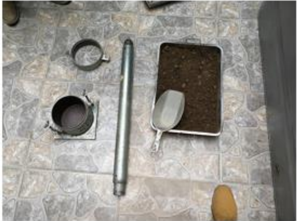
Imagen N° 27. Equipo para el ensayo de proctor modificado.
