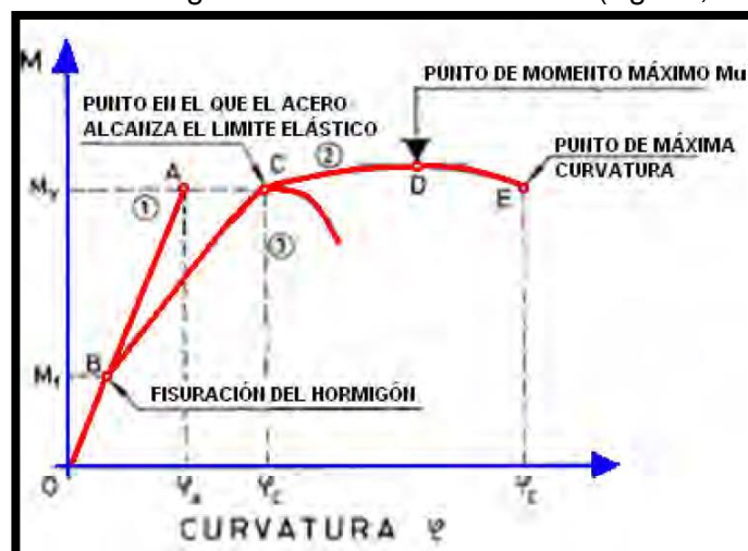
Figura N°11: Diagrama momento – curvatura (Aguiar, 2003)
