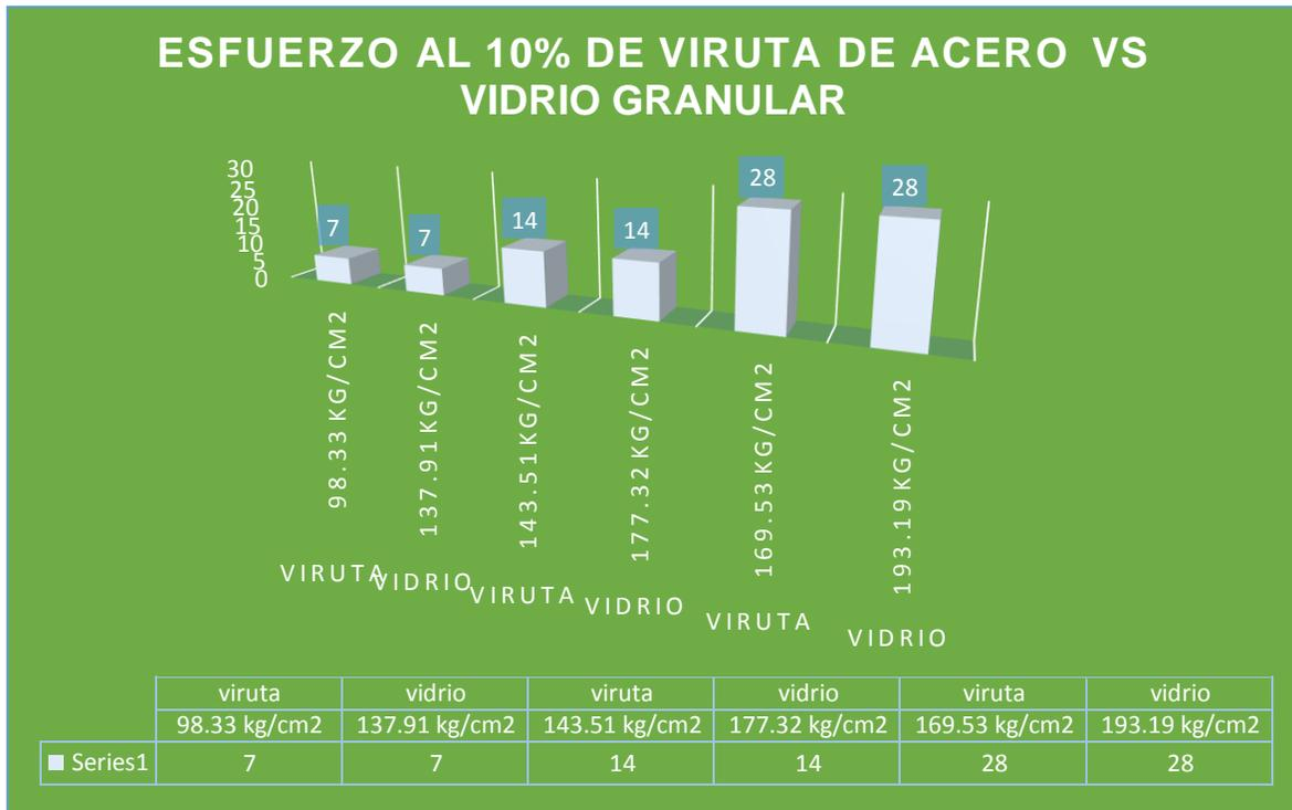
El f'c desarrollado a los 7 días por el concreto con vidrio granular incorporadas en 10% es de 137.91 kg/cm<sup>2</sup>, y respecto a la resistencia alcanzada por el concreto con viruta de acero incorporada en 10% es 98.33 kg/cm<sup>2</sup>. disminuyendo la resistencia a la compresión en 39.58 kg/cm<sup>2</sup>
