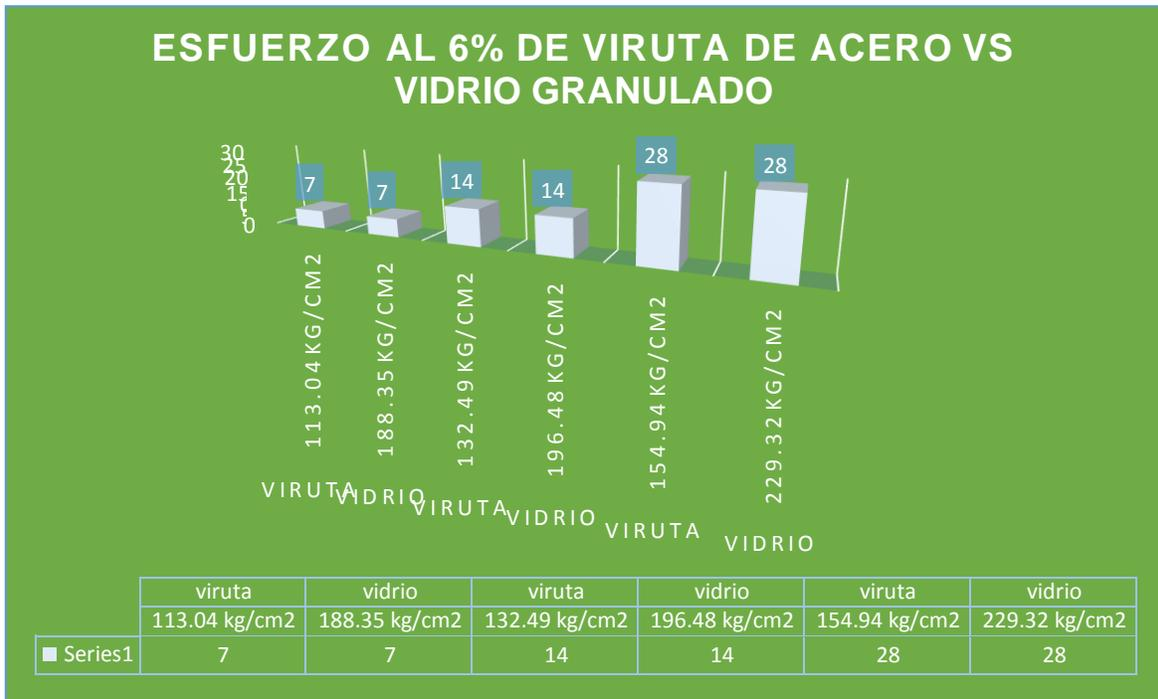
“El f’c desarrollado a los 7 días por el concreto con vidrio granulado incorporadas en 6% es de 188.35 kg/cm<sup>2</sup>, y respecto a la resistencia alcanzada por el concreto con viruta de acero incorporada en 6% es 113.04 kg/cm<sup>2</sup>. disminuyendo la resistencia a la compresión en 75.31 kg/cm<sup>2</sup>”
