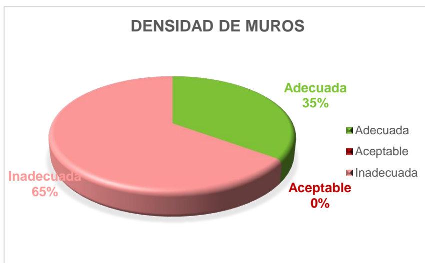
Figura 4.13 - Resultados de densidad en muros
