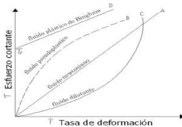
figura 2.17: Típica relación entre el esfuerzo cortante ( \tau ) y la tasa de deformación ( \dot{\gamma} ) para fluidos no - Newtonianos (Castillo 2006).
