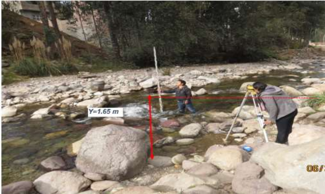
Imagen 6. 2: Tirante máximo de 1.65 m aguas arriba del río shullcas el cual da por tirante final ( y=1.81 m) por la sedimentación en el torrente y el eje central del río.
