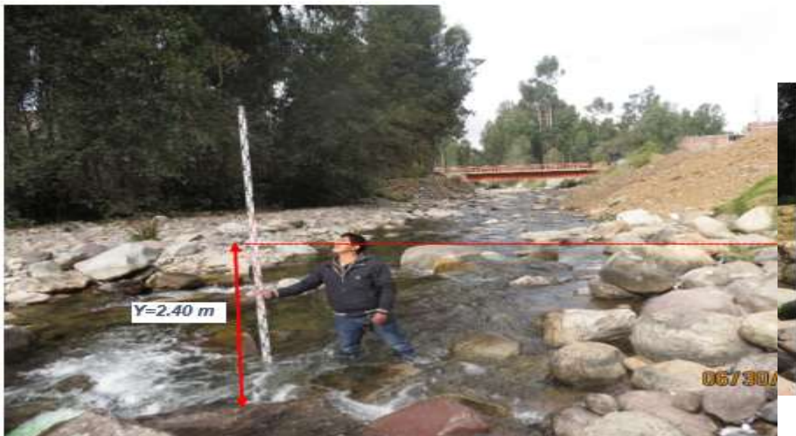
Imagen 6.1: Tirante máximo de 2.40 m aguas arriba del río shullcas el cual da por tirante final ( y=2.30m ) por la sedimentación en el torrente y el eje central del río.
