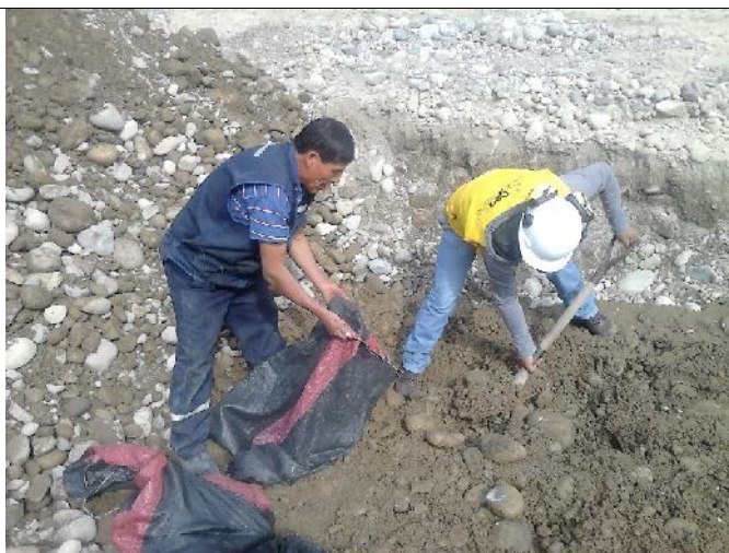
Foto 12: toma de muestra de suelo para el ensayo de mecánica e suelos en Rio Achamayo.
