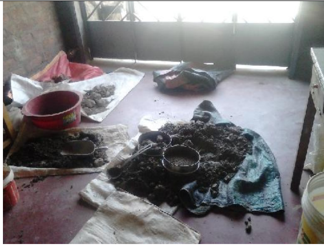
Foto 17: Preparación de muestra para los ensayos de mecánica de suelos
