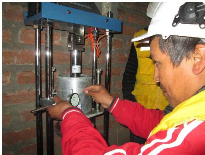
Foto 18: Ensayo de CBR para suelos
