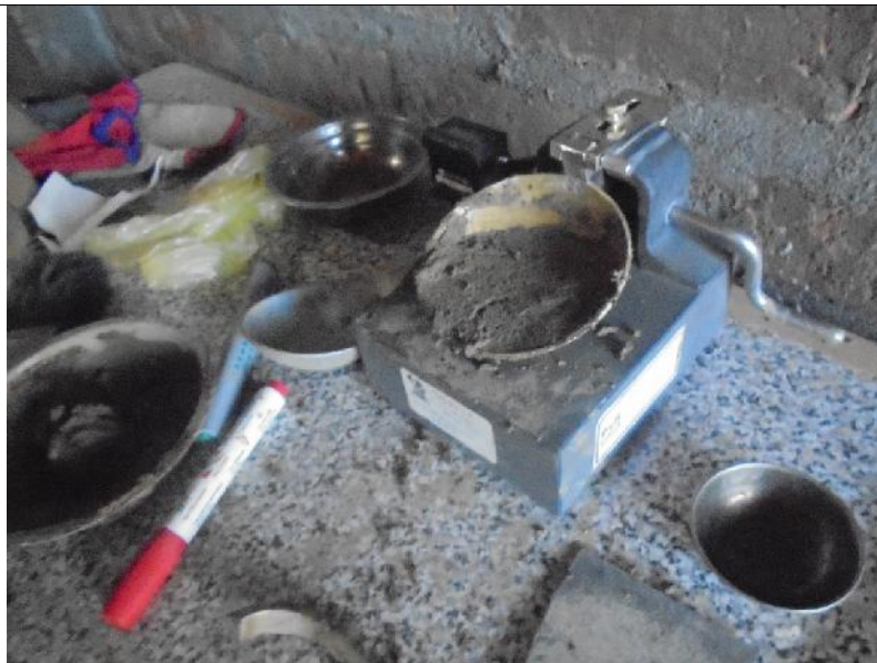
Foto 22: Ensayo de limite liquido con la copa de casagrande
