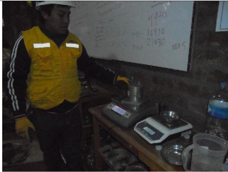
Foto 21: Ensayo para determinar gravedad especifica del suelo
