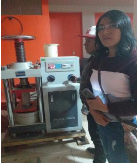
Fotografía 9. Ensayo de resistencia a la compresión del concreto patrón a los 14 días.
