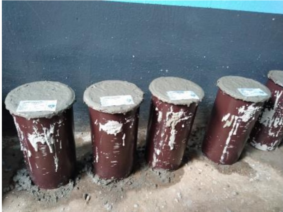
Fotografía 3. Muestras del concreto con adición de fibra de acero para el ensayo de resistencia a la compresión.
