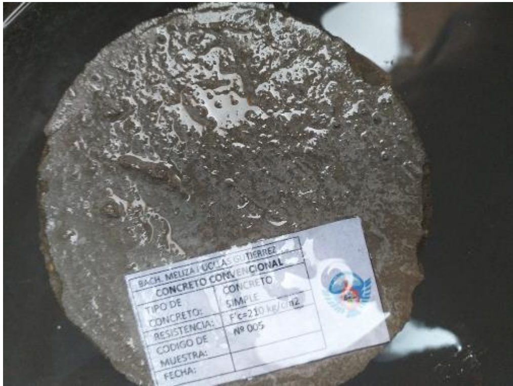
Fotografía 7. Curado del concreto convencional para el ensayo de compresión simple.
