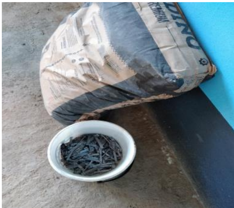
Fotografía 2. Cemento Andino Portland Tipo I y fibras de acero usados en las muestras de concreto.
