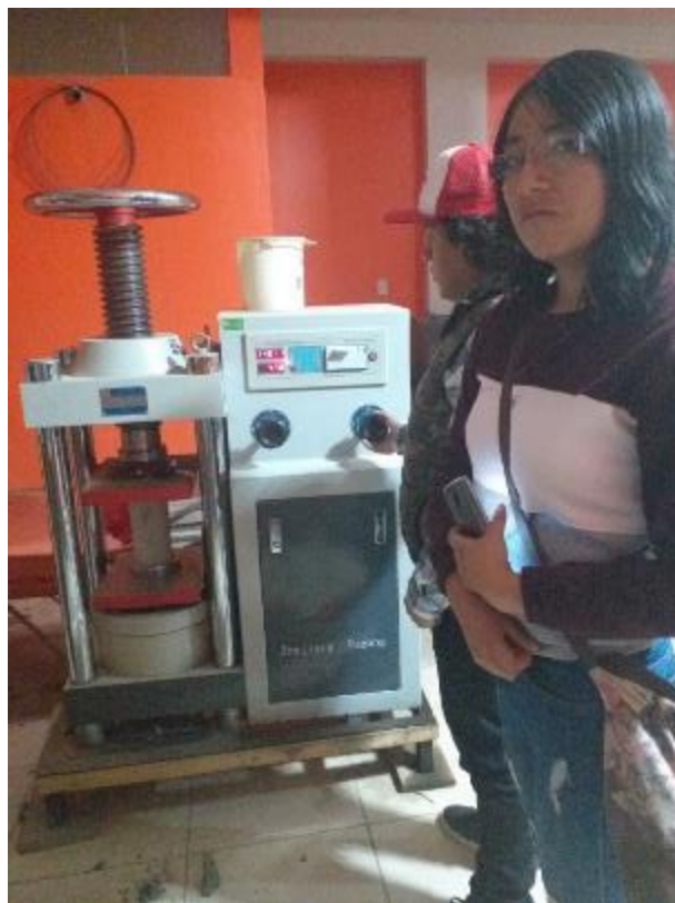
Fotografía 10. Ensayo de resistencia a la compresión del concreto con adición de fibra de acero a los 14 días.
