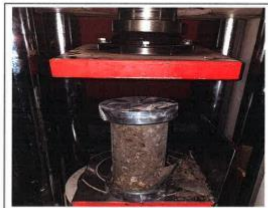
FOTO. 10.- ENSAYO DE ROTURA DE PROBETA - "INFLUENCIA DE LA ADICION DE FIBRA DE ACERO EN LAS PROPIEDADES FISICAS Y MECANICAS DEL CONCRETO"
