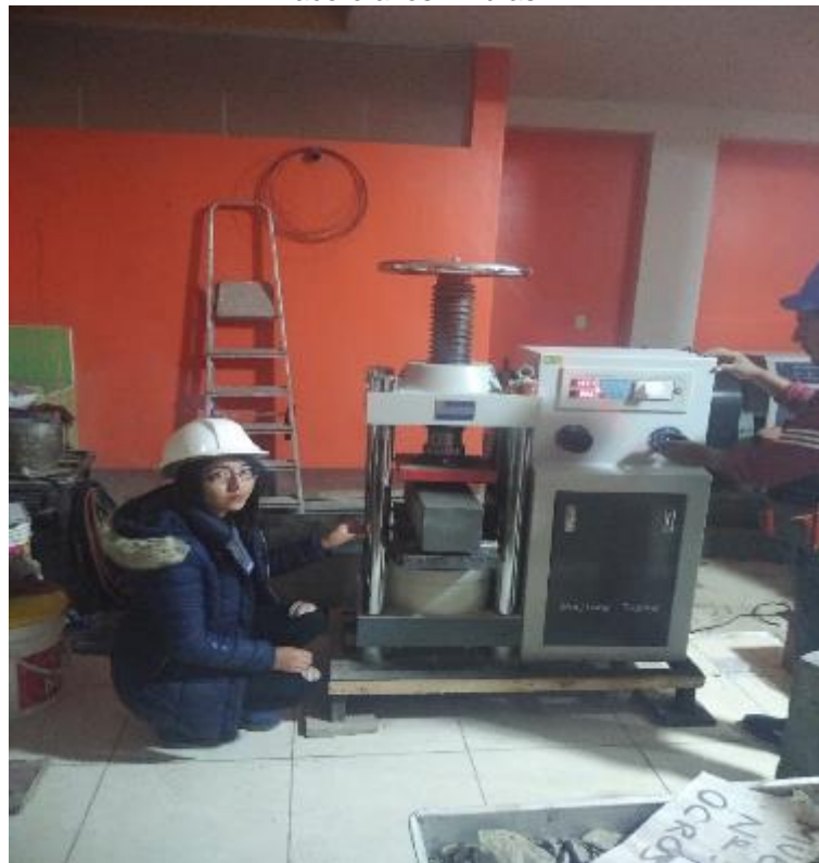
Fotografía 16. Ensayo de resistencia a la flexión del concreto patrón a los 28 días.
