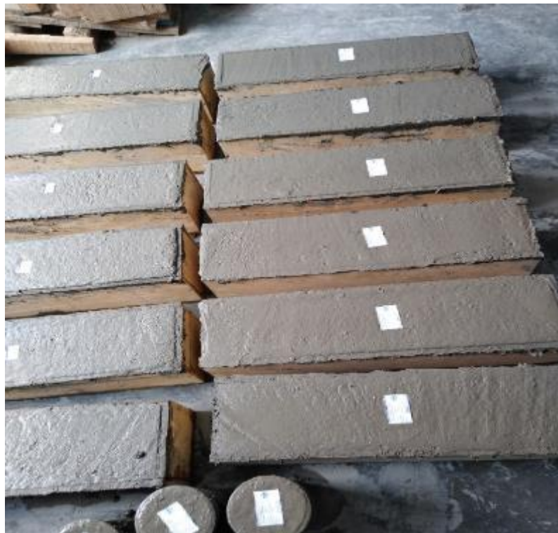
Fotografía 6. Muestras con adición de fibra de acero para el ensayo de flexión de viga simple.
