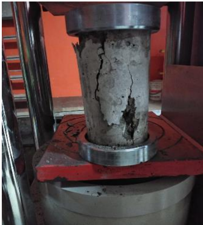
Fotografía 18. Falla del concreto en el ensayo a la compresión simple.
