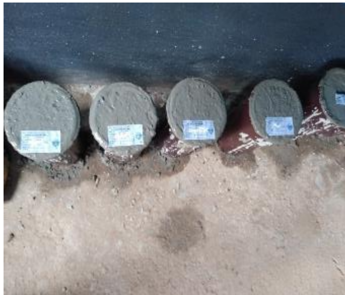
Fotografía 4. Muestras del concreto patrón para el ensayo de compresión simple.
