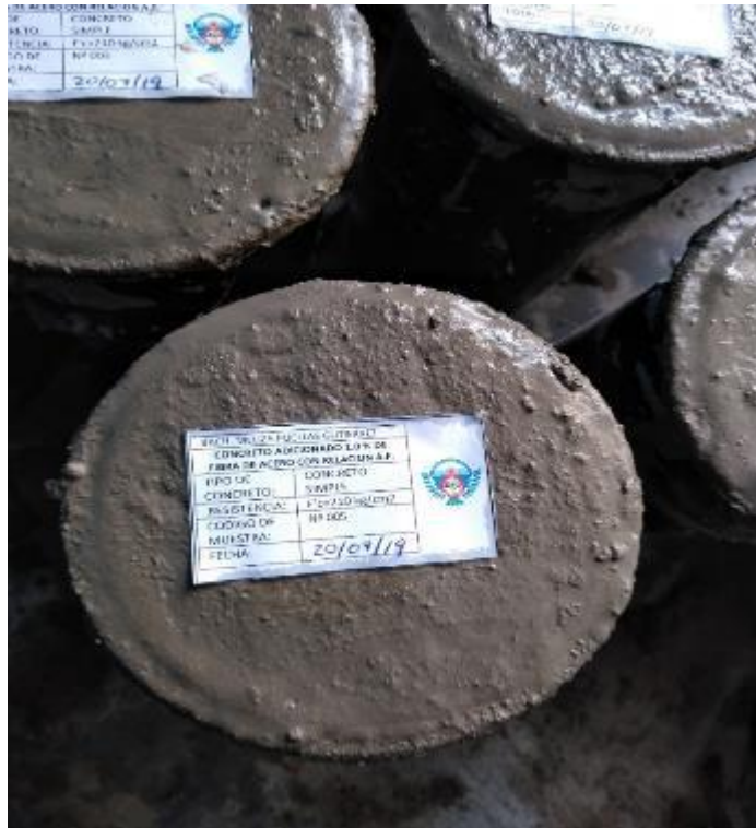
Fotografía 5. Muestra con adición de 1 % de fibra de acero con relación al A.F.
