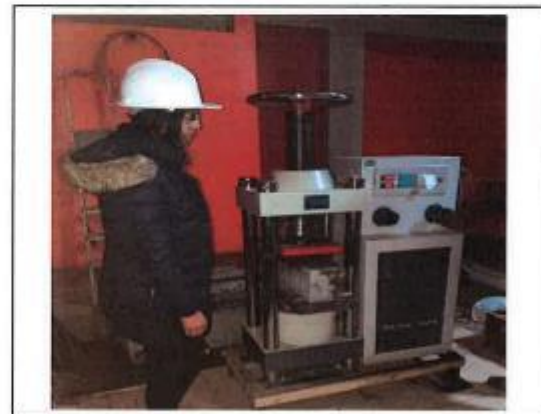
FOTO. 04.- ENSAYO DE ROTURA DE PROBETA - "INFLUENCIA DE LA ADICION DE FIBRA DE ACERO EN LAS PROPIEDADES FISICAS Y MECANICAS DEL CONCRETO"
