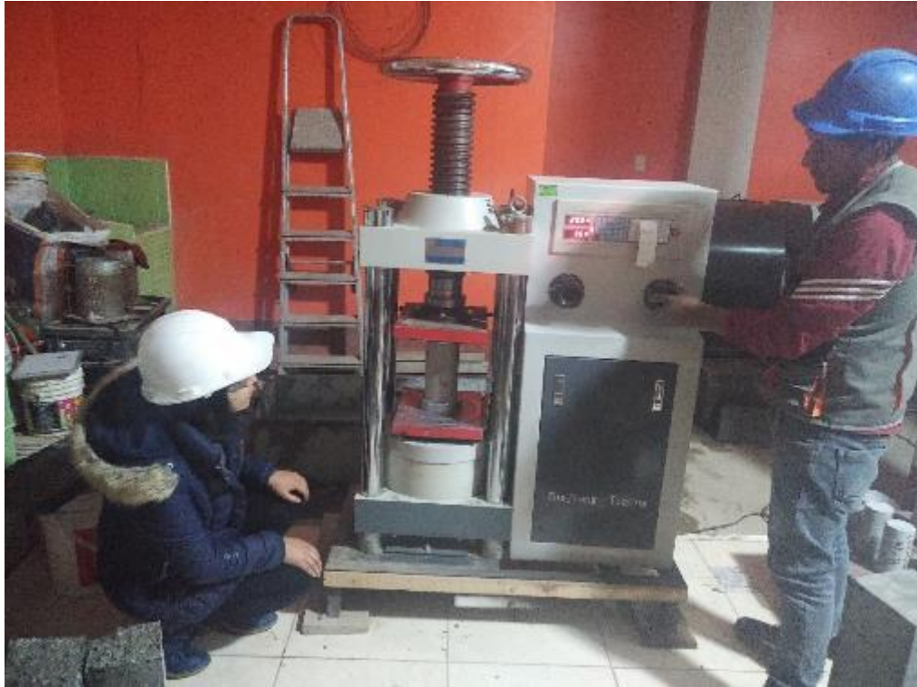
Fotografía 13. Ensayo de resistencia a la compresión del concreto patrón a los 28 días.
