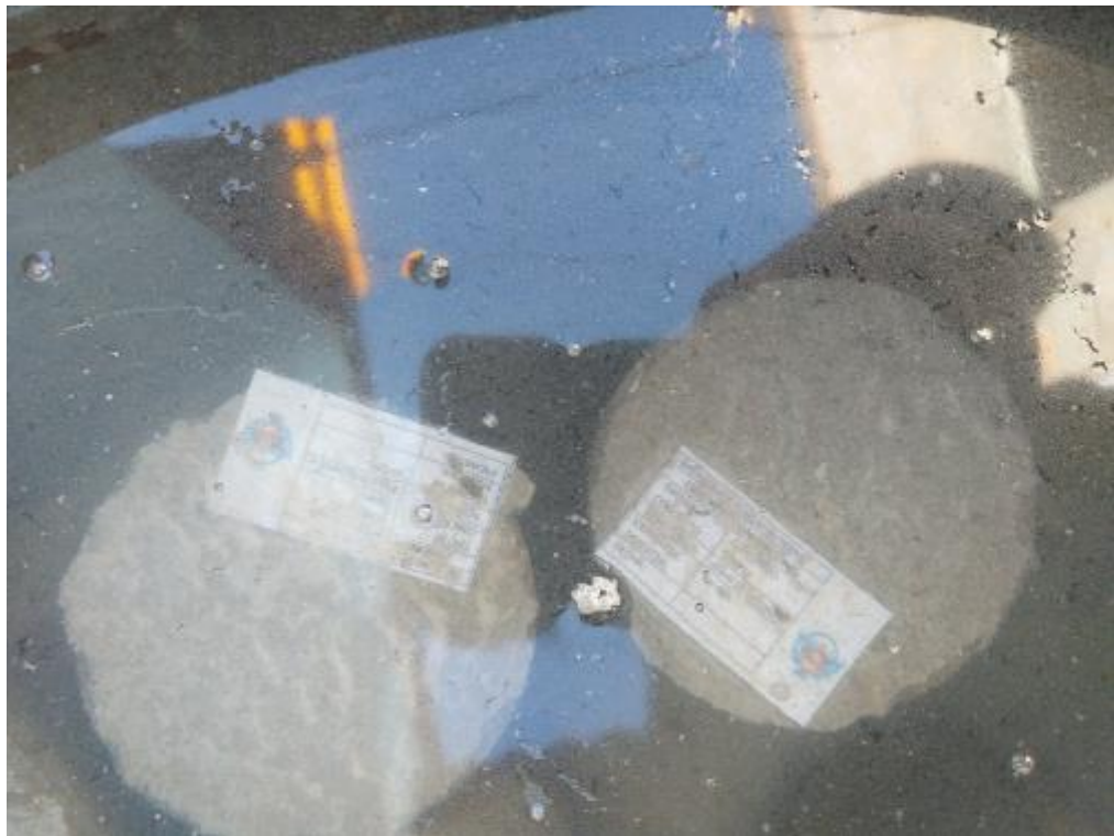
Fotografía 8. Curado del concreto con adición de fibra de acero para el ensayo de compresión simple.
