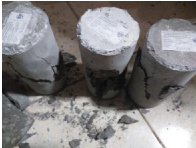
Fotografía 22. Muestras de concreto con adición de fibra de acero roturadas a la compresión simple a los 28 días.
