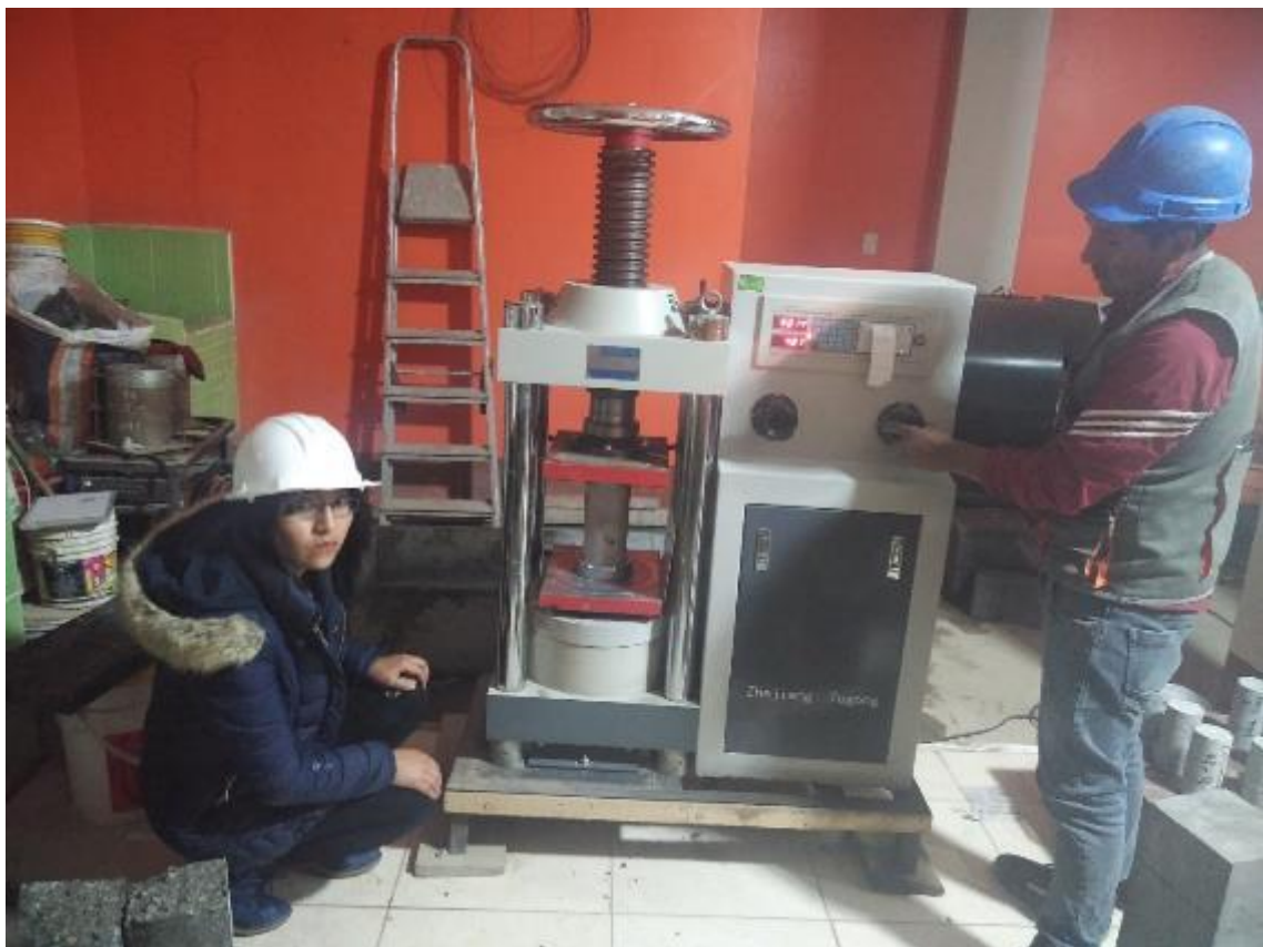
Fotografía 14. Ensayo de resistencia a la compresión del concreto con adición de fibra de acero a los 28 días.
