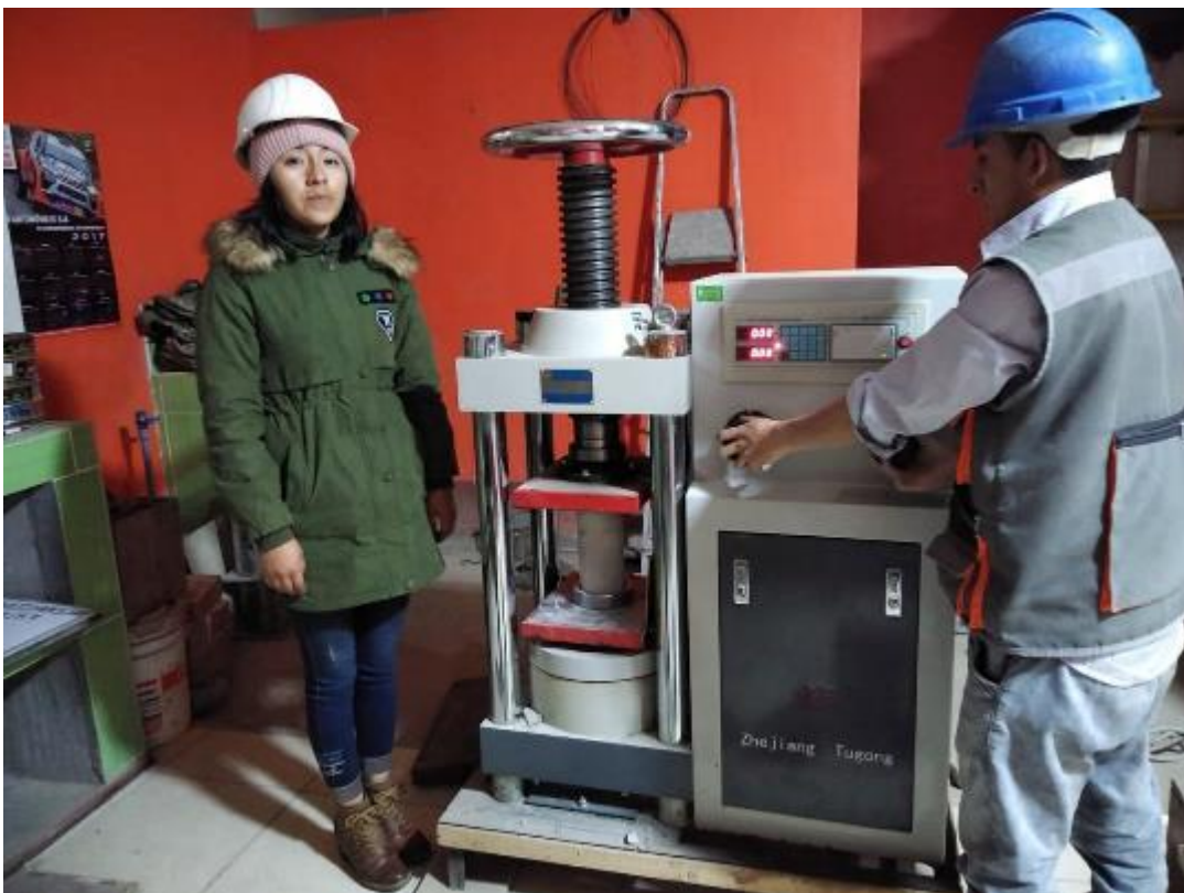
Fotografía 12. Ensayo de resistencia a la compresión del concreto con adición de fibra de acero a los 21 días.
