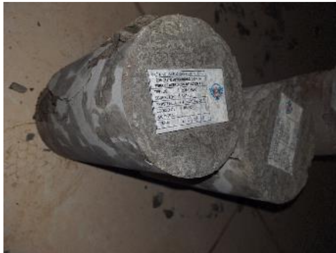
Fotografía 20. Muestras de concreto con adición de fibra de acero roturadas a la compresión simple a los 14 días.
