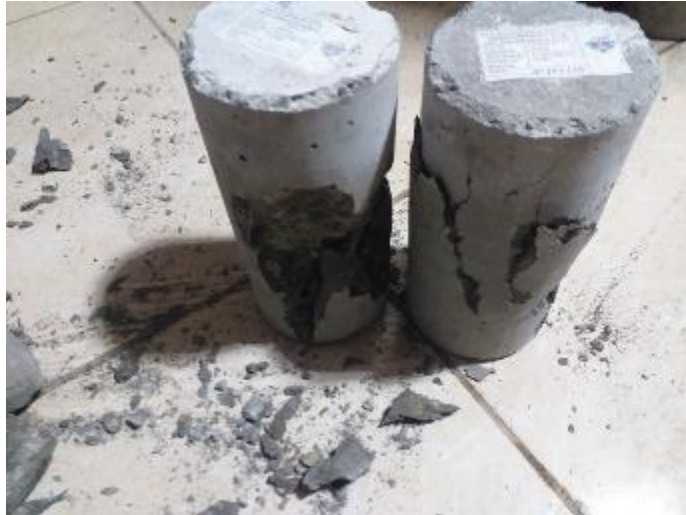
Fotografía 21. Muestras de concreto con adición de fibra de acero roturadas a la compresión simple a los 21 días.
