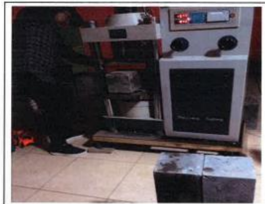
FOTO. 06.- ENSAYO DE ROTURA DE PROBETA - "INFLUENCIA DE LA ADICION DE FIBRA DE ACERO EN LAS PROPIEDADES FISICAS Y MECANICAS DEL CONCRETO"
