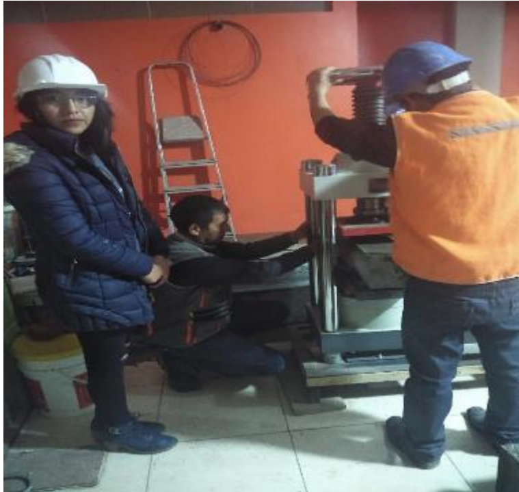
Fotografía 17. Ensayo de resistencia a la flexión del concreto con adición de fibra de acero a los 28 días.
