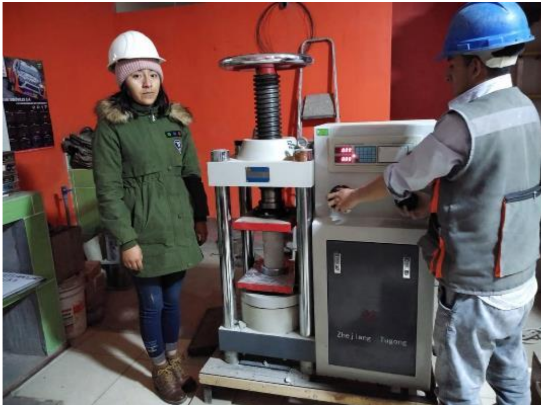
Fotografía 11. Ensayo de resistencia a la compresión del concreto patrón a los 21 días.
