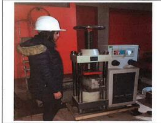
FOTO. 01.- ENSAYO DE ROTURA DE PROBETA – "INFLUENCIA DE LA ADICION DE FIBRA DE ACERO EN LAS PROPIEDADES FISICAS Y MECANICAS DEL CONCRETO"
