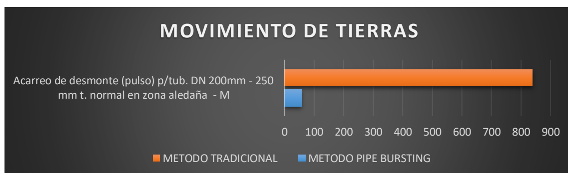
Gráfico N° 20. Acarreo de desmonte (pulso) p/tub. DN 200mm - 250 mm t. normal en zona aledaña
