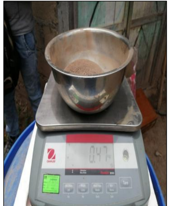
Fotografía 29. Muestra 01 (peso tara + peso suelo seco) - 470 gramos
