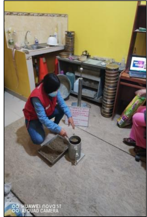
Fotografía 16. Colocado de muestra en molde
