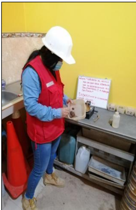
Fotografía 11. Límite Líquido de material pasante del tamiz N°40; en un recipiente y mezclase 15 – 20 ml de agua destilada.
