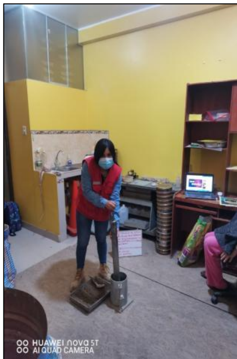
Fotografía 17. Compactación del material en el molde
