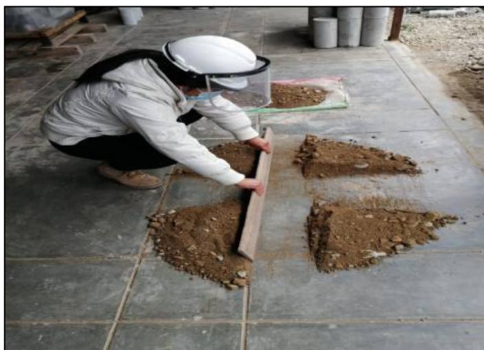
Fotografía 4. MTC E 105. Mediante un listón de madera se divide el cono en cuatro partes
