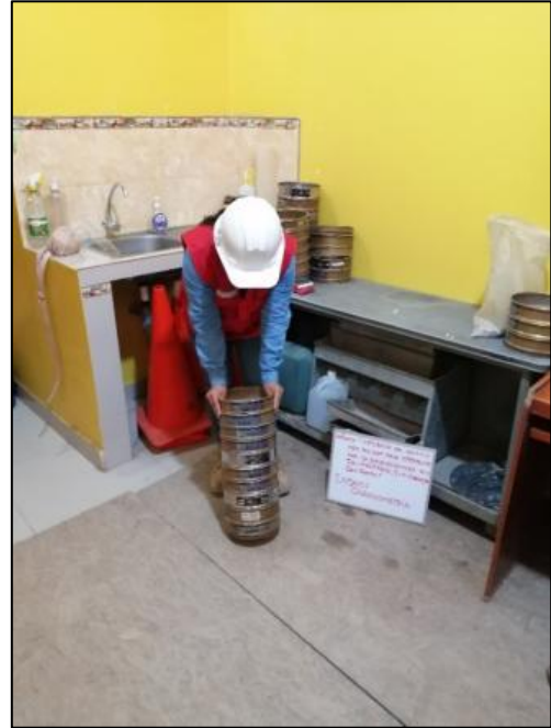
Fotografía 6. Tamizado del material retenido N°04
