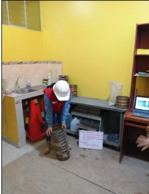
Fotografía 5. Tamizado de material
