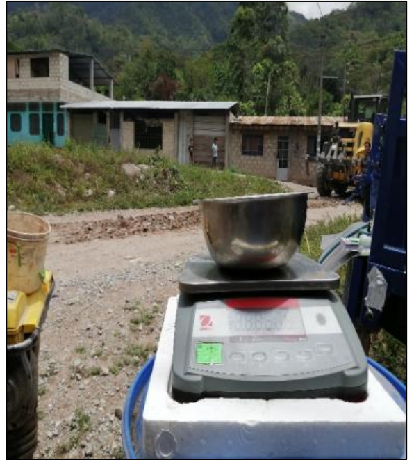
Fotografía 27. Muestra 01 (Peso tara + peso suelo Natural)- 500 gr
