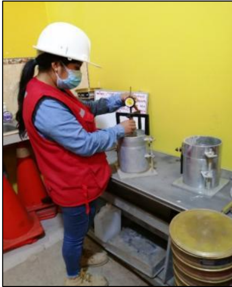
Fotografía 19. Se coloca el trípode con un extensómetro y se toma una lectura inicial y se tomara cada 24 horas.
