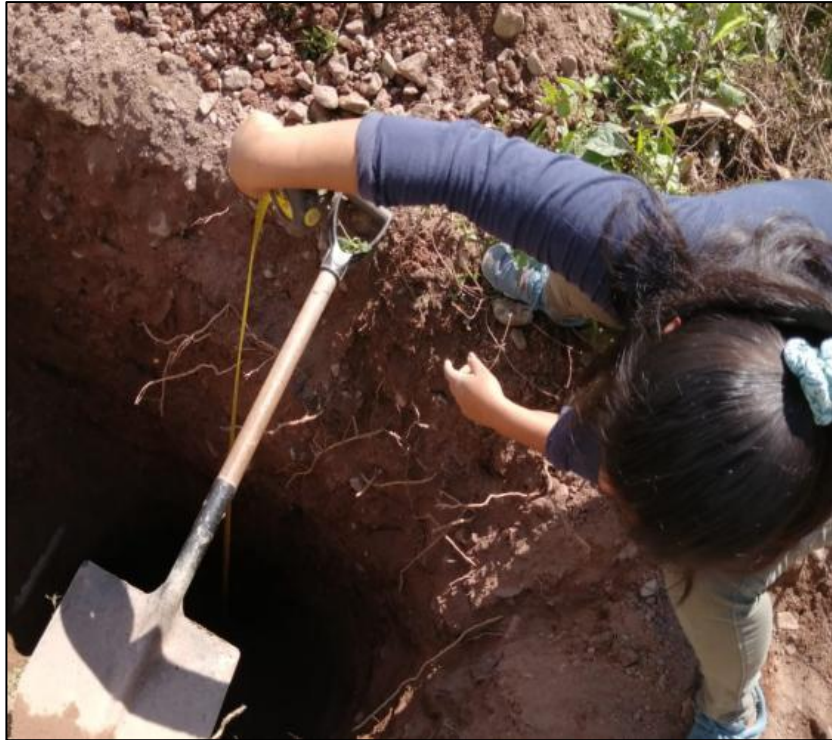
Fotografía 1. Muestra de calicata en suelo natural altura de la calicata ( H=1.50m )
