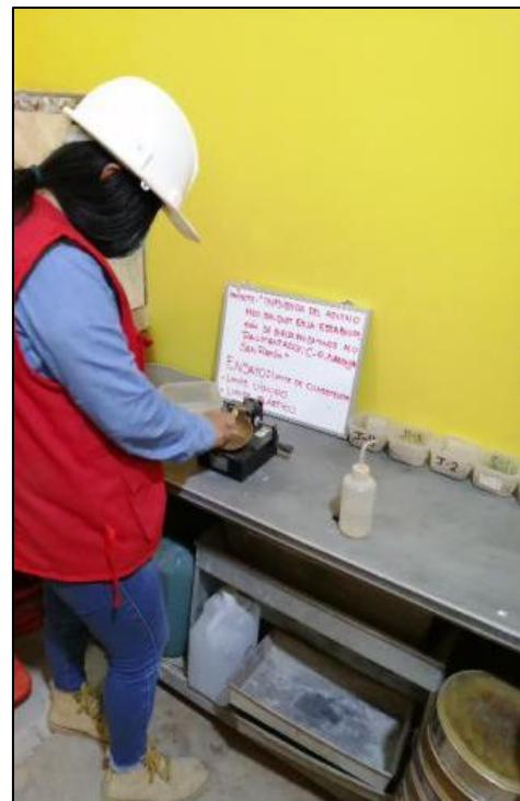
Fotografía 12. Límite Líquido - uso del acanalador en la copa Casagrande.
