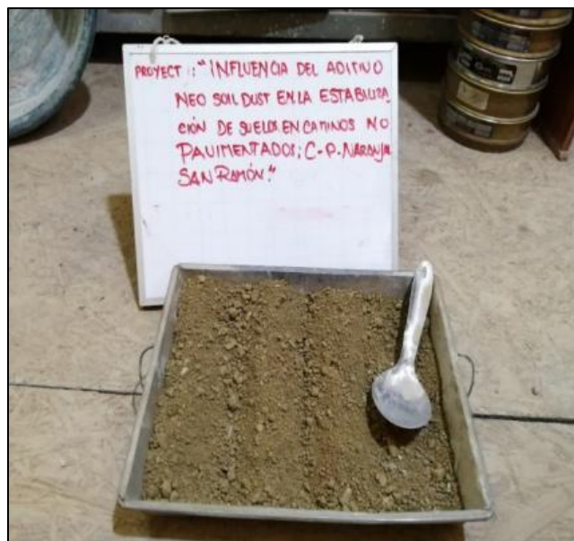
Fotografía 7. Material pasante del tamizado N°4.
