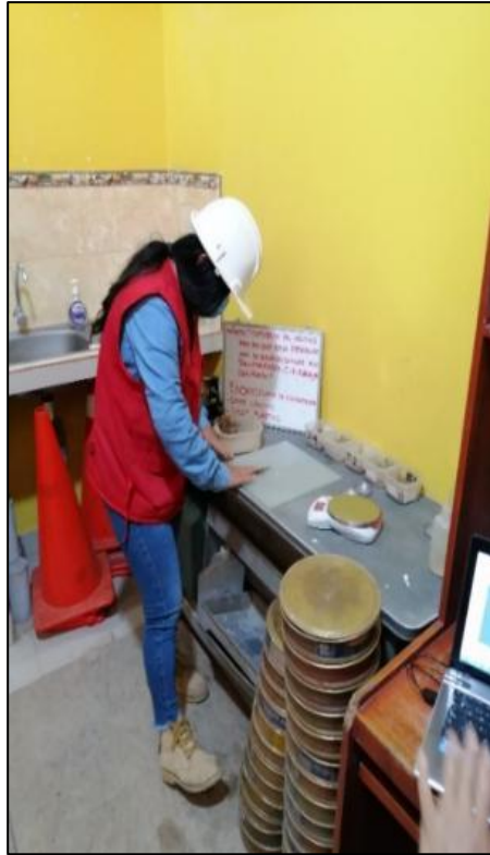
Fotografía 13. Limite plástico; mezclado y rodamiento de la muestra para obtener el Límite Plástico
