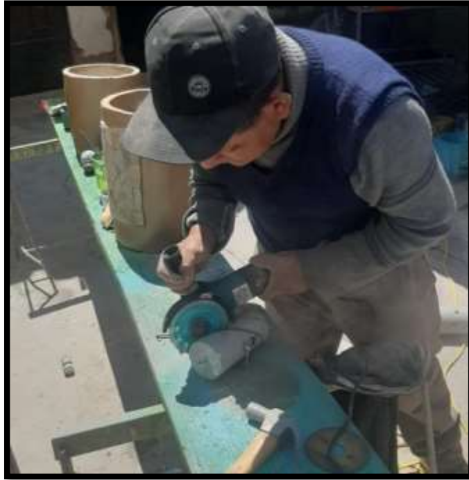
Figura: Se debe tener especial cuidado en el corte de las probetas ya que una mala posición del ángulo de corte arruinaría las probetas.
