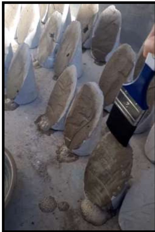
Figura: Para la aplicación del ácido clorhídrico se utilizaron brochas y mascarilla debido a que la aplicación del ácido sulfúrico produce irritación, la aplicación del ácido sulfúrico fue de 3 pasadas cada 15 minutos para después enjuagarlos con abundante agua.
