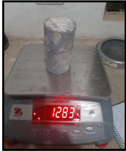
Figura: se toman las medidas y se pesa las probetas a ensayar por compresión.
