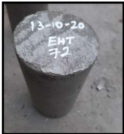
Figura: Después de desencontrar las probetas se procede a enumerar los especímenes.
