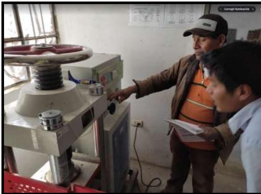
Figura: Se somete a compresión las probetas para calcular la resistencia por adherencia.
