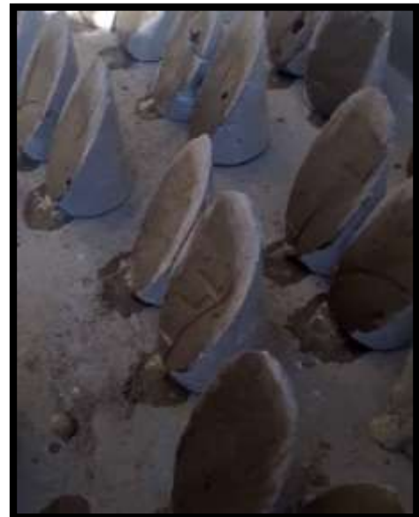
Figura: Después de los 28 días se retiran las probetas y se procede a cortar de acuerdo a las dimensiones especificadas en la norma con una hoja de sierra para concreto.
