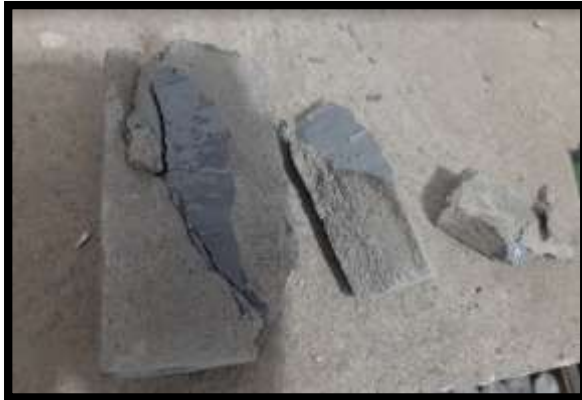
Figura: Tipos de falla en una mala aplicación de la resina epoxica ya que la resina no impregno en el total de la superficie de contacto.
