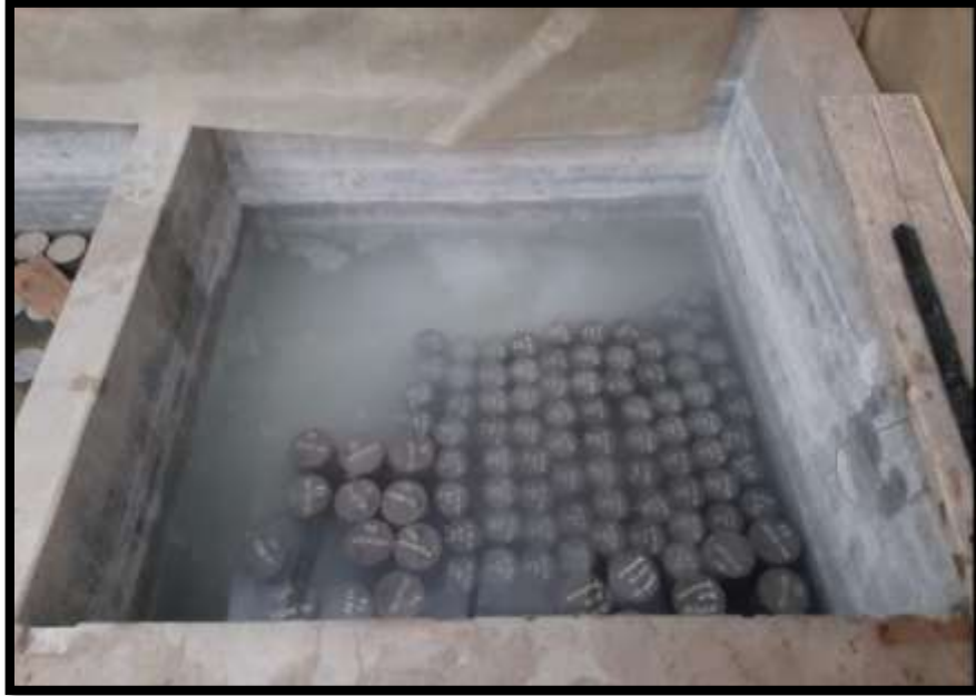
Figura: Inmediatamente se procede a curar por 28 días las probetas de concreto en un ambiente controlado y a una temperatura de 23°.
