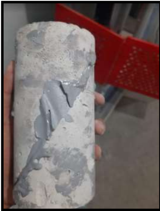
Figura: se toman las medidas y se pesa las probetas a ensayar por compresión.
