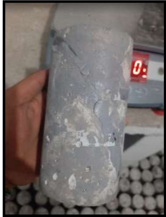
Figura: En casos de derramamiento de la resina se lima para que puedan contener las dimensiones especificadas.
