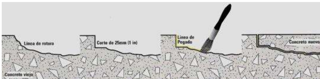
Figura 5: Procedimiento para el uso de Adhesivo Epóxico para unir concreto
