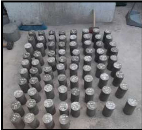
Figura: Después de desencontrar las probetas se procede a enumerar los especímenes.
