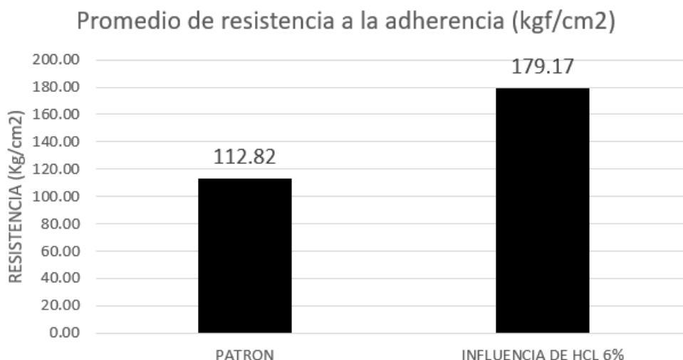
Figura 21: Histograma comparativo de la resistencia por adherencia promedio entre el grupo patrón y el grupo con influencia del HCl al 6%.
