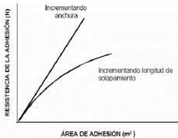
Figura 11: Comportamiento de la unión adhesiva en la resistencia de adhesión vs el área de adhesión.
