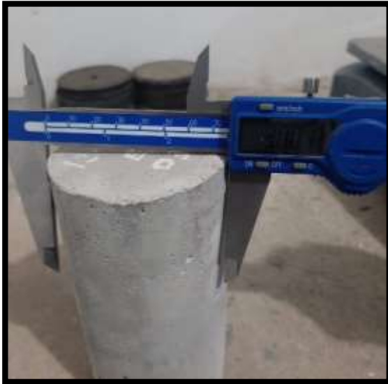
Figura: se toman las medidas y se pesa las probetas a ensayar por compresión.
