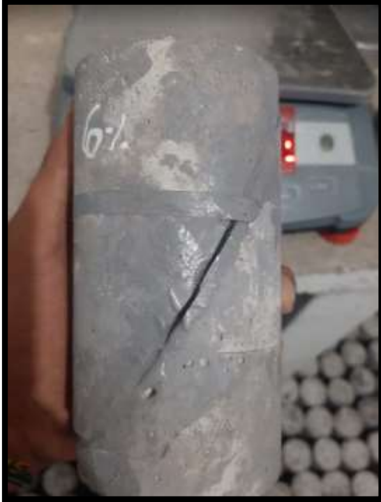
Figura: En casos de derramamiento de la resina se lima para que puedan contener las dimensiones especificadas.
