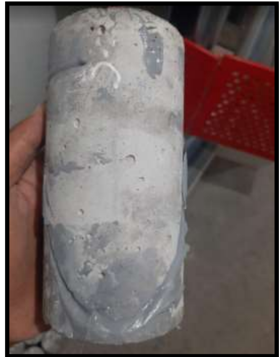
Figura: se toman las medidas y se pesa las probetas a ensayar por compresión.
