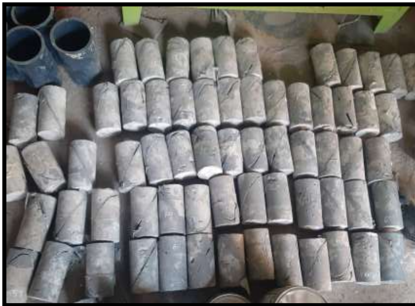
Figura: Después de 10 días de secado la resina epoxica se encuentra en su máximo punto de resistencia por adherencia.
