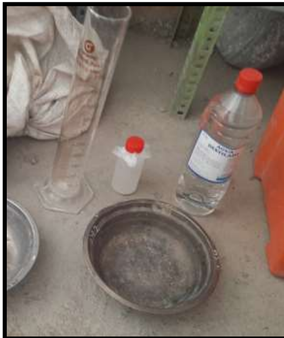
Figura: Una vez cortados las probetas de mortero se procede a aplicar el ácido clorhídrico en tres envases, cada uno de acuerdo a una concentración de 3%, 6% y 9%.
