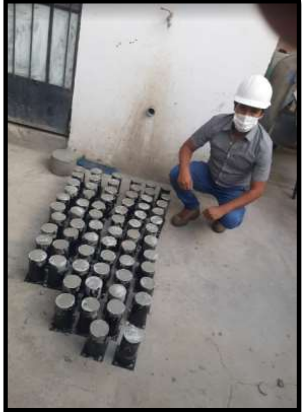
Figura: Después de 24 horas del vaciado del mortero, se procede a desencontrar las probetas.
