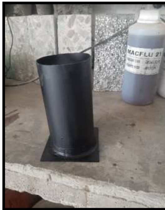
Figura: Briqueta hecho a base de acero de 0.9mm x 3" y una base de resina acrílica unido con silicona, la dimensión de la briqueta es de 3"x6".
