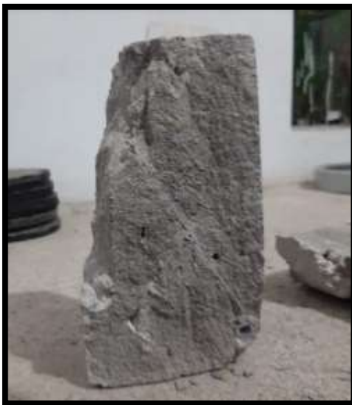
Figura: En la imagen se muestra una falla por compresión, indicador de que la resina fue bien aplicada y mejora la resistencia por adherencia.
