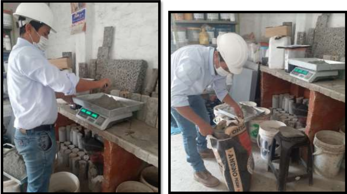
Figura: Medición de las proporciones para un mortero de relación a/c=65.
