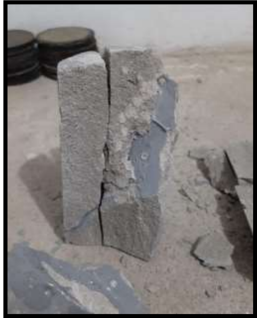
Figura: Tipos de falla en una mala aplicación de la resina epoxica ya que la resina no impregno en el total de la superficie de contacto.
