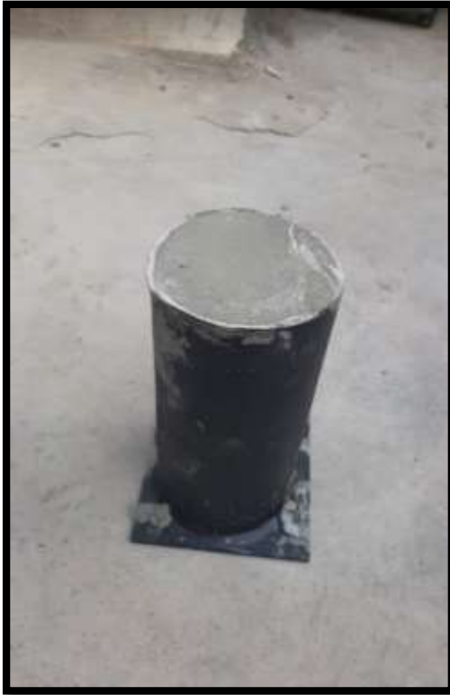
Figura: Después de 24 horas del vaciado del mortero, se procede a desencontrar las probetas.
