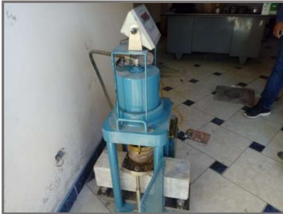
FOTO 12. Rotura de vigas
