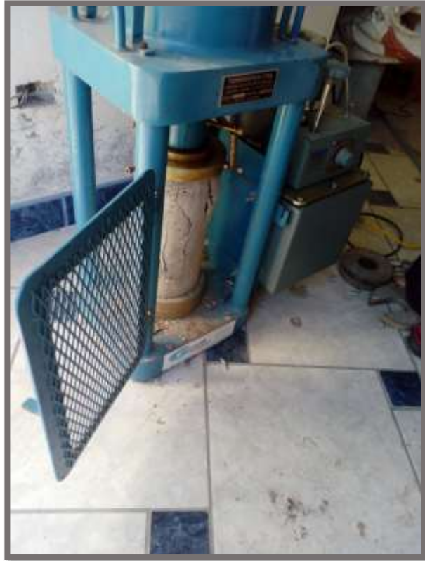
FOTO 9. Rotura de concreto a la compresión.
