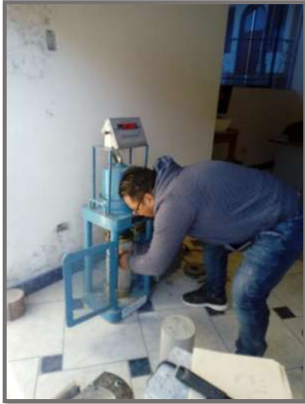
FOTO 7. Colocación de la probeta de concreto para su rotura.
