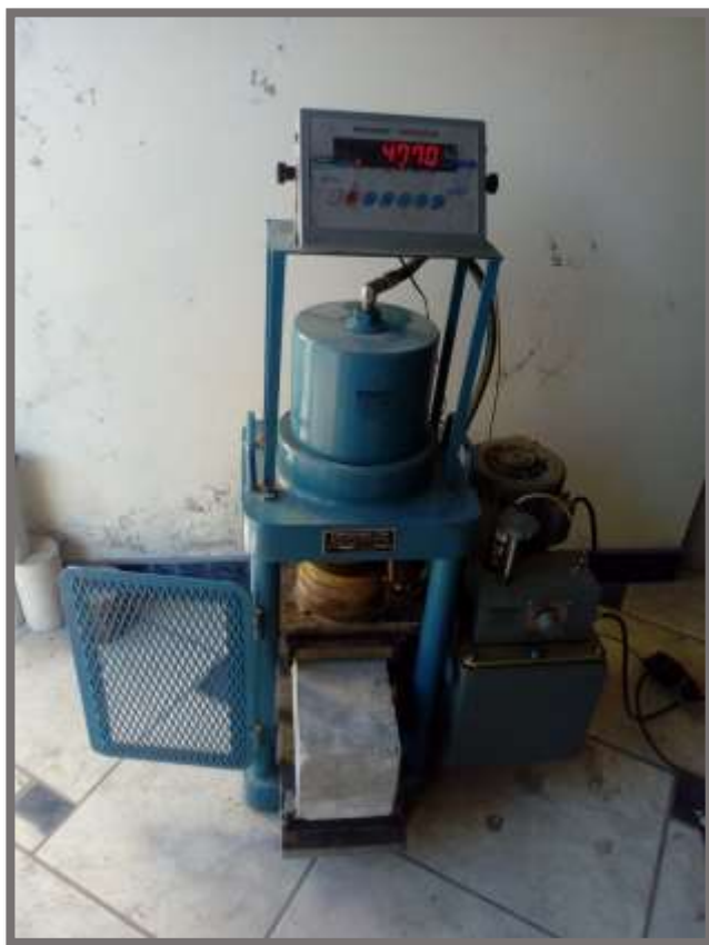
FOTO 13. Rotura de vigas
