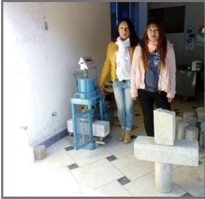
FOTO 15. Rotura de vigas
