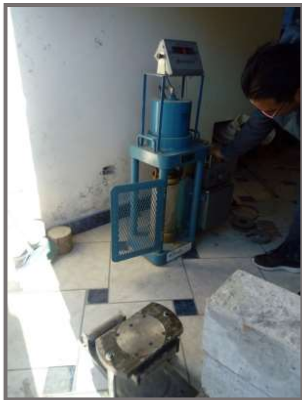
FOTO 2. Rotura de concreto a la compresión
