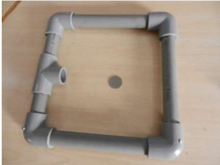
Figura 10 Vista del ensamblado con codos -Flotador.
