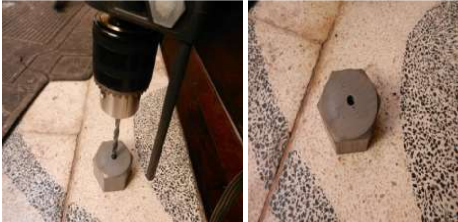
Figura 17 Vista de la perforación del tapón
