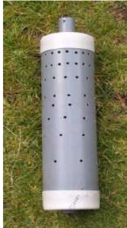
Figura 2 Modelo convencional de Hipoclorador.
