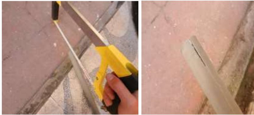
Figura 24 Vista del corte en el extremo del tubo.
