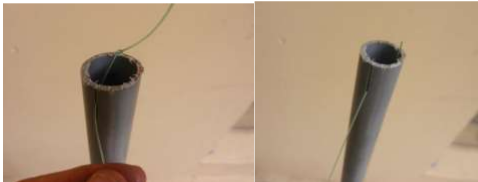
Figura 25 Vista del fijado del hilo de nylon en la ranura.
