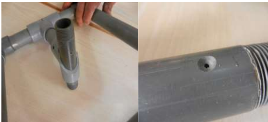
Figura 16 Vista de la perforación del Orificio.
