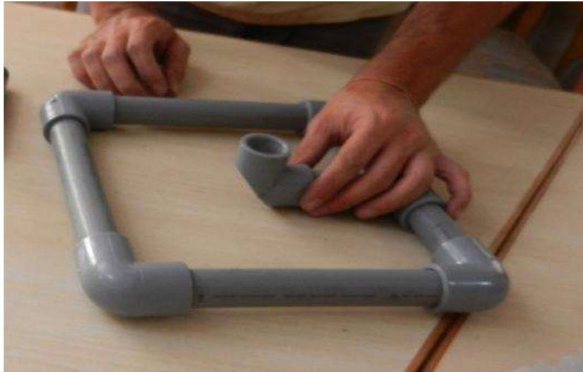
Figura 14 Se aprecia que se retira el niple de PVC de \Phi 3/4" y ensamblar.
