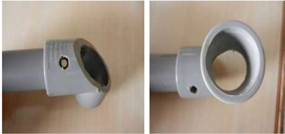
Figura 15 Vista de la perforación del codo.
