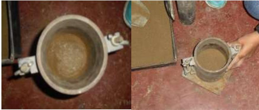
Fotografía 14. Suelo estabilizado sometido a Prueba de Valor Soporte California
