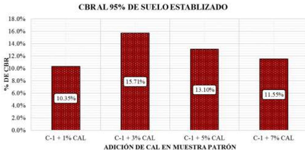
Figura 15. Resultados de Prueba C.B.R. – Suelo Estabilizado
