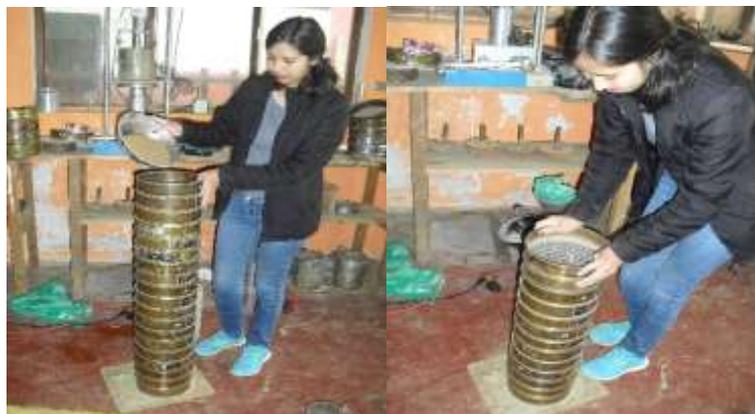
Fotografía 6. Análisis granulométrico por tamizado.
