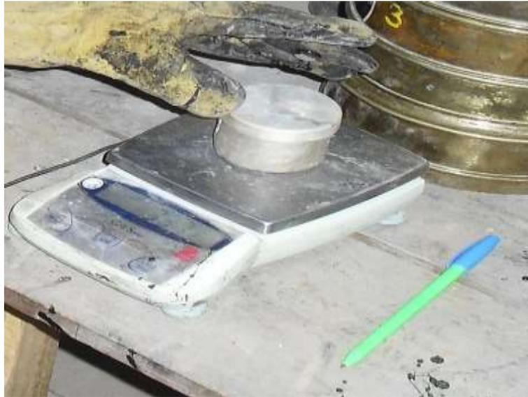
Fotografía 5. Determinación del peso de material secado en horno
