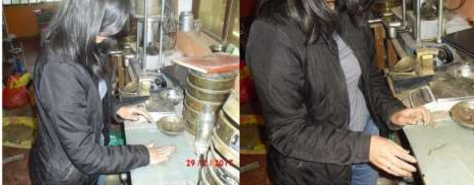
Fotografía 9. Amasado y rodamiento de material para efectuar el Límite Plástico.
