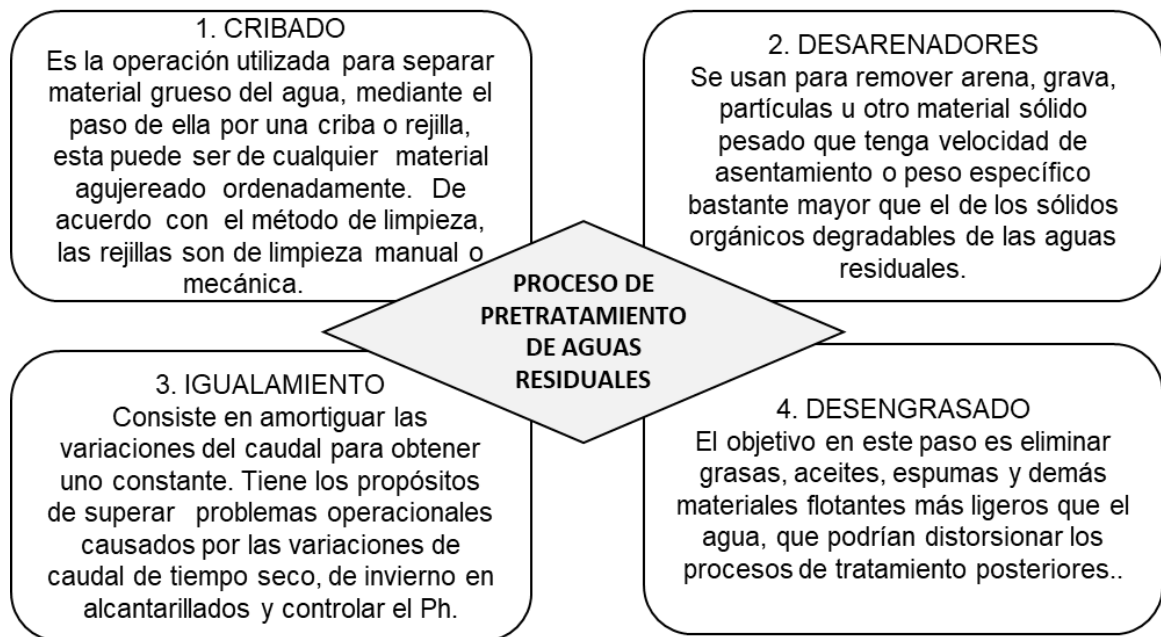
Figura 3. Proceso de pre tratamiento de aguas residuales
