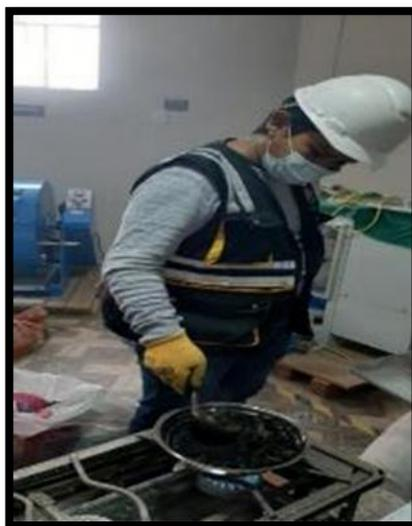
**Fotografía 2, fotografía 3, fotografía 4 y fotografía 5.** Vista de agregados (arena, grava triturada), adicionando el cemento asfáltico previamente disolver para la elaboración de los especímenes de asfalto (briquetas) y colocarlas en el molde compactación.
