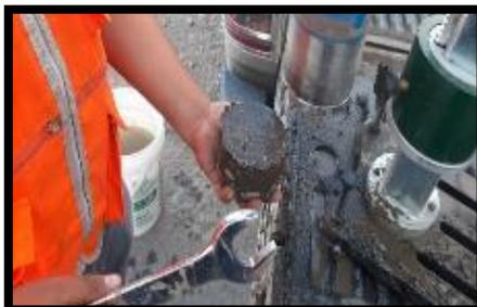
**Fotografía 79, fotografía 80, fotografía 81 y fotografía 82.** Método de ensayo para la obtención de testigos diamantinos concreto. (NTP. 339.034)
