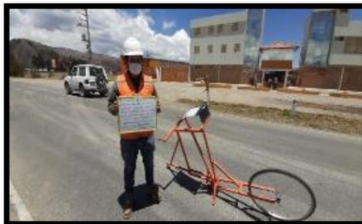
**Fotografía 73, fotografía 74 y fotografía 75.** El método consiste en medir la deformación producida en la superficie del pavimento por la aplicación de una carga normalizada (ASTM D 4695).
