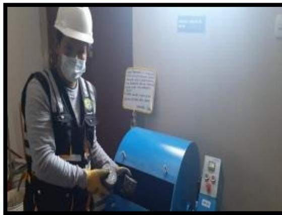
**Fotografía 21, fotografía 22 y fotografía 23.** A continuación, una briqueta se lleva en la máquina de Los Ángeles sin considerar carga abrasiva de las bolas, se hace rotar el tambor a la misma velocidad normalizada en las normas (NTP 400.019)
