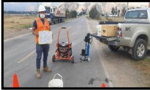
**Fotografía 76.** Equipo de diamantina para extraer los testigos para el ensayo de compresión (NTP. 339.034)
