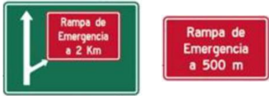
Figura 27 y Figura 28. Preseñalización de la rampa de frenado.
