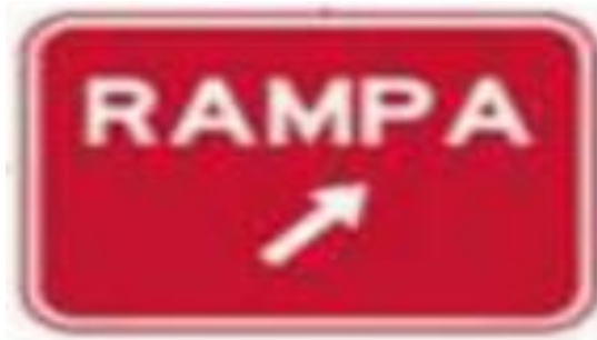
Figura 13. Señal de ingreso a la rampa de frenado. Fuente: MTC (2016).
