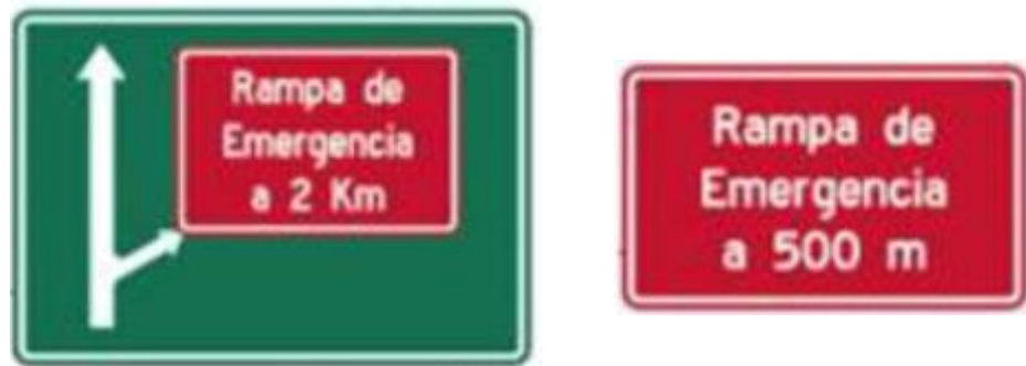
Figura 11 y Figura 12. Preseñalización de la rampa de frenado. Fuente: MTC (2016).
